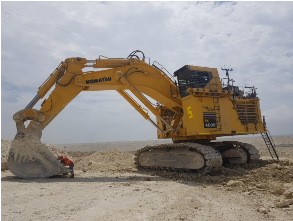
Figura 5. Excavadora PC-4000 Back Hoe.
