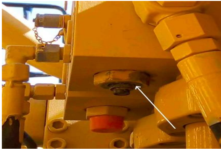
Figura 14. Contratuerca de válvula de alivio del sistema hidráulico de una excavadora PC-4000.
