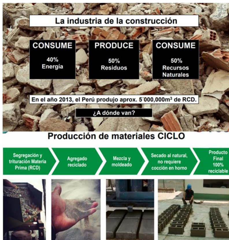
Figura 87: Sistema de producción del ladrillo ecológico CICLO.
