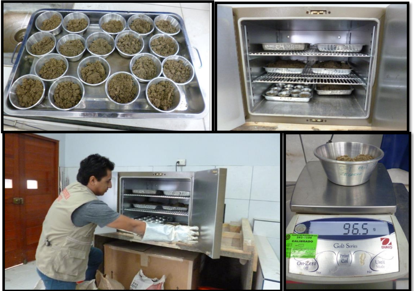
IMAGEN N° 10: Desarrollo de ensayo de contenido de humedad. Fuente: Elaboración propia.
