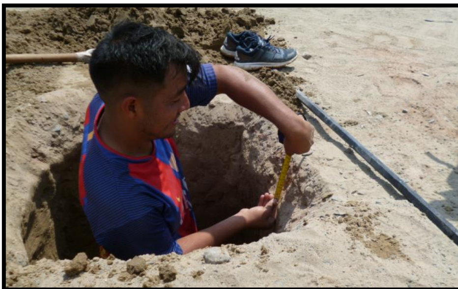
IMAGEN N° 5: Medición de estratos que se encontraron en las calicatas. Fuente: Elaboración propia.
