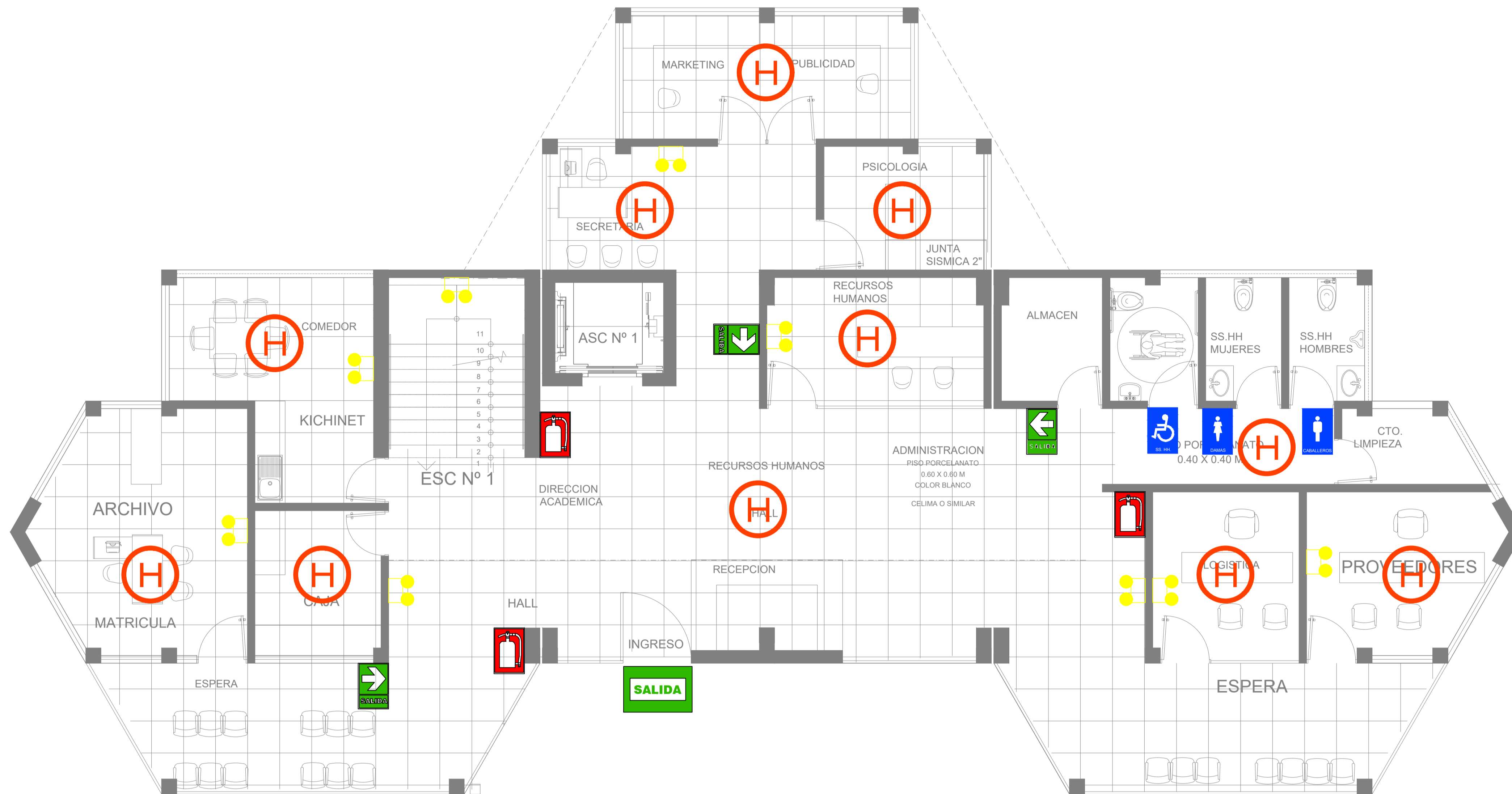
SEÑALÉTICA ZONA ADMINISTRATIVA PISO 1
