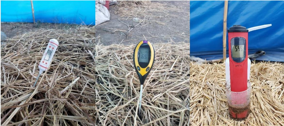
**Figura 16. Medición de los parámetros básicos in situ de las 4 pilas (Temperatura, pH)**
