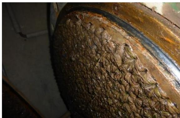
Figura N°6: Residuos sólidos en intercambiador lado B
