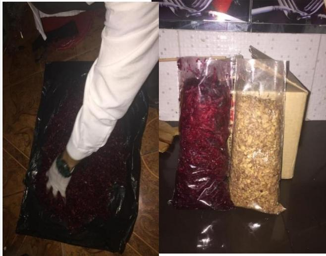
Para la muestra 2, se pesó 1.2 Kg de lodos residuales con las mismas características empleadas para el M1, para este inoculo se preparó 500 gramos de vegetales picados finamente para cada biodigestor, el cual se empleó como cofermentador y por su alto contenido de materia orgánica.
