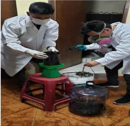
Para la muestra 1 se realizó la preparación del inoculo; se procedió a pesar la muestra de lodo en cantidad de 1.7 kg para el primer tratamiento. Los experimentos se realizaron por triplicado.
