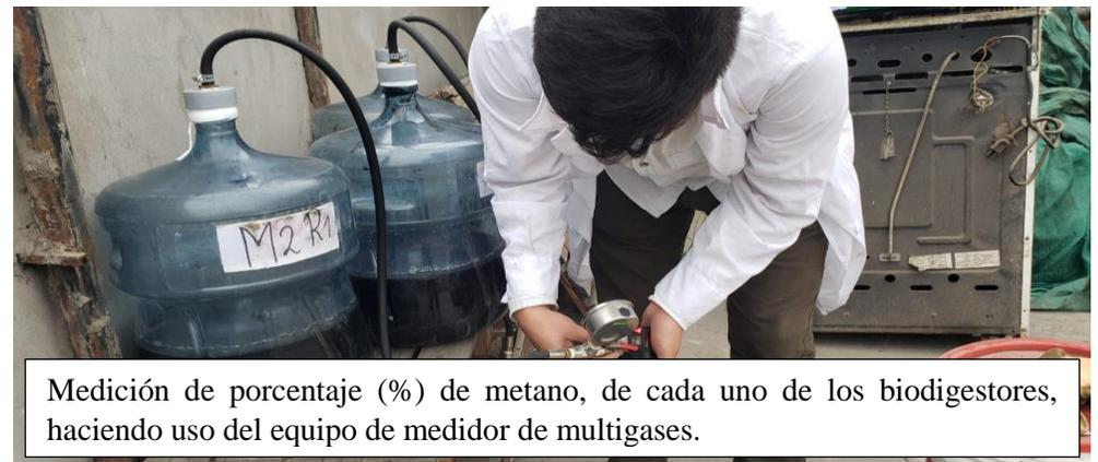
Medición de porcentaje (%) de metano, de cada uno de los biodigestores, haciendo uso del equipo de medidor de multigases.
