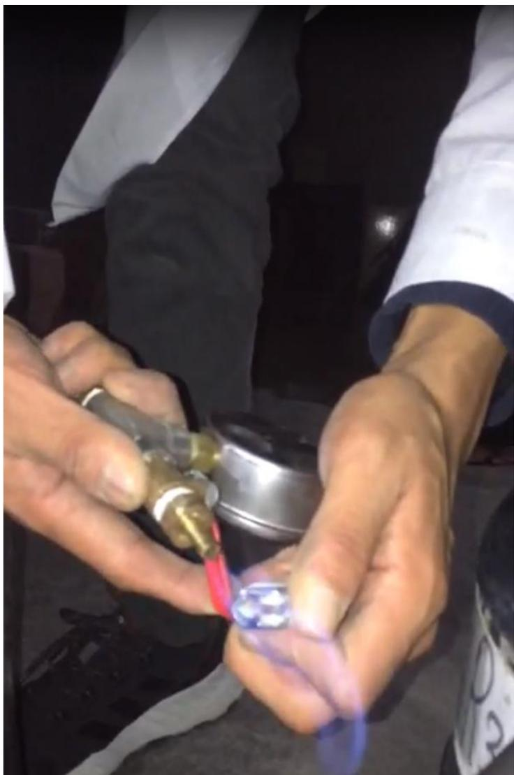
Prueba de fuego del biodigestor con materia orgánica.
