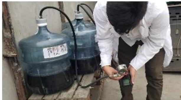
Se realizó la medición de  $\text{CH}_4$ ,  $\text{CO}_2$ , y  $\text{O}_2$  cada 10 días por un período de 60 días.
