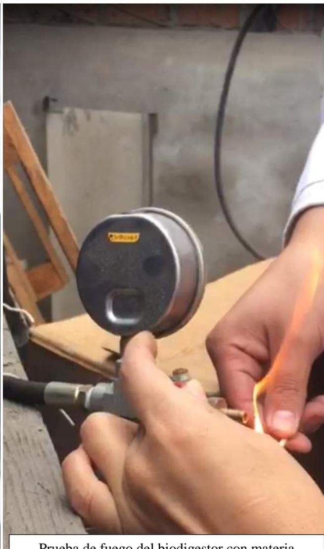
Prueba de fuego del biodigestor con materia orgánica.
