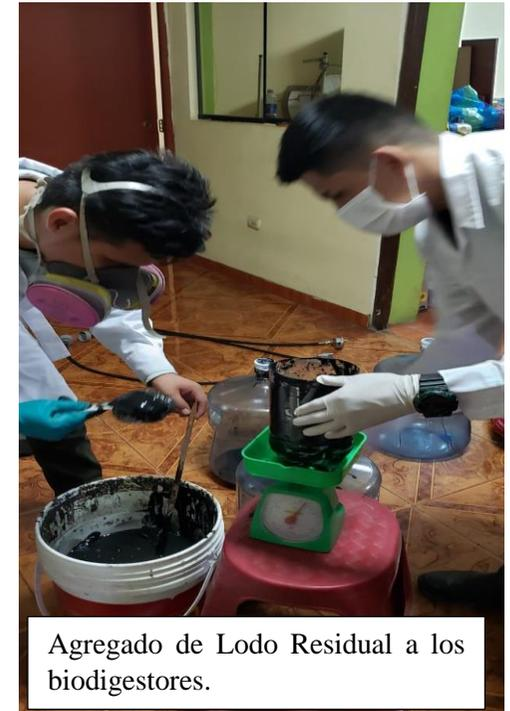
Agregado de Lodo Residual a los biodigestores.
