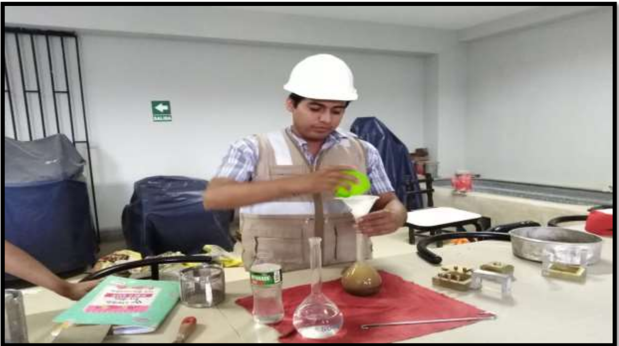
FIGURA N°73: Se observa la realización del ensayo del peso específico de los agregados para el diseño de mezcla en este caso para los adoquines de concreto con vidrio molido.
