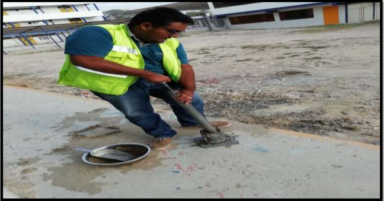
FIGURA N°64: Se observa realizando el ensayo del Proctor CBR para determinar la humedad óptima que tiene el suelo en la cuales se hizo para las 4 muestras que se llevaron a laboratorio.
