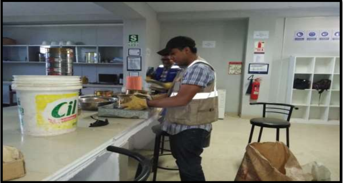
FIGURA N°74: Se observa la realización del Análisis Granulométrico del agregado fino en la cual se elaboró de los adoquines de concreto con vidrio molido.
