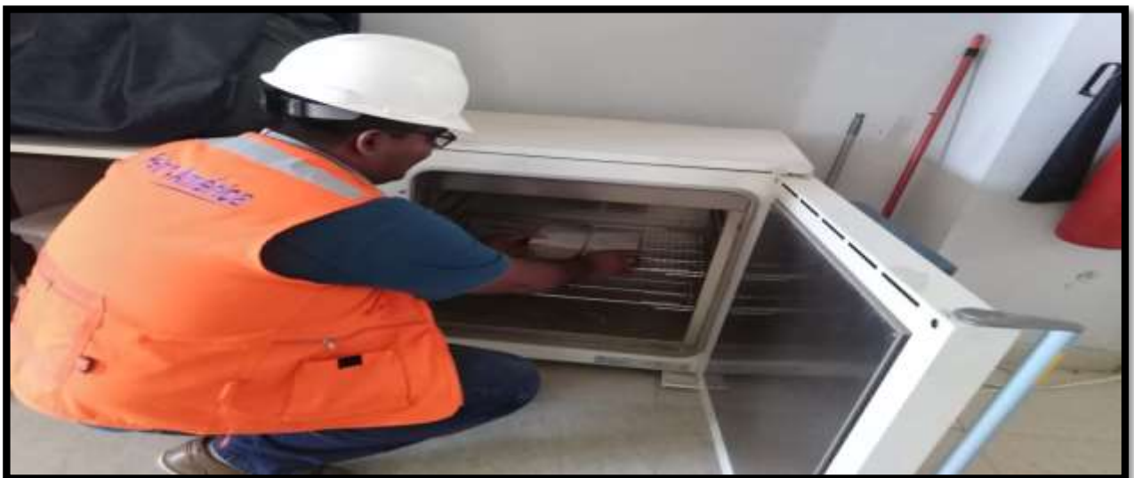
FIGURA N°87: En esta fotografía se hace el ensayo de absorción del adoquín en cual se pone al horno eléctrico por 24 horas para determinar la capacidad de absorción de agua.
