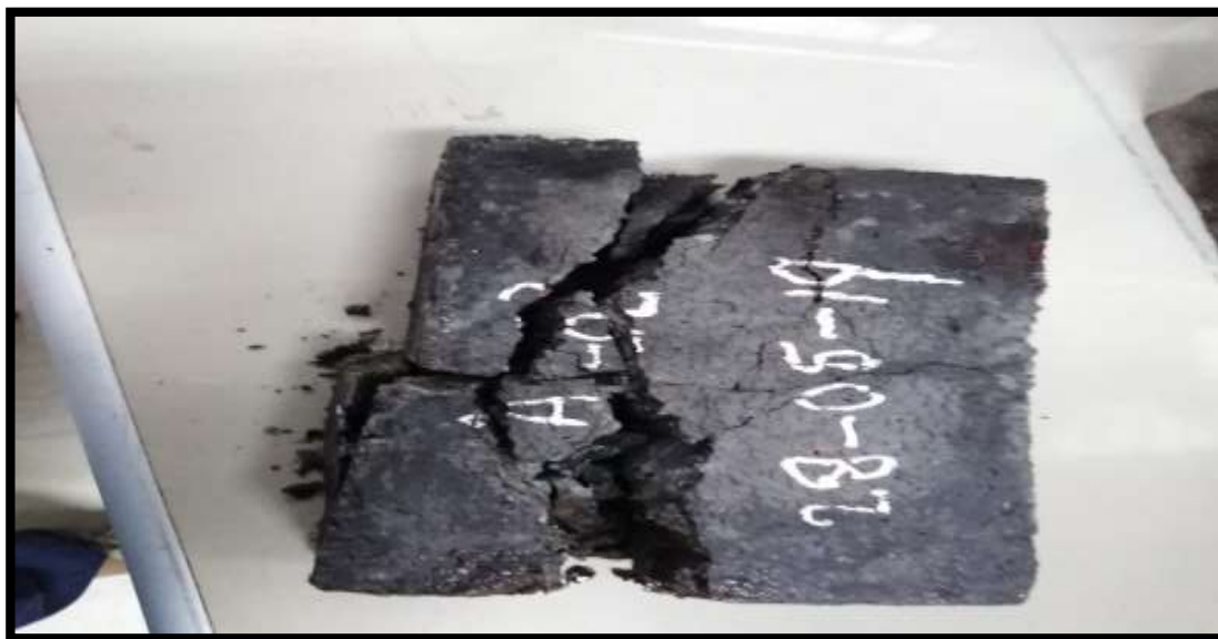
FIGURA N°97: En esta fotografía se hace el ensayo de comprensión de los adoquines de concreto con vidrio molido obteniendo mayor resistencia el adoqueín que se le añadió 45 % de vidrio molido.
