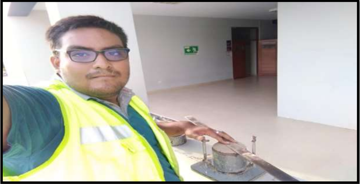
FIGURA N°62: Se observa la elaboración del ensayo del Proctor de una de las 04 muestras extraídas de la zona para calcular las propiedades físicas y mecánicas del suelo.
