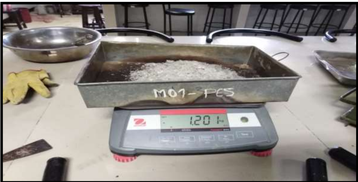
FIGURA N°79: Se observa el peso del vidrio que se utilizó para realizar nuestra investigación de acuerdo a las tres dosificaciones que se planteó para un f'c = 340 \text{ kg/cm}^2 .
