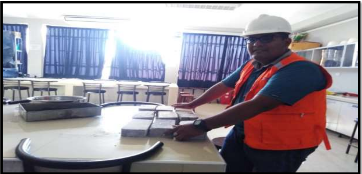
FIGURA N°83: Se observa los 9 adoquines de la muestra que se hicieron ,3 a los 7 días ,3 a los 14 y 3 a los 28 días en la cual se obtuvo su resistencia de cada adoquín y se hizo el ensayo de absorción.
