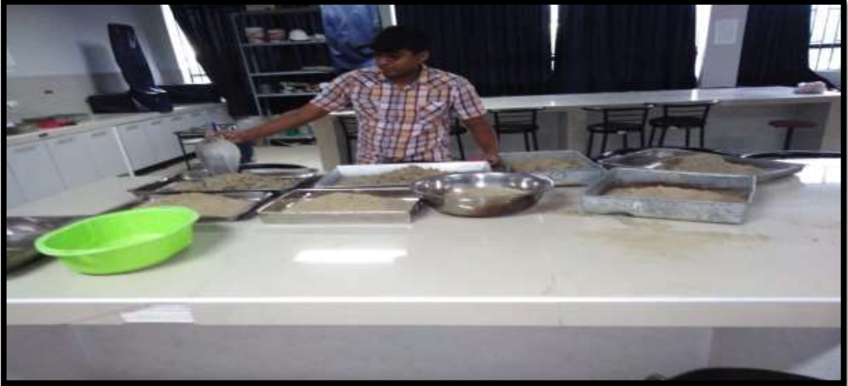
FIGURA N°56: En esta fotografía se aprecia el material a utilizar para el ensayo del CBR en la cual se pesó cada 3000 gramos de todas las muestras para llevar a cabo este ensayo.
