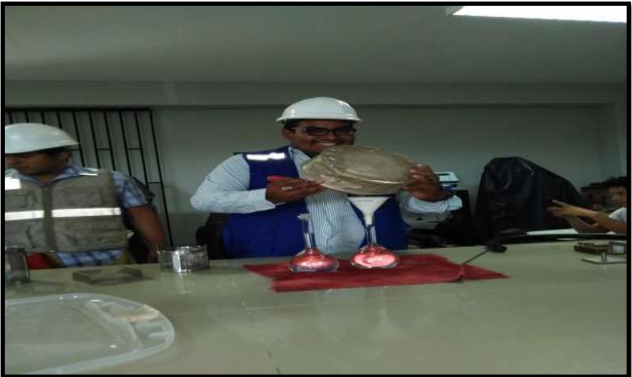
FIGURA N°57: Se observa el llenado de las fiolas del agregado fino para el ensayo de grado específico de los adoquines de concreto con vidrio molido.
