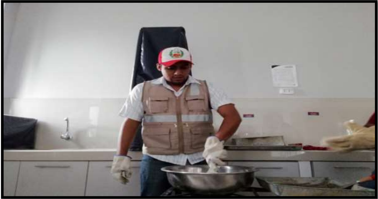
FIGURA N°70: Se observa la realización del ensayo de Contenido de Humedad del agregado fino que se usó en la dosificación de mezcla para los adoquines de concreto con vidrio molido.
