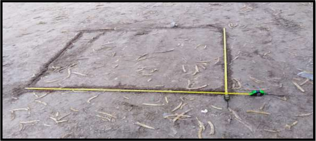
FIGURA N°48: Se observa la medida correspondiente de 1.50 mts. x 1.50 mts. para las calicatas que se realizaron en situ en las zonas de estudio para calcular las propiedades físicas y mecánicas del suelo.
