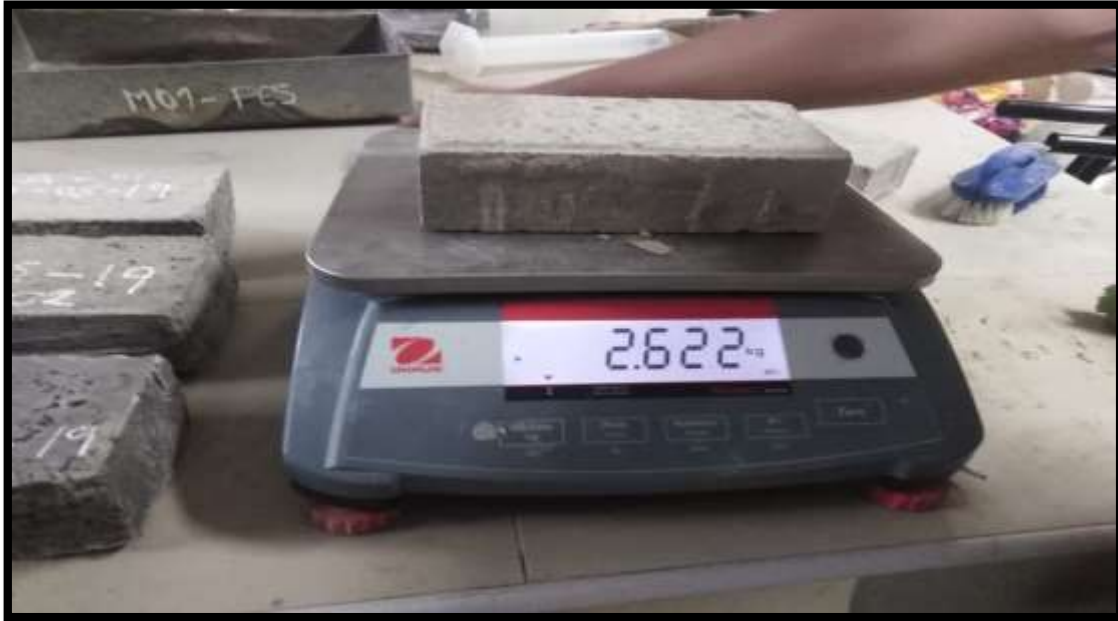
FIGURA N°88: En esta fotografía se aprecia el resultado del peso del adoquín convencional para realizar el ensayo de compresión y en la cual se obtuvo su resistencia.
