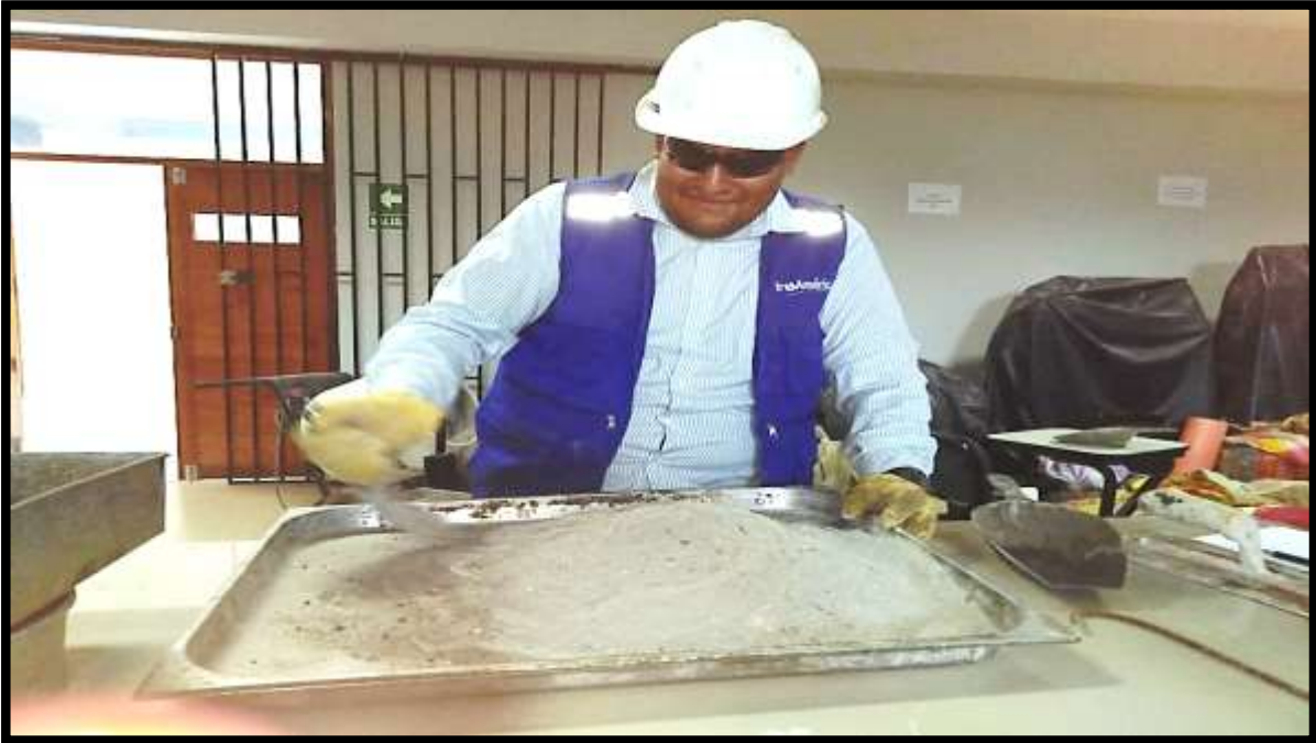
FIGURA N°78: Se observa la elaboración de mezcla de acuerdo a los porcentajes de agregados para el diseño de los adoquines de concreto con vidrio molido
