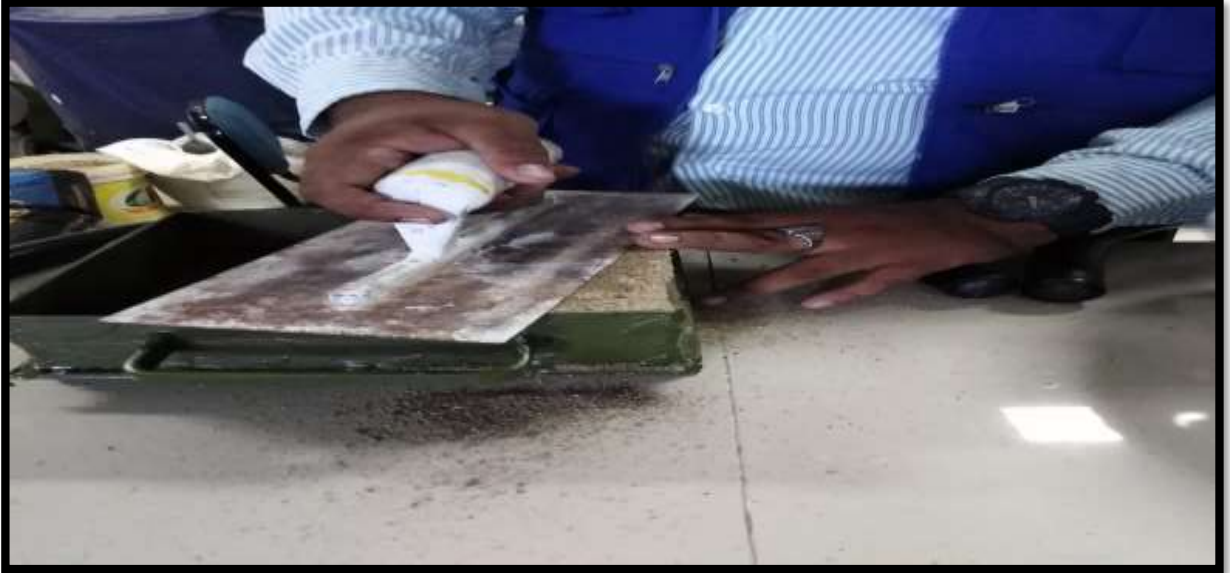
FIGURA N°82: Se observa la elaboración de los adoquines de concreto con vidrio molido con los moldes y medidas correspondientes, así como también los porcentajes de acuerdo a nuestra dosificación.
