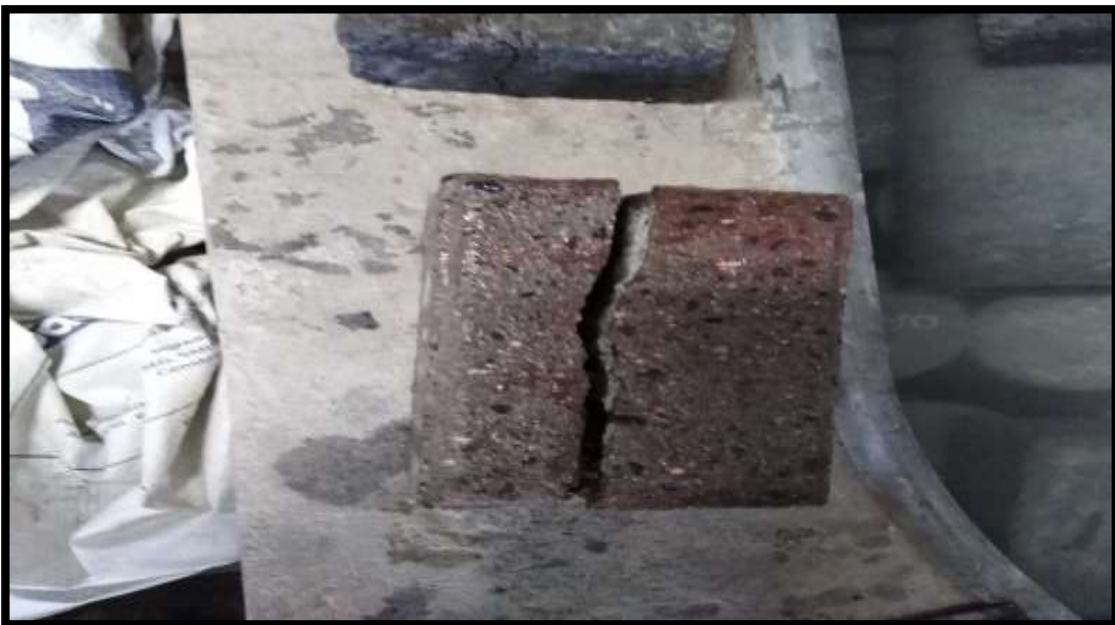
FIGURA N°95: En esta fotografía se aprecia la rotura del adoquín tradicional en cual se obtuvo una resistencia de 340 \text{ kg/cm}^2 .
