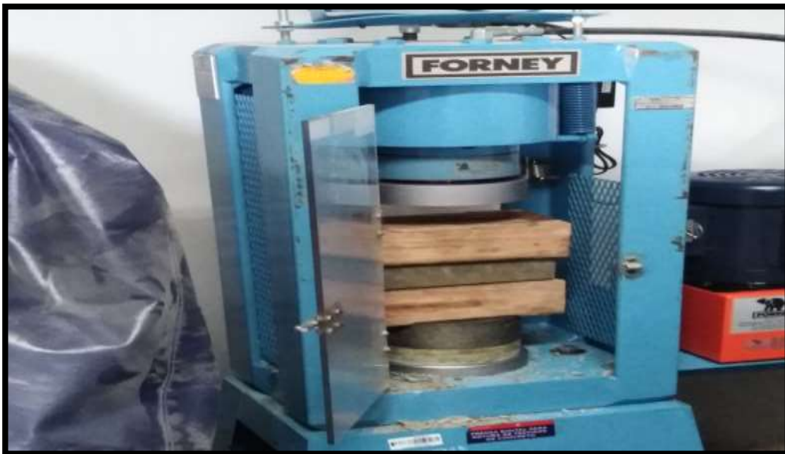
FIGURA N°93: En esta fotografía se hace el ensayo de compresión en la cual se obtuvo la resistencia de los adoquines de concreto con vidrio molido a los 7,14 y 28 días.
