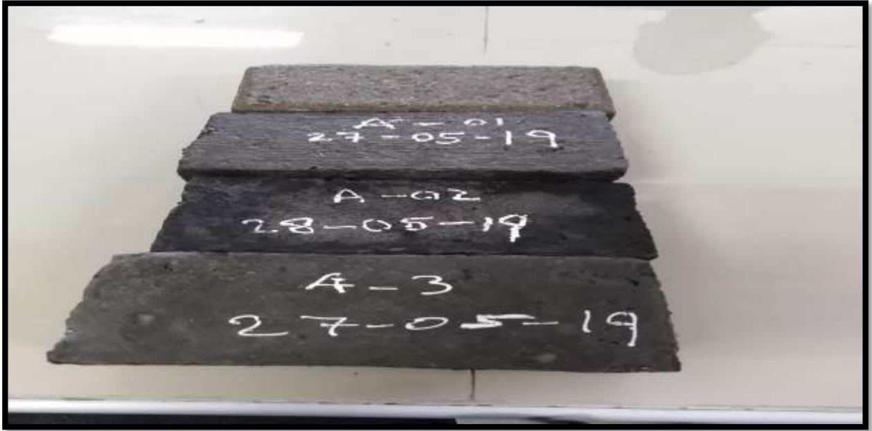
FIGURA N°86: Se observa los adoquines de concreto con vidrio molido en las cuales nos hemos basado en los parámetros de ensayo de cada adoquín en la empresa DINO S. R. L. donde se obtuvo buenos resultados en la resistencia.
