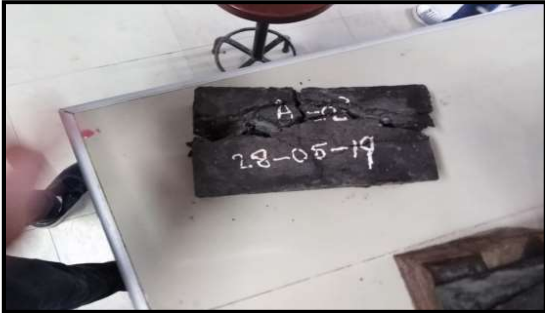
FIGURA N°96: En esta fotografía se aprecia la rotura de los adoquines en las cuales se obtuvo la resistencia a los 7,14 y 28 días obteniendo resultados óptimos logrando así nuestro objetivo principal.
