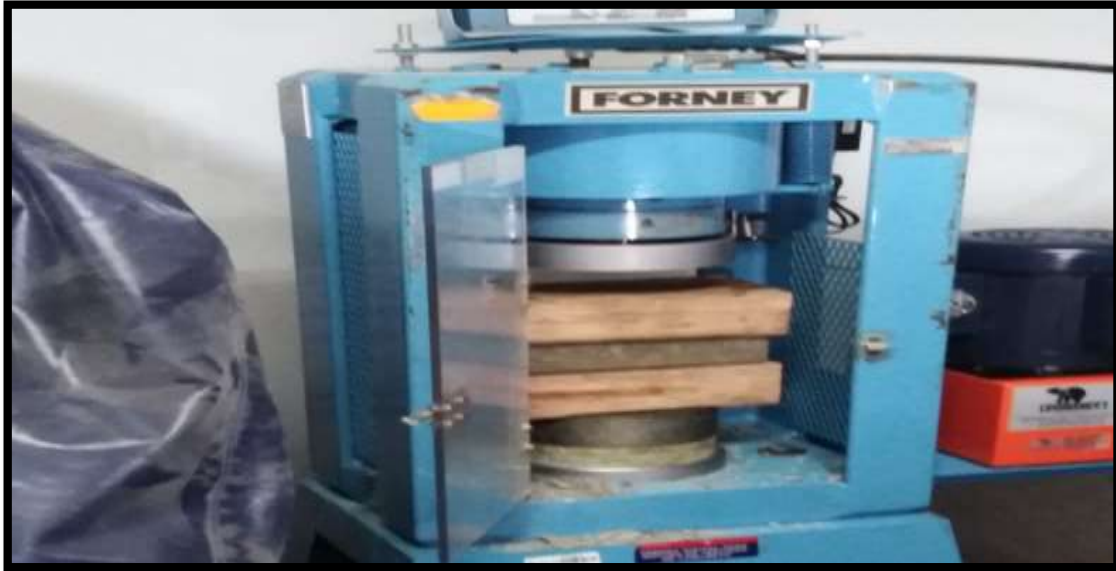
FIGURA N°92: En esta fotografía se hace el ensayo de compresión en la cual se obtuvo la resistencia de los adoquines de concreto con vidrio molido a los 7,14 y 28 días.
