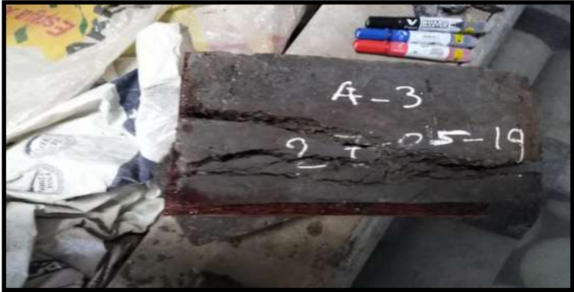
FIGURA N°94: En esta fotografía se aprecia la rotura de los adoquines de concreto con vidrio molido a los 7 días en la cual se obtuvo una resistencia.
