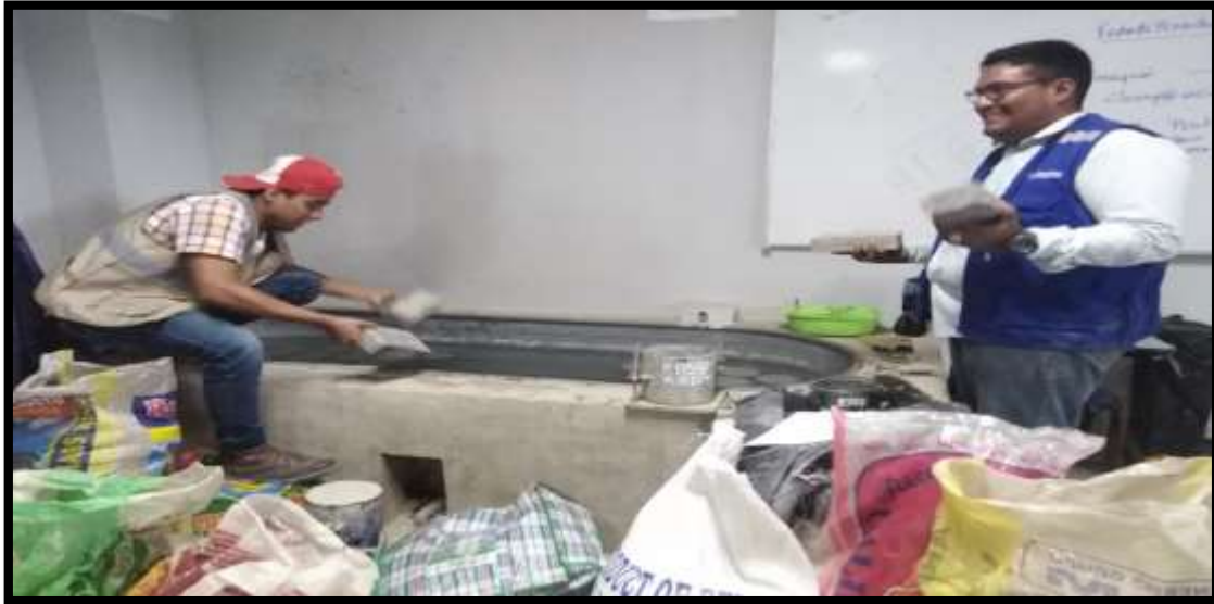
FIGURA N°90: En esta fotografía se aprecia los adoquines de concreto con vidrio molido puestos en agua para determinar de acuerdo a los días propuestos el ensayo de absorción así como también el ensayo de compresión.
