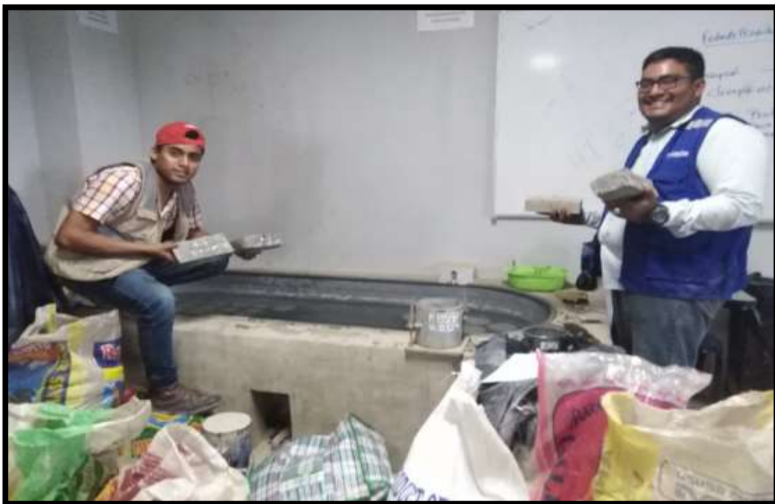
FIGURA N°91: En esta fotografía se aprecia los adoquines de concreto con vidrio molido puestos en agua para determinar de acuerdo a los días propuestos el ensayo de absorción así como también el ensayo de compresión.
