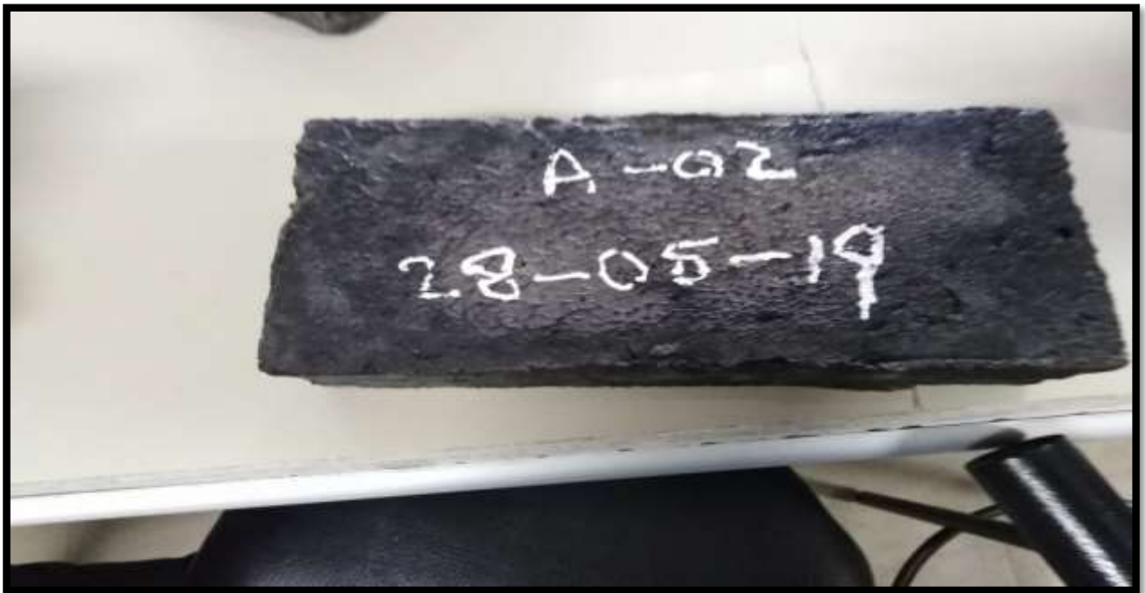
FIGURA N°85: Se observa el adquin de concreto con vidrio molido indicando la fecha de su elaboración y en la cual se procedió hacerle su ensayo de absorción donde obtuvo su resistencia.
