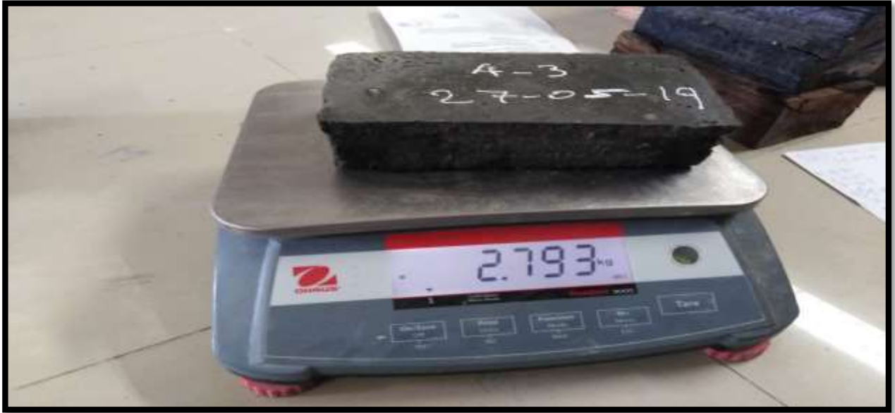
FIGURA N°84: Se observa el peso del adquin de concreto vidrio molido y su respectivo peso húmedo en la cual se hizo el ensayo de absorción para calcular la resistencia de humedad.
