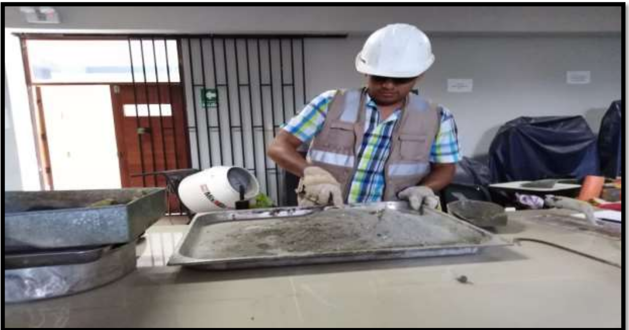
FIGURA N°77: Se observa la dosificación de la mezcla de acuerdo a los porcentajes de agregados para la elaboración de los adoquines de concreto con vidrio molido.
