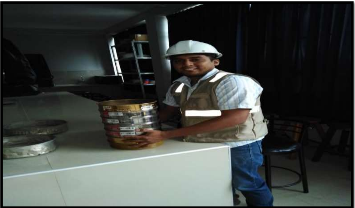
FIGURA N°55: Se hace el análisis granulométrico de las muestras llevadas al laboratorio para verificar los porcentajes de finos y gruesos que tiene el suelo del área de estudio.
