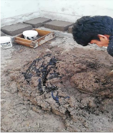
Figura 22: Mezcla del barro con la emulsión asfáltica
