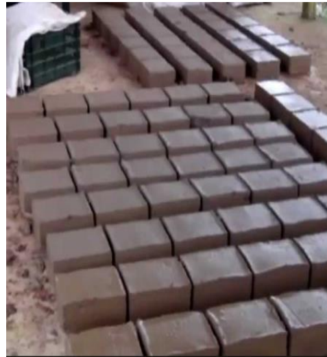
Figura 32: Unidades de adobe estabilizado
