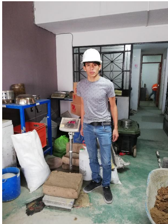
Figura 42: Se pesa el espécimen de adobe en seco
