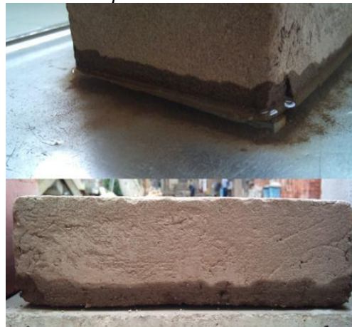
Figura 43: Retiro de la unidad después de la prueba de succión
