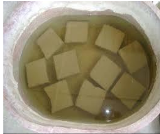
Figura 48: Sumergir el espécimen de adobe
