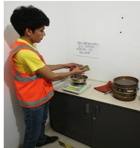
Figura 13: Pesado del material retenido en cada malla
