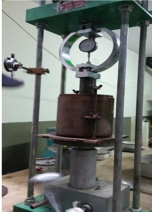
*Figura 7.* Prensa de anillo de carga para CBR
