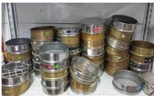
*Figura 6.* Tamices empleados en el ensayo MTC E 107-2016
