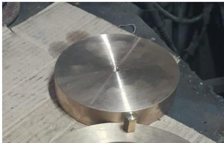
Figura 4. Placa de soporte de carga
