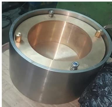
Figura 8. Molde de celda edométrica de 15cm
