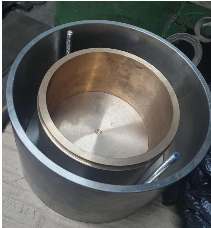
*Figura 8. Anillo edométrico dentro del contenedor*
