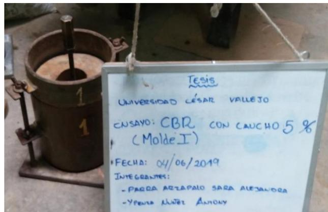
Figura 9. Montaje de moldes 1, 2 y 3 para CBR de 5% de caucho
