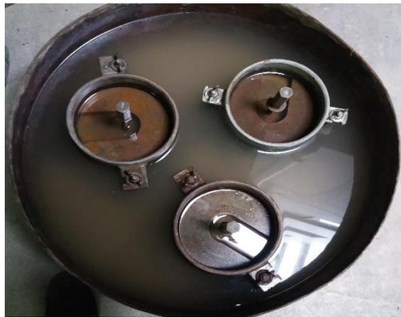
*Figura 10.* Moldes 1er día de saturación para CBR de 10% de caucho
