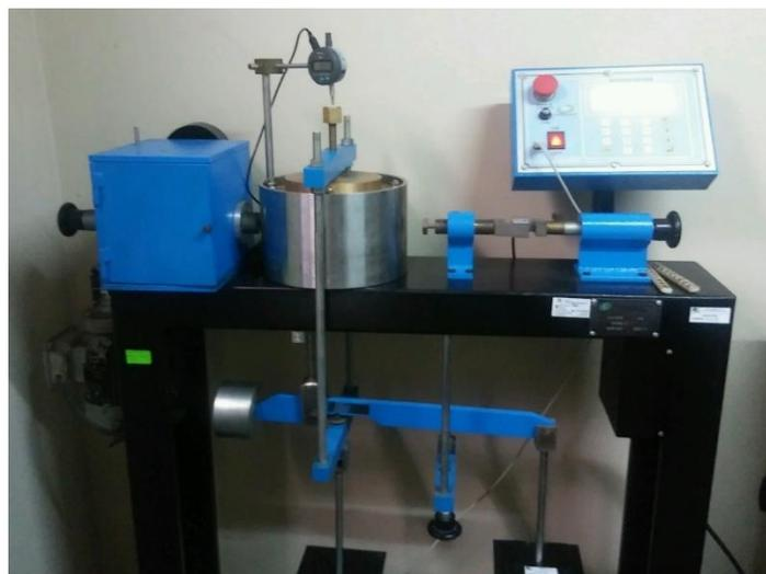
*Figura 11.* Montaje de la celda edométrica en el ensayo de consolidación
