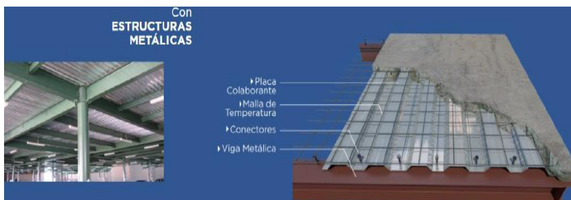
Figura N° 35: Losa Colaborante.
