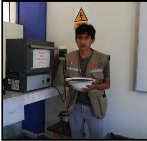
Figura 3: Calcinación de la cascarilla de arroz, a una temperatura de 420°C
