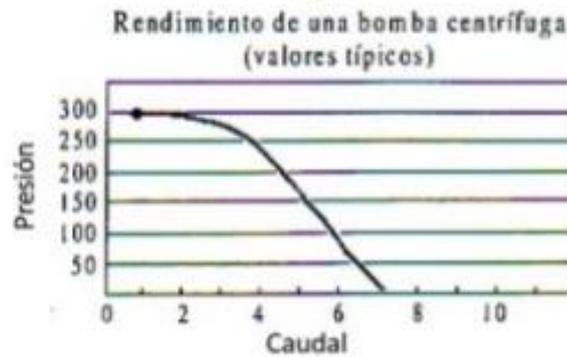
*Ilustración 4. Rendimiento de una bomba Centrífuga*
