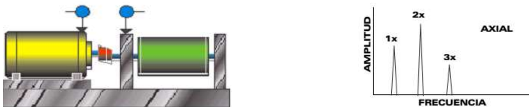
Figura nro. 16. Vibración por desalineación entre ejes y su gráfico
