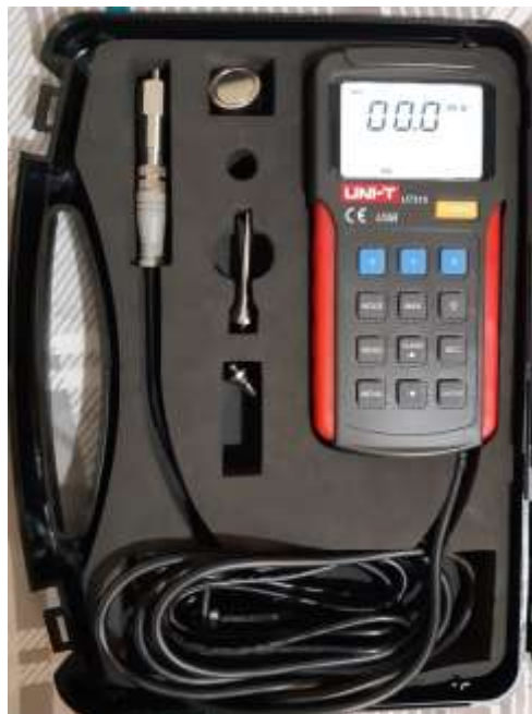
Figura nro. 40. analizador de vibraciones mecánicas, con interfaz para PC
