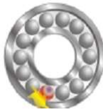
Figura nro. 27. Falla en elementos rodante del rodamiento
