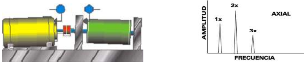
Figura nro. 15. Modo balanceo estático y amplitud de vibración por desbalanceo
