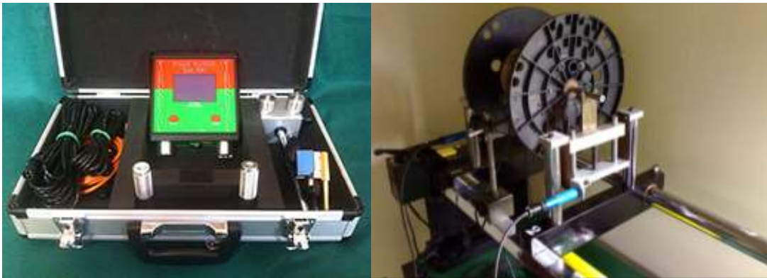
Figura nro. 42.lado izquierdo balanceador dinámico portátil y de bancada microprocesador BMX 900
