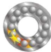
Figura nro. 28. Falla por deterioro de jaula del rodamiento
