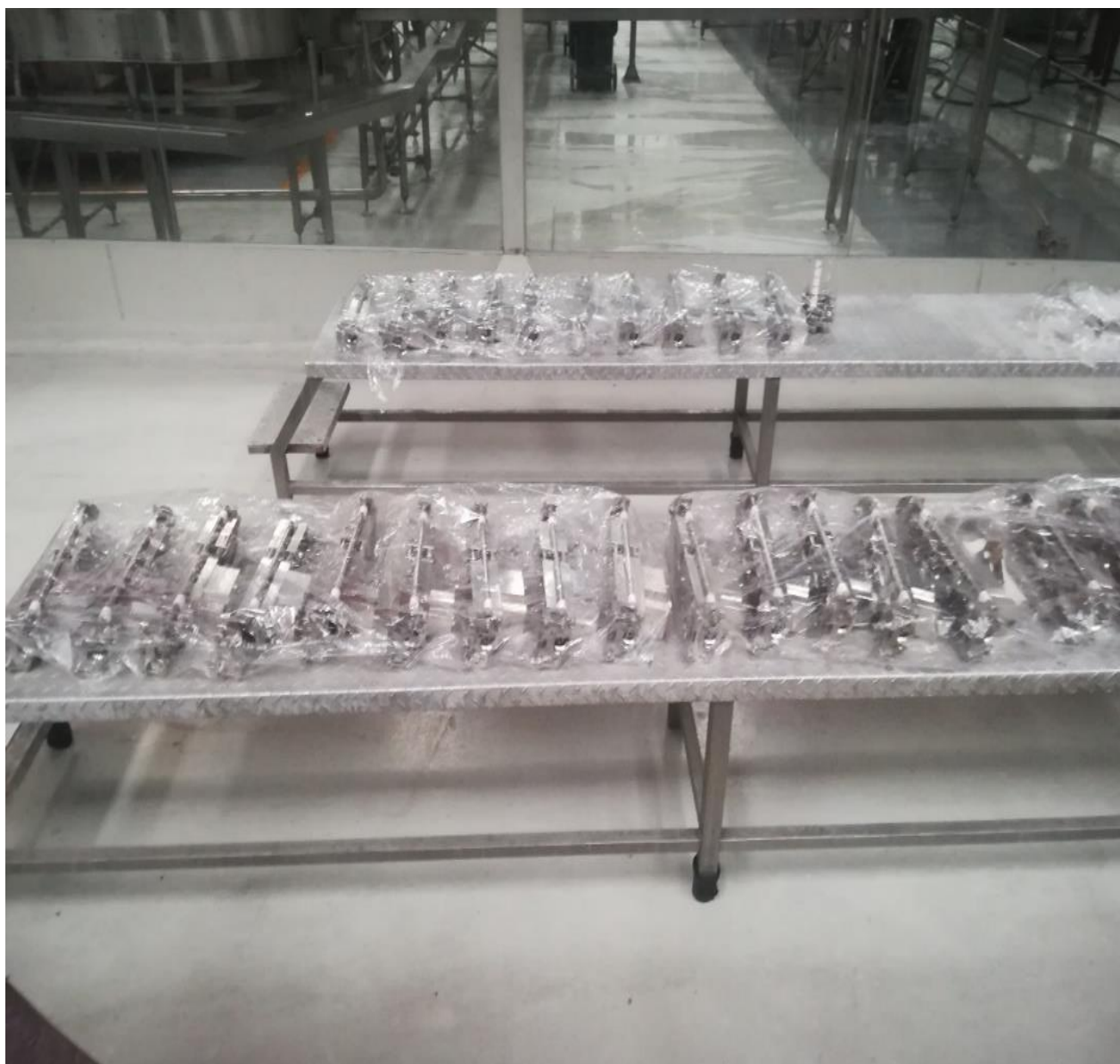
FIGURA 28. VÁLVULAS DE LLENADO DESMONTADAS PARA SU REPARACIÓN.
