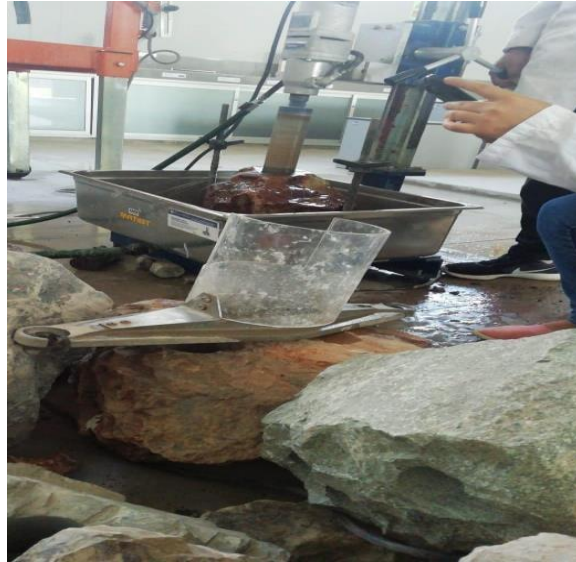
Fotografía 1: Perforación diamantina para la extracción de testigos
