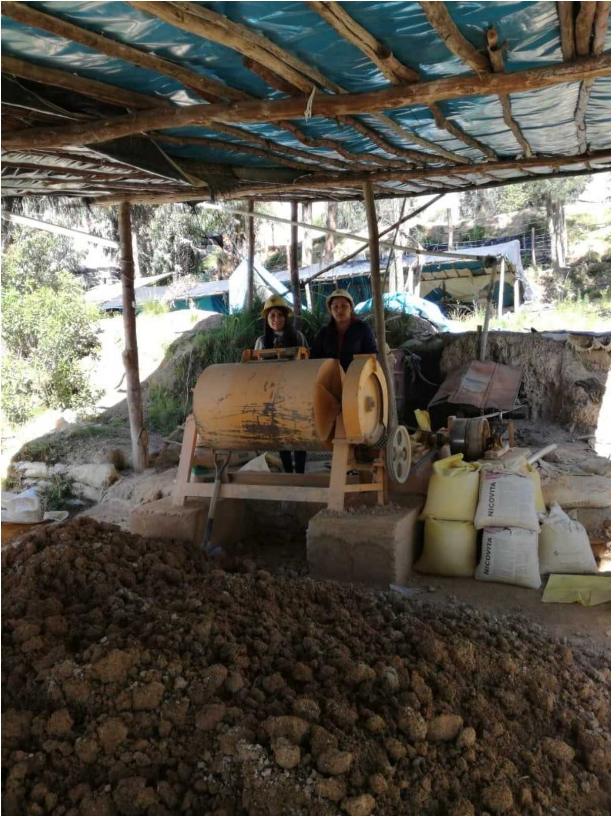
Figura 8.4. Máquina Molino para el proceso del mineral
