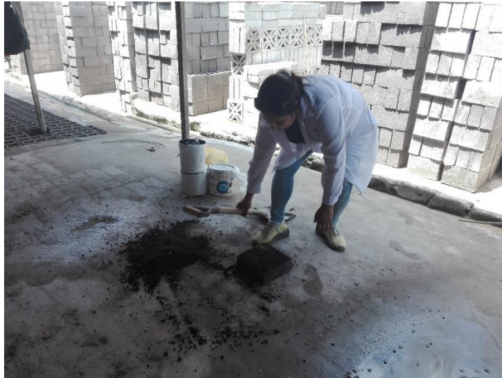
Figura 9 : Llenado de la mezcla en el molde adoquín ( 20 cm x 10 cm x 4 cm)
