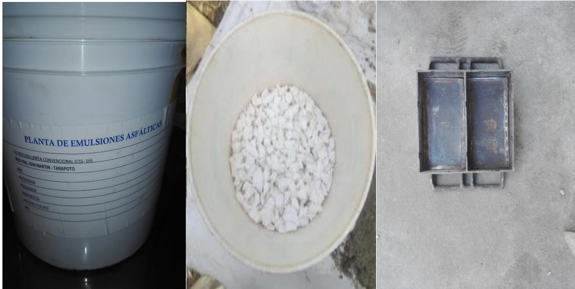
Figura 7: Muestra de emulsión asfáltica CSS -1h, poliestireno expandido (tecnopor) y molde del Adoquín (20 cm x 10 cm x 4 cm)
