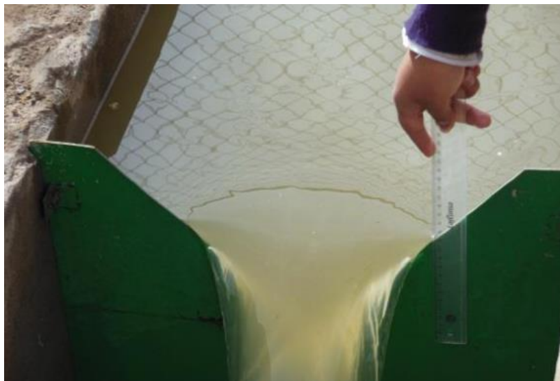
Figura 3 Aplicación del vertedero triangular en el conducto de entrada de la PTAR
