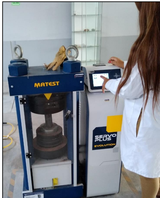
Figura 8. Ensayo de laboratorio para hallar la resistencia del macizo rocoso
