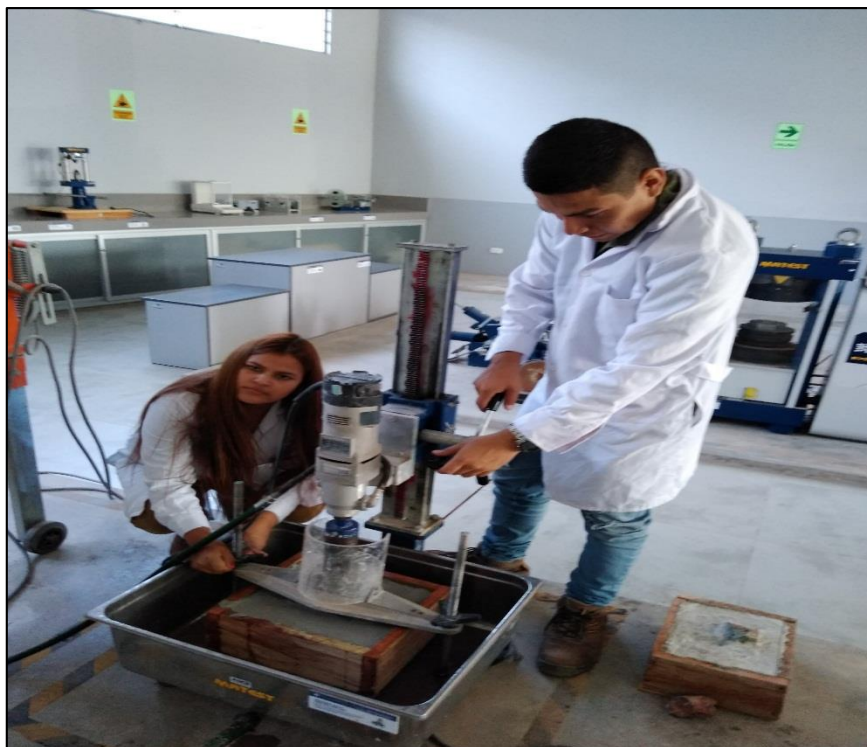
Figura 6. Ensayo de laboratorio de corte de testigo
