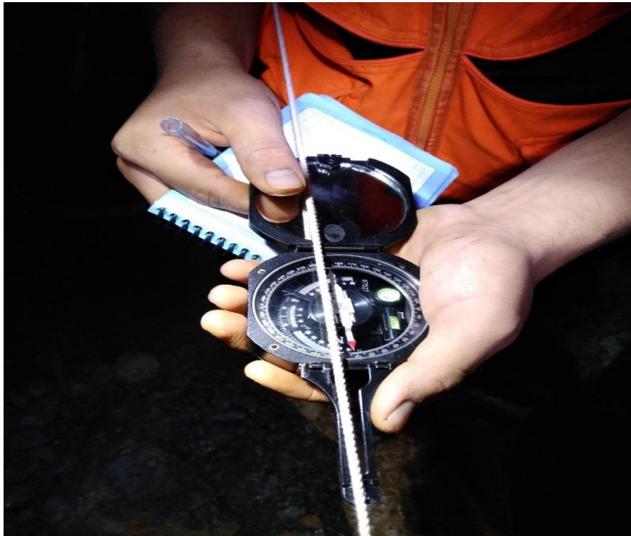
Figura 4. levantamiento topográfico subterráneo con brújula
