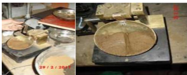
Figura 12: Copa de Casagrande Fuente: Elaboración propia.
