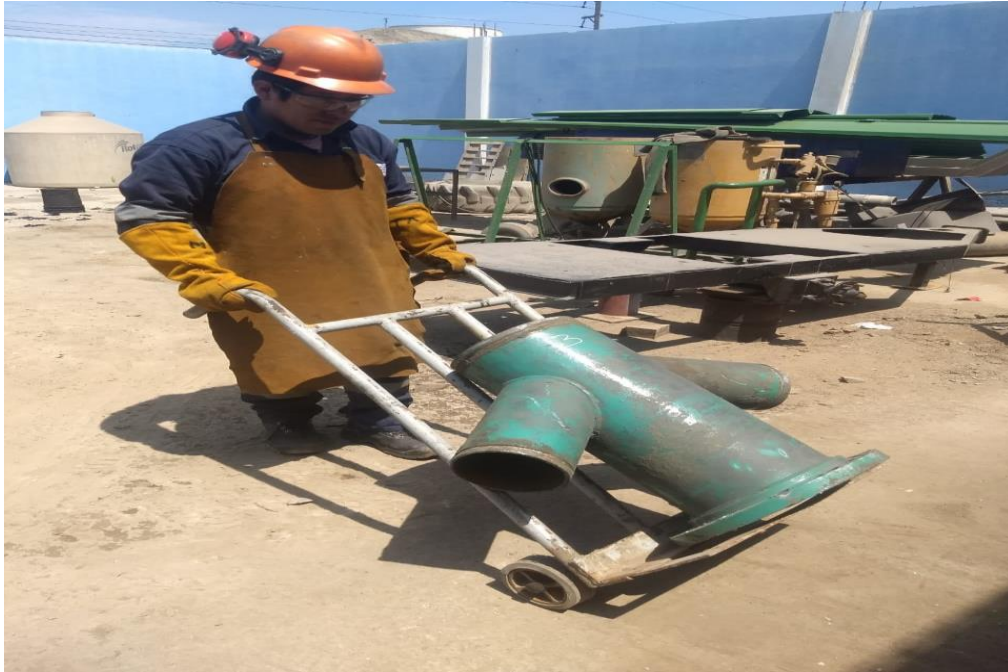
Figura 23: Actividad: Armar la estructura o esqueleto del producto Riesgo: Psicosocial / Ergonómico Utilizar un carro auxiliar de carga
