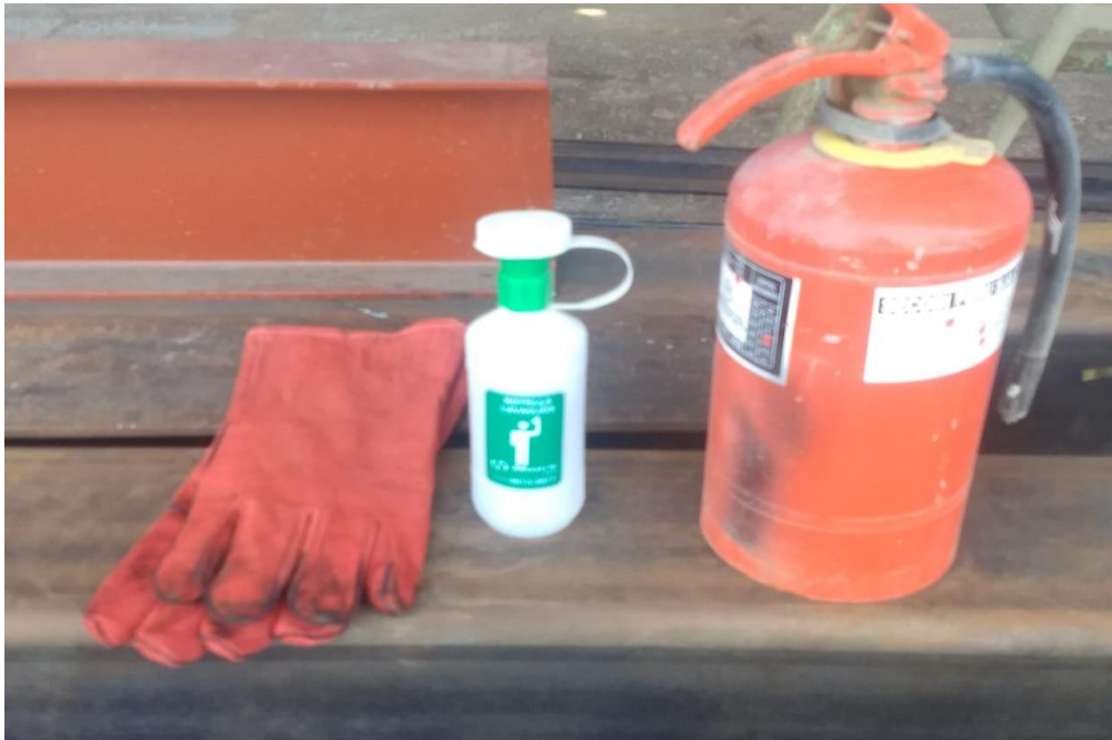
Figura 27: Actividad: Soldar estructuras y piezas Riesgo: Físico Químico / Manipulación inadecuada de máquinas de soldar en funcionamiento sin medidas de seguridad. Propuesto: Procedimiento para trabajos en caliente e implementación de EPP y Extintor
