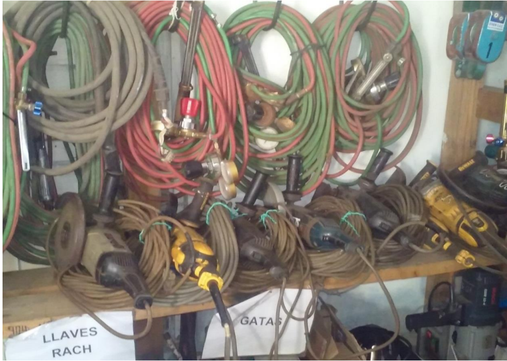
Figura 33: Actividad: Locativo Riesgo: Físico / Taller obstruido con material apilado. Propuesto: Colocar estantes anclados para el ordenamiento de herramientas y equipos.
