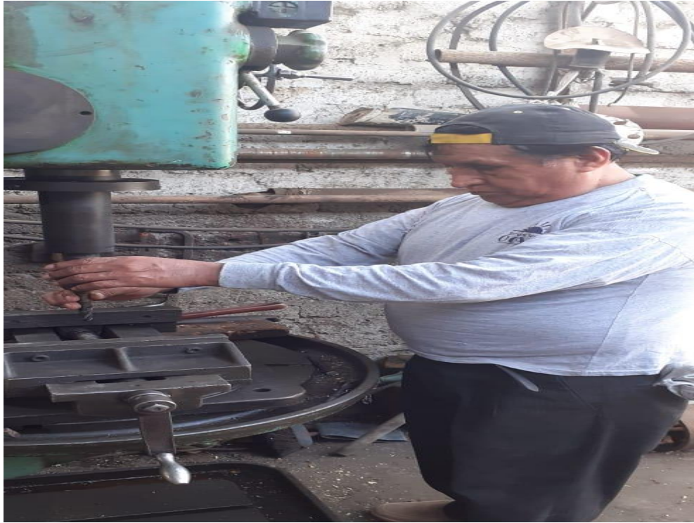
Figura 39: Manipulación incorrecta del equipo de trabajo
