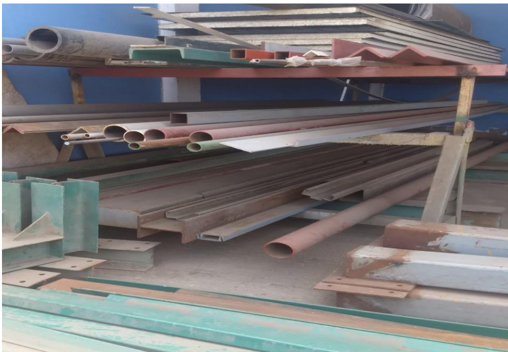
Figura 24: Actividad: Almacenaje de material de trabajo Riesgo: Taller obstruido con material apilado. Propuesto: Colocar estantes anclados para el ordenamiento de herramientas y equipos.
