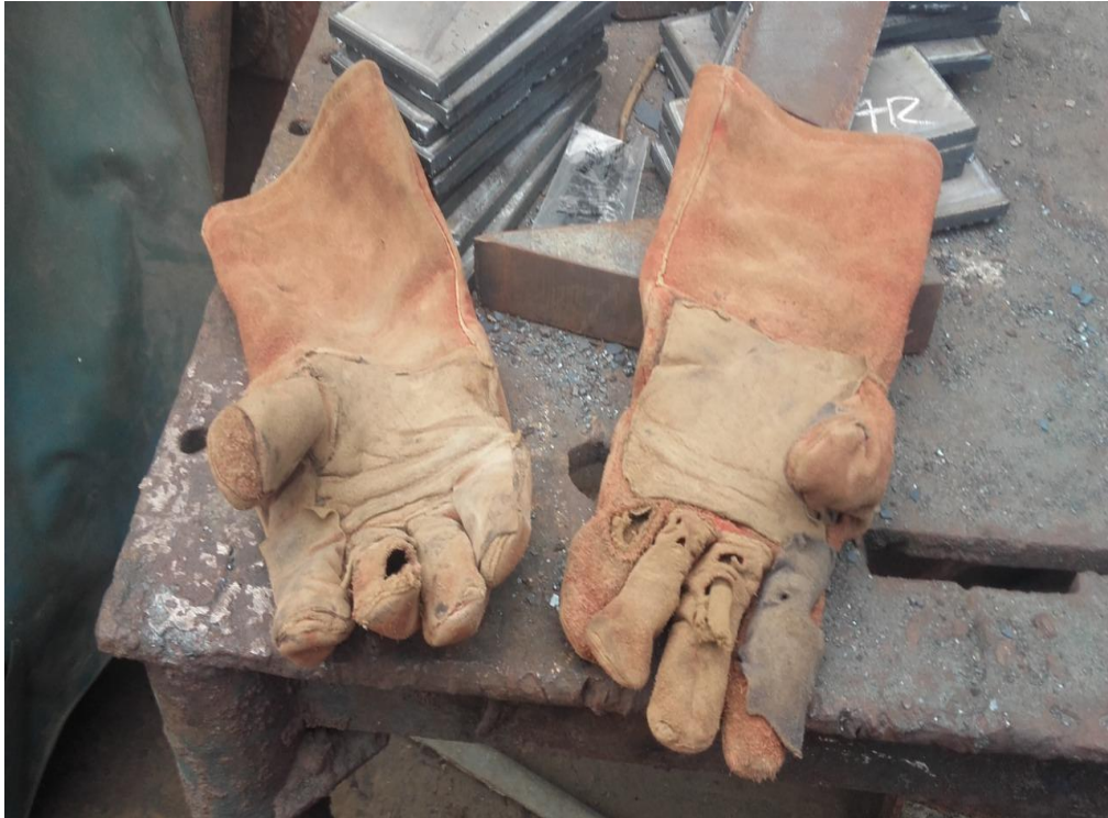
Figura 45: Riesgo: EPP en mal estado
