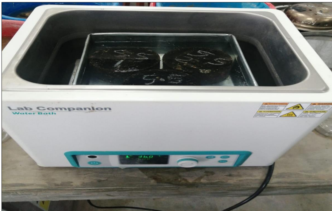
Foto 10. Baño María a las Briquetas antes de ser Ensayadas.
