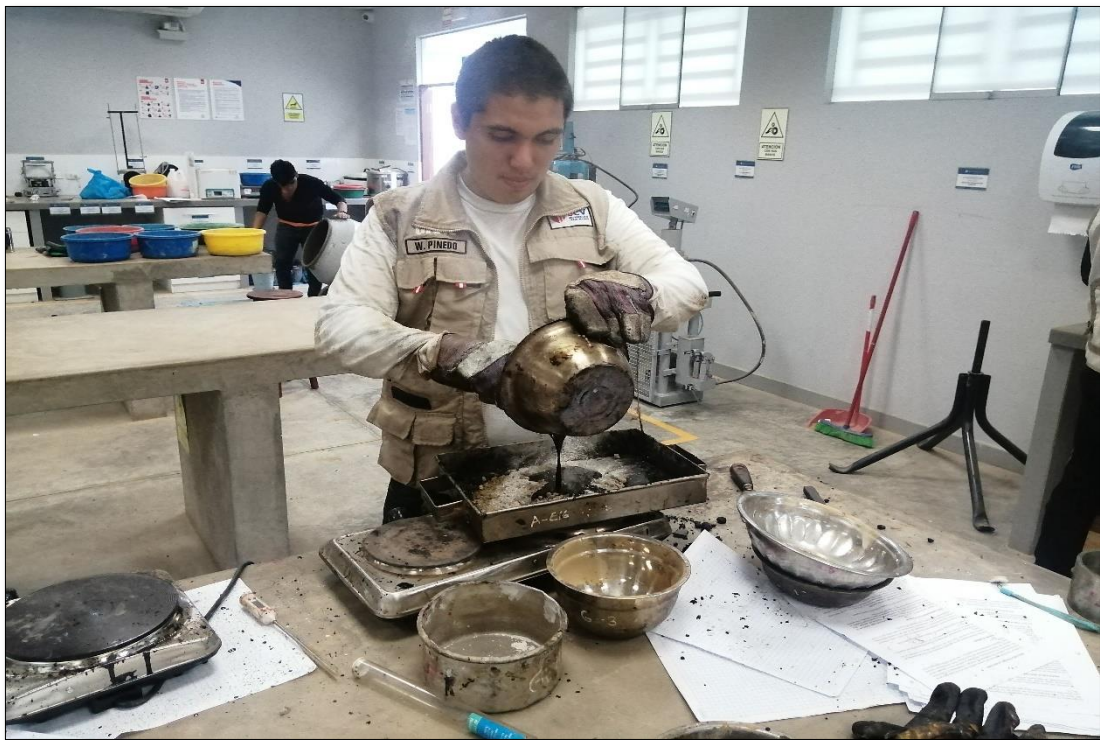
Foto 7. Preparación de la mezcla asfáltica. Fuente: autoría propia
