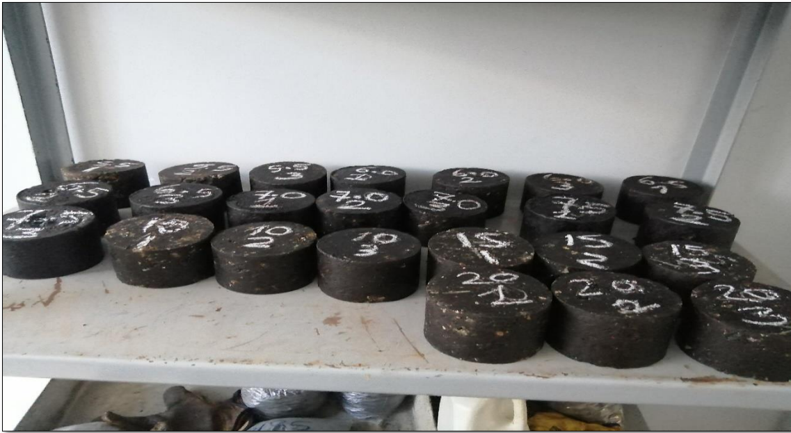
Foto 9. Briquetas (Convencional y con los porcentajes del 10%,15% y 20% de vidrio molido).
