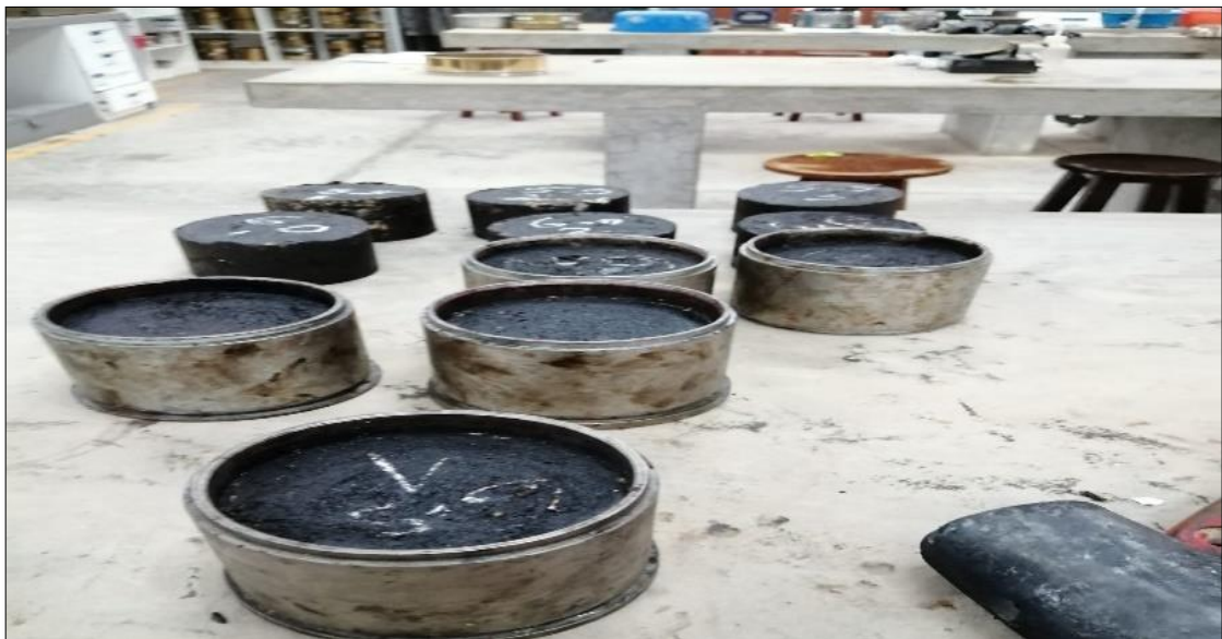
Foto 8. Briquetas compactadas en el molde. Fuente: autoría propia
