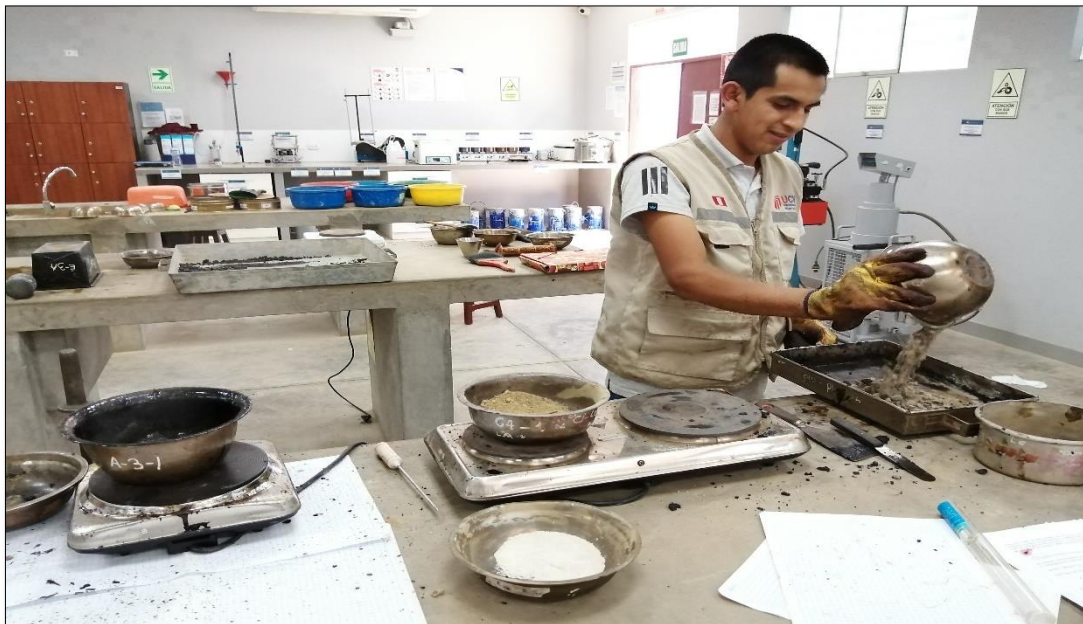
Foto 6. Calentamiento del material para el diseño de la mezcla asfáltica Fuente: autoría propia
