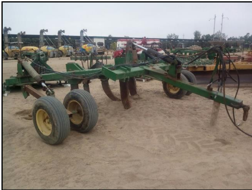
Figura N° 11: Subsolador, cuya función es penetrar la tierra a una profundidad de 90cm.
