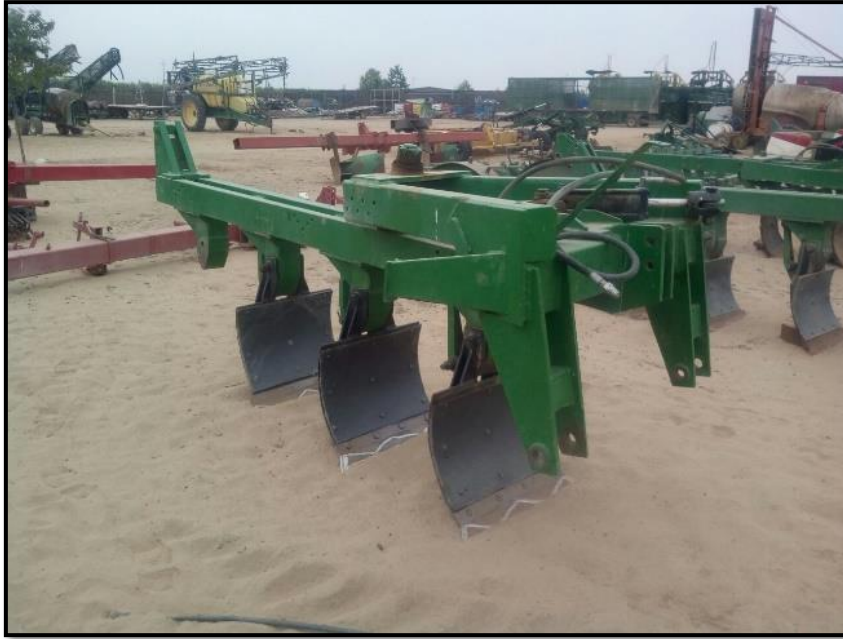
Figura N° 12: Arado de cuatro vertederas, usado para trabajos de arado en la empresa Agrícola Cerro Prieto S.A. Fuente: Autoría Propia
