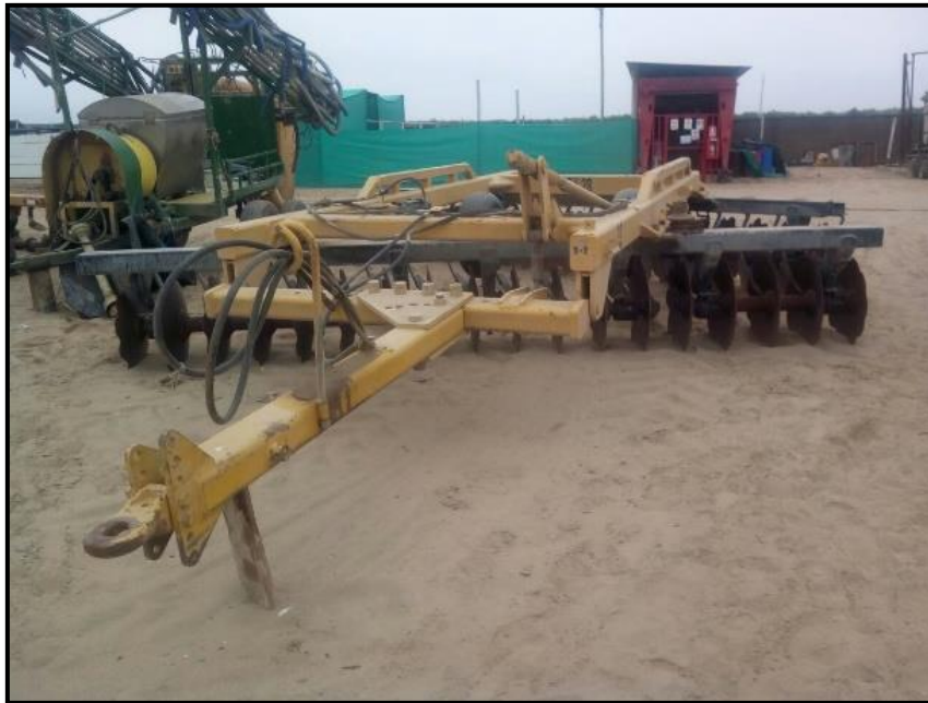
Figura 13: Rastra agrícola: utilizado en la parte final de preparación de terreno y luego crear las líneas de siembra. Fuente: Autoría Propia
