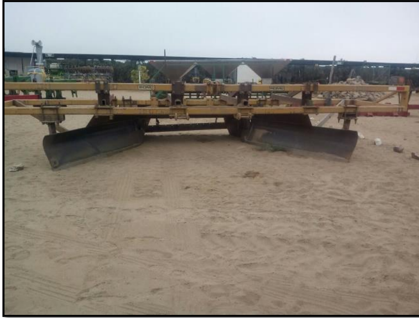
Figura 14: Encamadora, encargada de crear las camas o líneas de cultivo en donde se implantará los plantones de palto.
