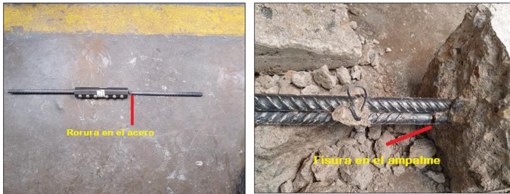
Figura 53: Fallas presentadas en el ensayo a tracción
