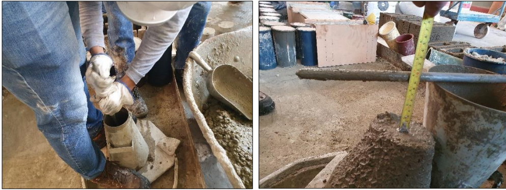
Figura 34: Ensayo de asentamiento (Slump)
