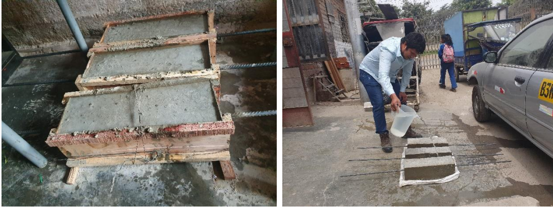
Figura 37. Desencofrado de las muestras
