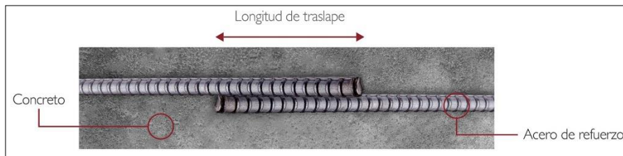
Figura 11: Empalme por traslape
