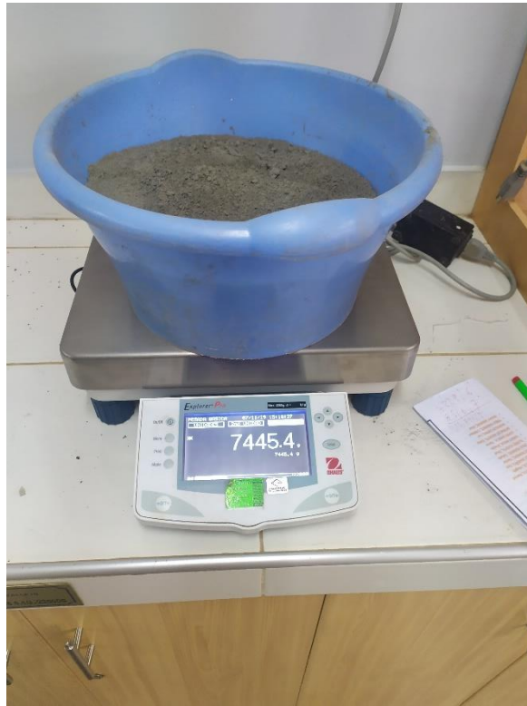
Figura N°22: realización de la mezcla: peso del cemento
