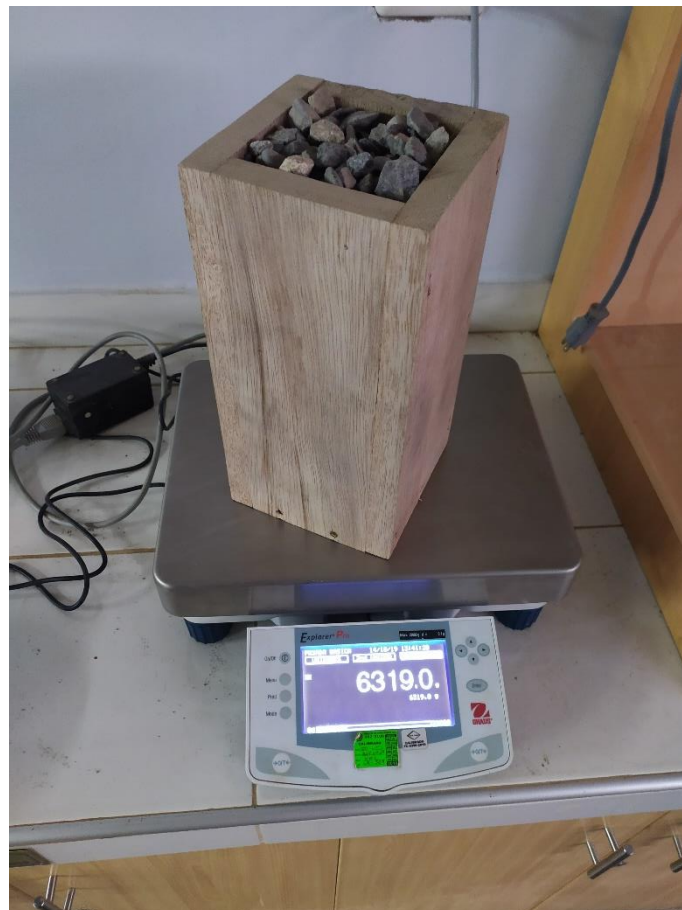
Figura N°15: peso unitario: peso del material
