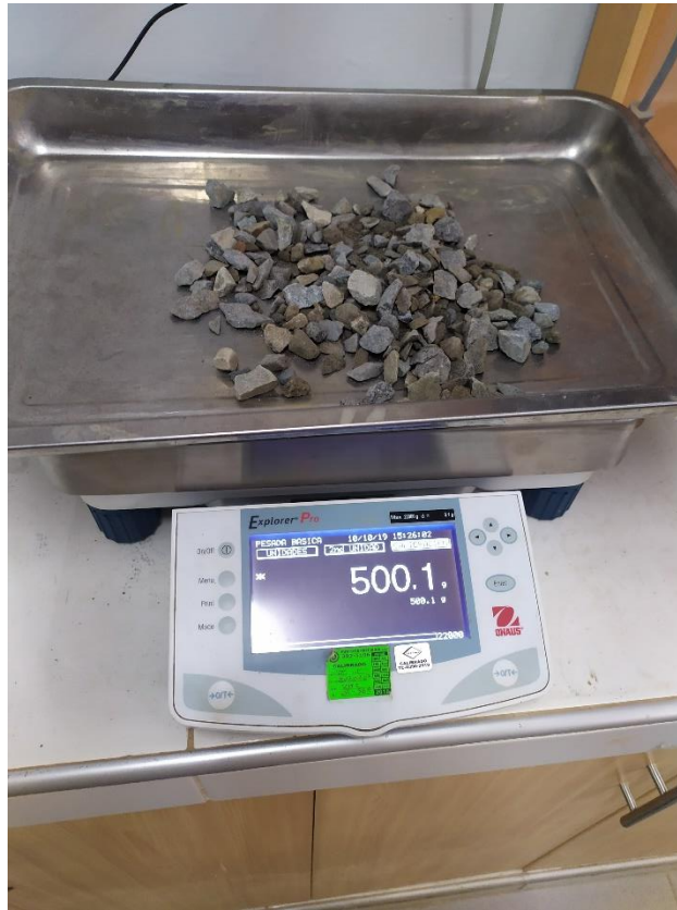
Figura N°9: traslado al horno para el porcentaje de humedad
