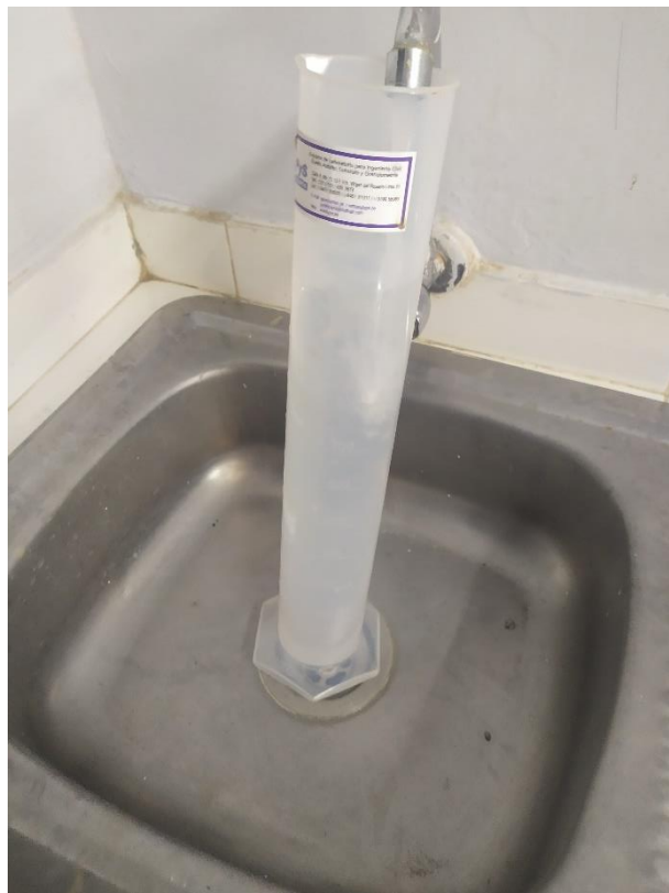
Figura N°23: realización de la mezcla: agua en litros
