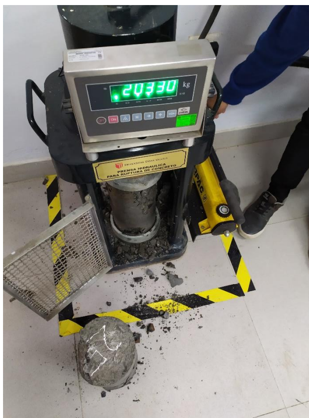
Figura N°27: ensayo de compresión: ruptura de a probeta
