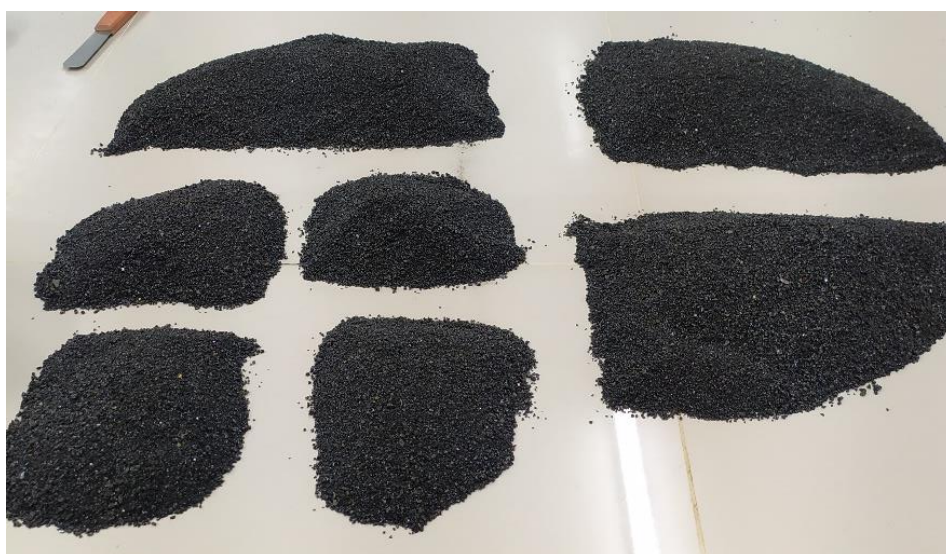
Figura N°7: cuarteo de escoria de cobre
