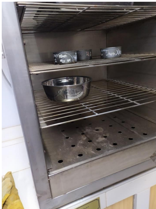
Figura N°9: traslado al horno para el porcentaje de humedad
