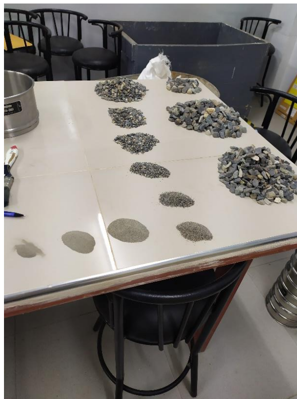
Figura N°13: granulometría: término del ensayo
