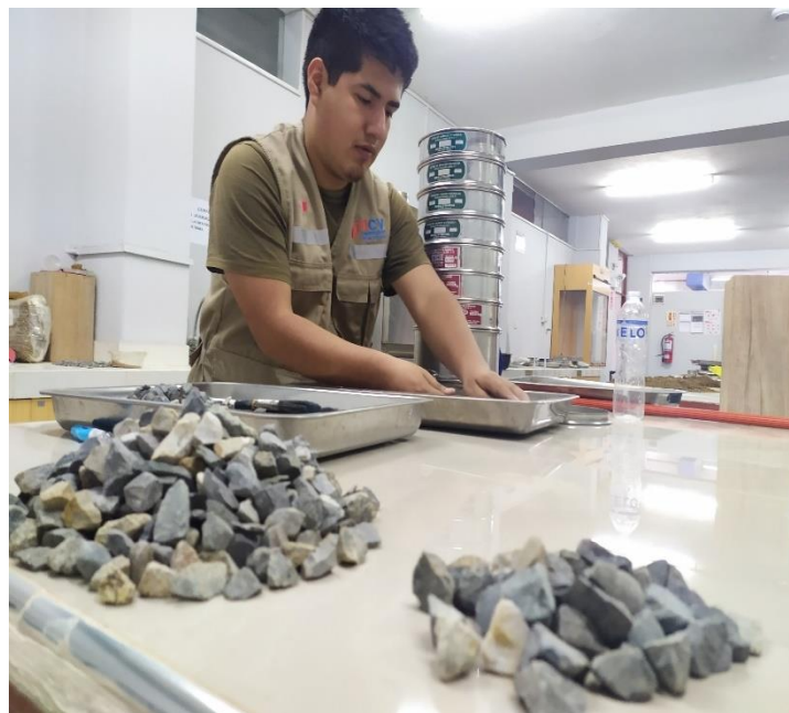
Figura N°11: granulometría, tamizado de los agregados
