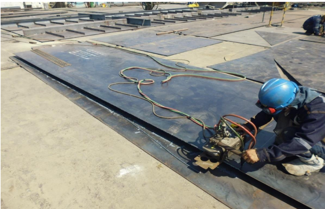
Anexo N° 30: Habilitado de planchas usando carrito de corte semiautomático.
