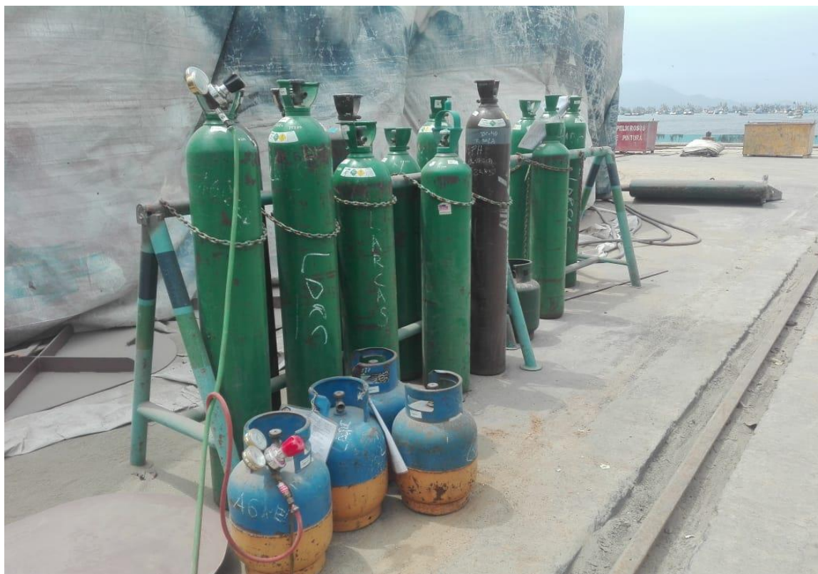
Anexo N° 37: Botellas de oxígeno y gas expuestas en área de operaciones.
