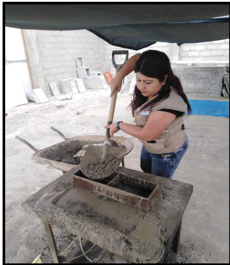
IMAGEN N° 4: VACEADO DE MEZCLA PRIMERA CAPA, EN EL MOLDE PAR SU VIBRACIÓN
