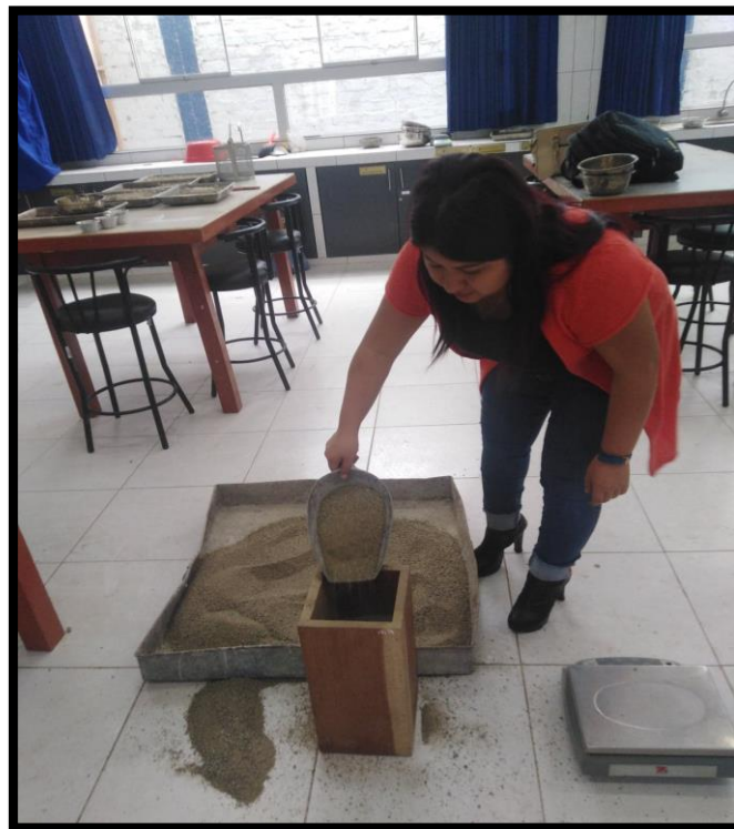
IMAGEN N° 12: PESO UNITARIO SUELTO DEL AGREGADO FINO (ARENA)
