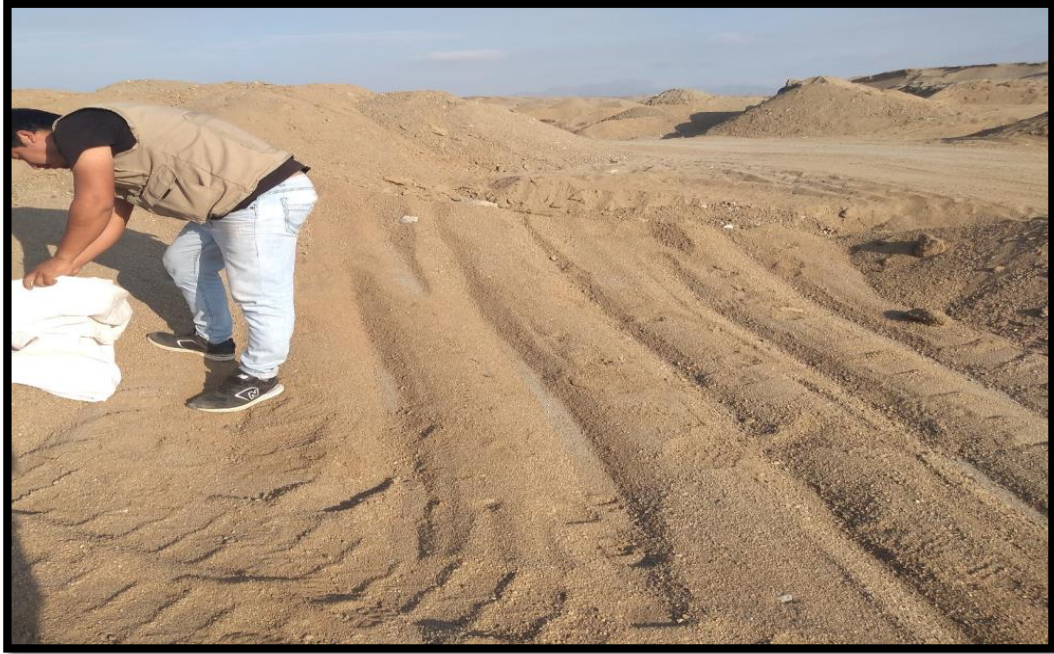
IMAGEN N° 1: MUESTREO DE AFIRMADO CANTERA “SAN PEDRITO”
