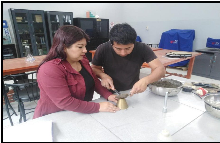
IMAGEN N° 16: PRUEBA DEL AGREGADO FINO (ARENA) PARA PESO Y ESPECÍFICO Y ABSORCIÓN
