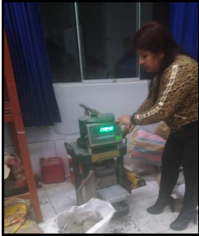
IMAGEN N° 9: ENSAYO DE RESISTENCIA A LA COMPRESIÓN
