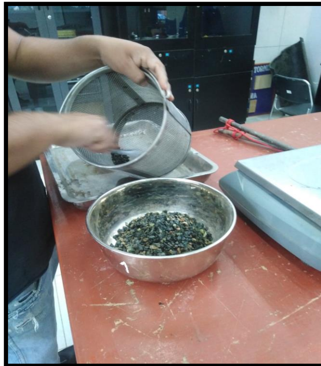
IMAGEN N° 14: PESADO AGREGADO GRUESO (CONFITILLO) DEL ENSAYO PESO ESPECÍFICO
