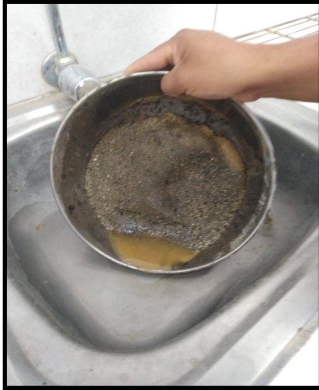
IMAGEN N° 15: MATERIAL AGREGADO FINO PARA EL ENSAYO DE PESO Y ESPECÍFICO Y ABSORCIÓN
