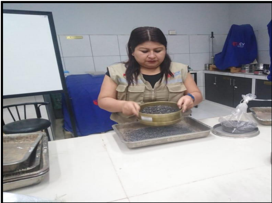
IMAGEN N° 2: TAMIZADO DEL MATERIAL ESCORIA DE SIDERPEÚ
