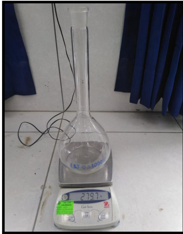
IMAGEN N° 17: PESO DE LA FIOLA PARA EL ENSAYO DE ARSORCIÓN
