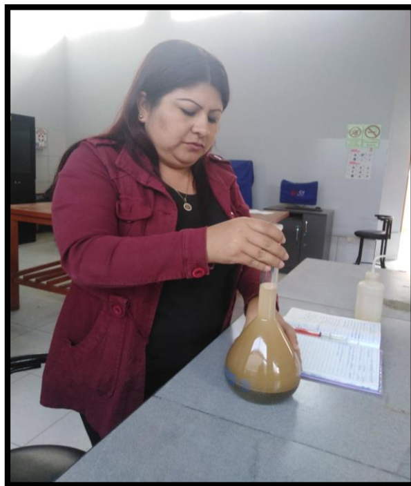
IMAGEN N° 17: PESO DE LA FIOLA PARA EL ENSAYO DE ARSORCIÓN
