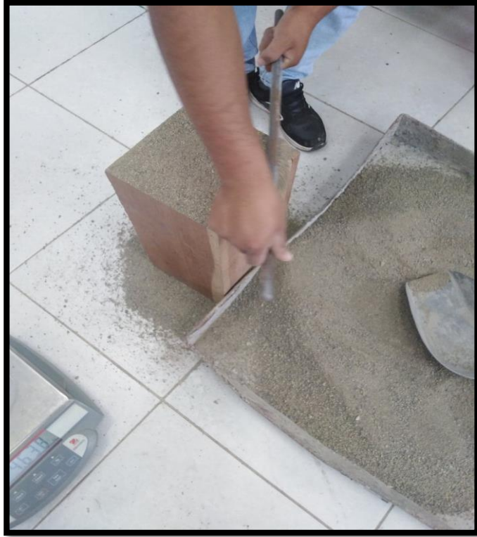
IMAGEN N° 11: ERAZADO DEL PESO UNITARIO COMPACTADO DEL AGREGADO FINO (ARENA)
