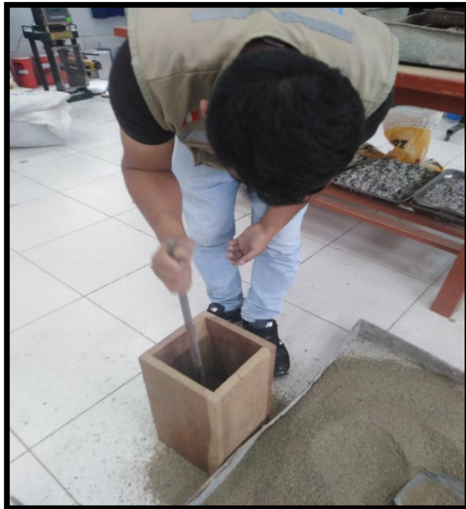
IMAGEN N° 10: PESOS UNITARIOS COMPACTADO DEL AGREGADO FINO (ARENA)
