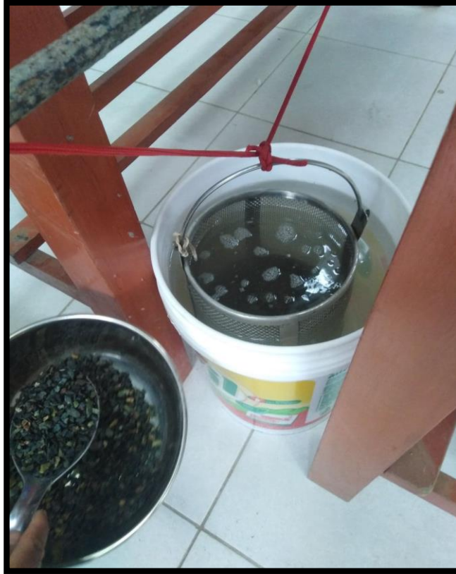
IMAGEN N° 13: PESO ESPECÍFICO Y ARSORCIÓN DEL AGREGADO GRUESO (CONFITILLO)
