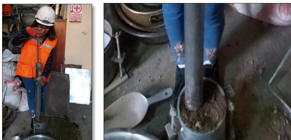
Figura N°24: Apisonado de CBR
