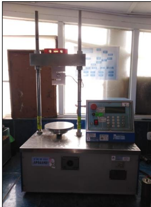
Figura N°2: Prensa de ensayo de CBR
