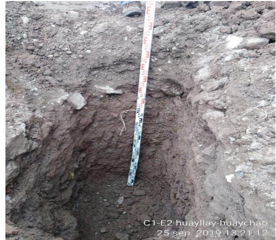
Anexo 5.1.2: Altura de calicata (1.50 m)
