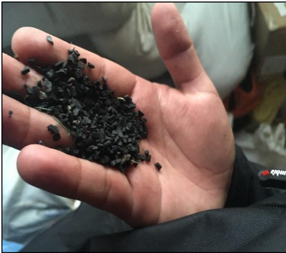
Figura N°12: Caucho granulado (2.5 mm)
