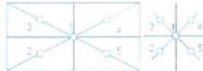
Figura 2. Posiciones de carga para la prueba de excentricidad
