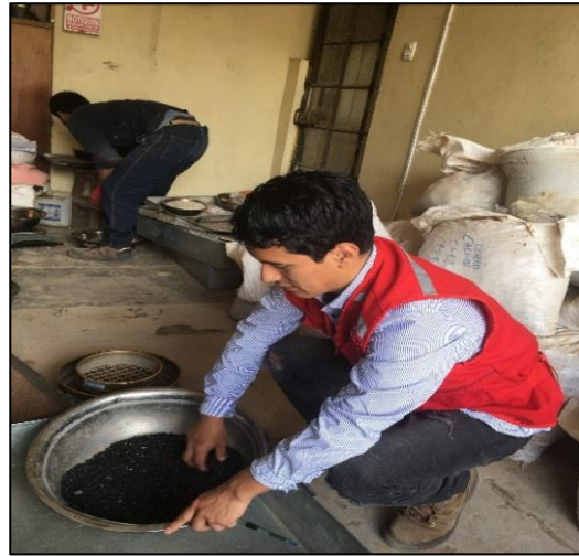
Figura N°13: Homogenización del Caucho granulado
