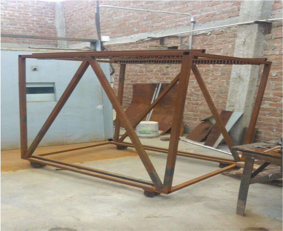
Figura N° 24: Estructura de coche sujetador de hojas para secador
