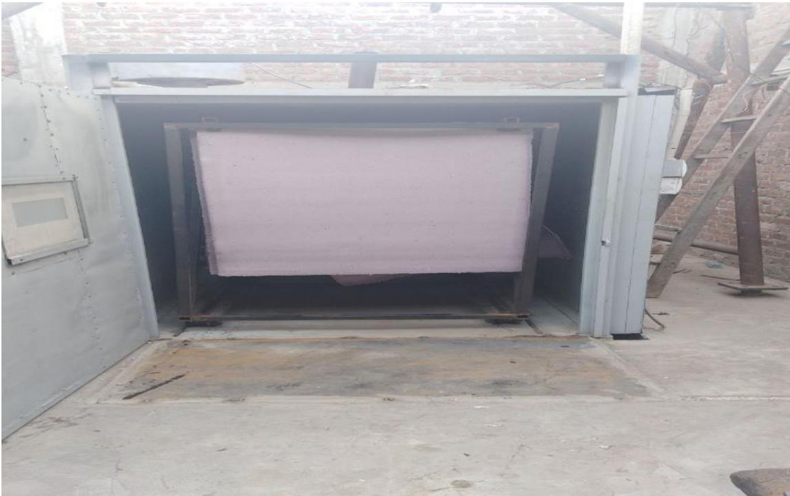
**FIGURA 46: COLOCACIÓN DE COCHE CON HOJAS DE HUMEDAD PARA EL SECADO**
