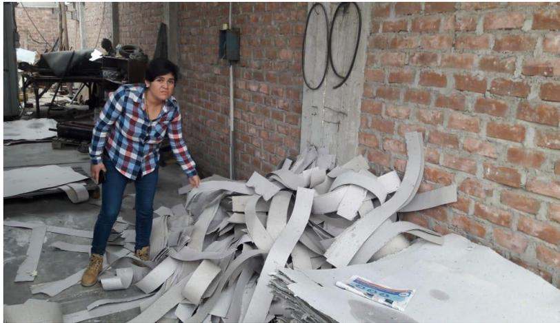
FIGURA 17: EXCESIVOS RECORTES EN EL ACABADO, EMPRESA IPEFICAL
