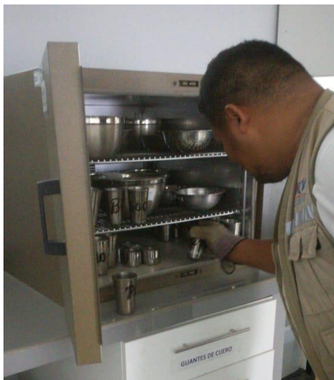
Estudios de suelos: Contenido de Humedad – retiro del horno
