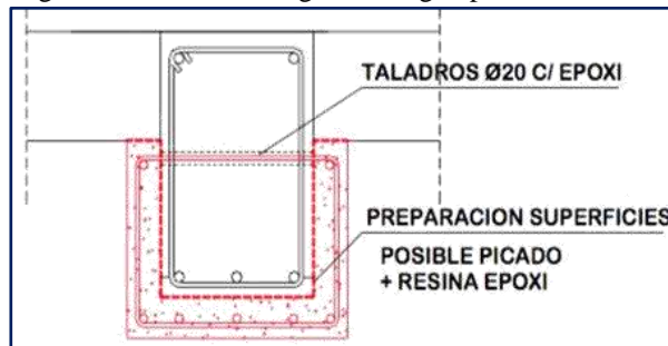
Figura 27 Armado en viga de cuelgue para refuerzo a flexión
