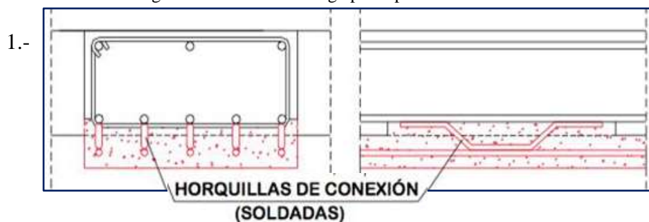
Figura 26 Armadura en viga plana para con refuerzo a flexión.
