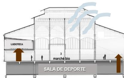
Los beneficios del techo existente además de la ventilación, es el ingreso de la ventilación de forma natural permitiendo así el confort interno del mercado dada al gran aforo que recibirá y el amplio espacio interno permitirá lograr la óptima circulación del aire.
