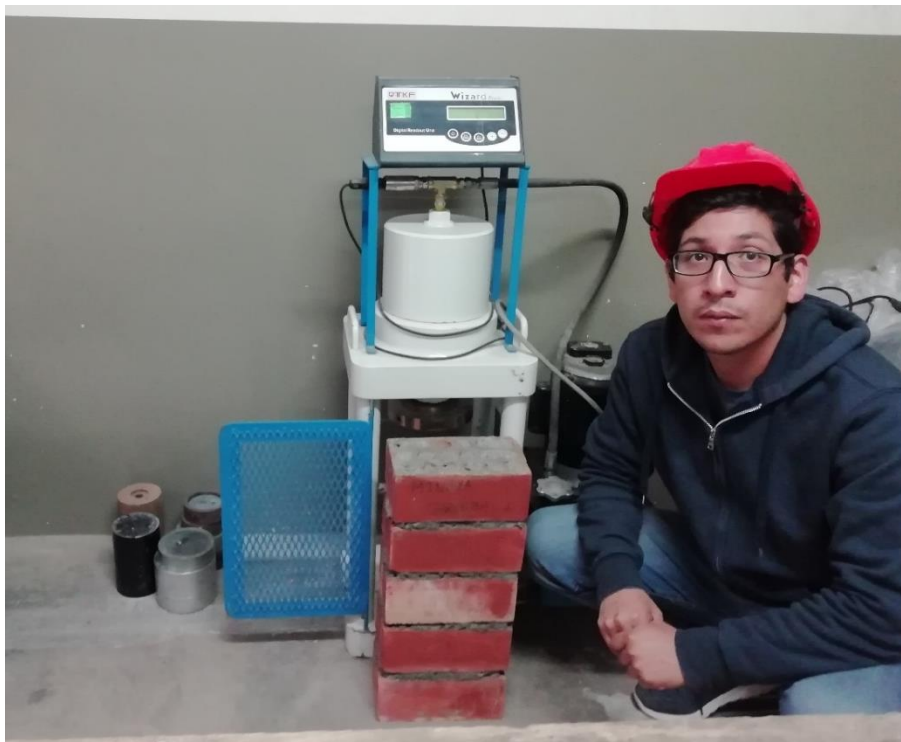
Ilustración 10 Ensayo de compresión axial de pila - Fuente propia
