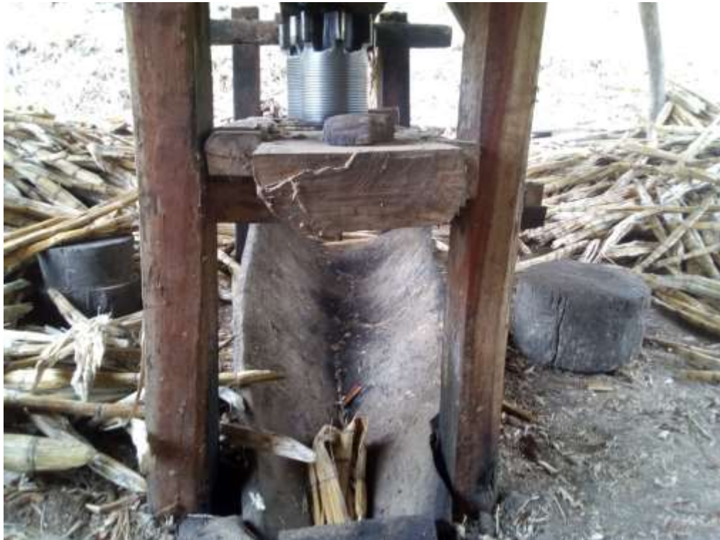
Imagen 17. Recorrido de jugo a alambique fermentador, mediante canaleta conectada a tubo SCH 10 Ø 3"
