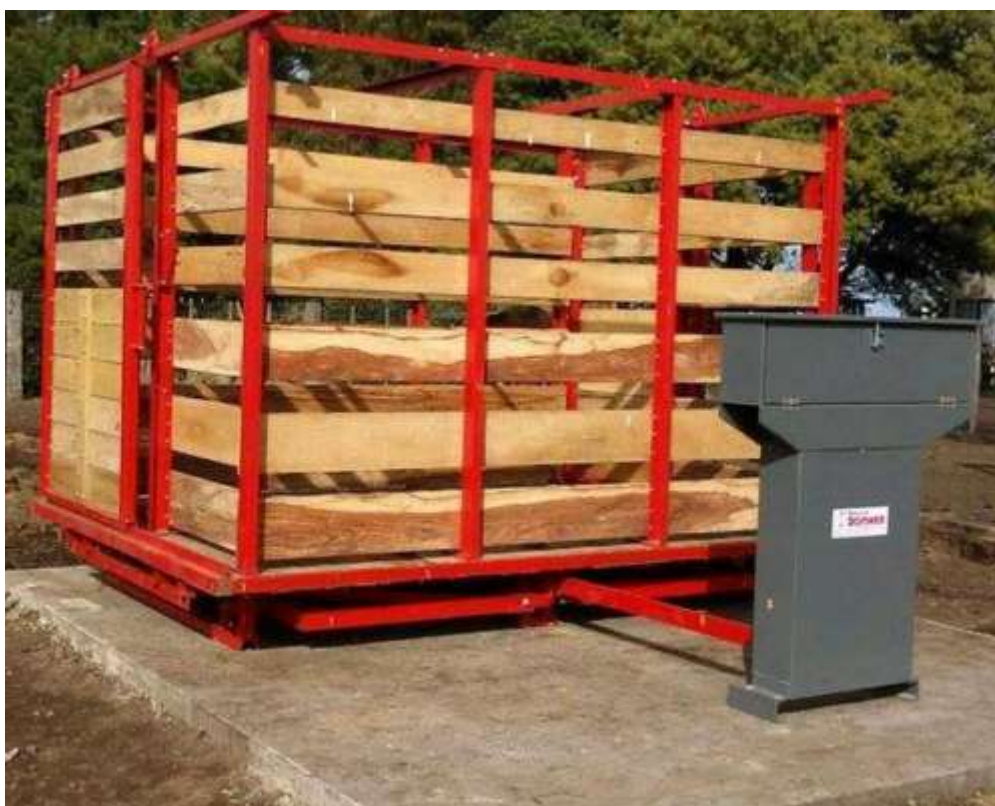
Imagen 20. Balanza DOHER, capacidad de 3000 KG, usada para pesar caña de azúcar.
