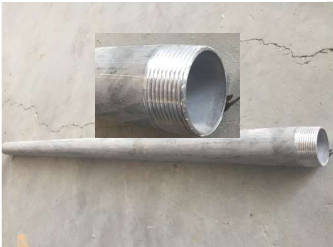
Imagen 18. Tubo SCH 10 Ø 3", usado para eliminar el transporte por tinajas
