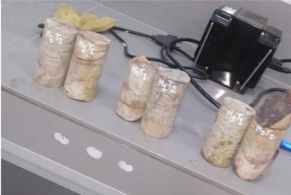
Figura 24: Testigos obtenidos mediante perforación diamantina
