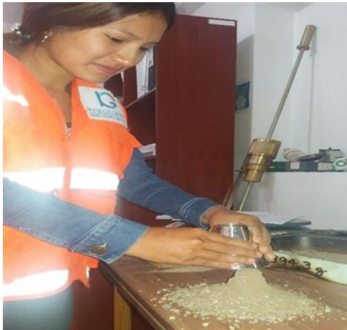
Figura 49. Observación de la saturación de la mezcla, Fuente: Archivo propio,
