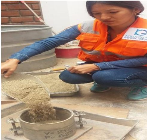
Figura 56. Llenado del molde de dos niveles Fuente: Archivo propio
