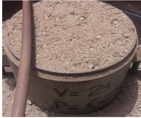
Figura 62. Nivelación del recipiente Fuente: Archivo propio
