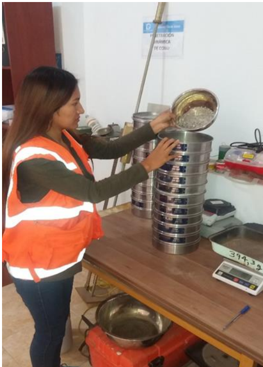
Figura 31. Tamizado con caída libre Fuente: Archivo propio
