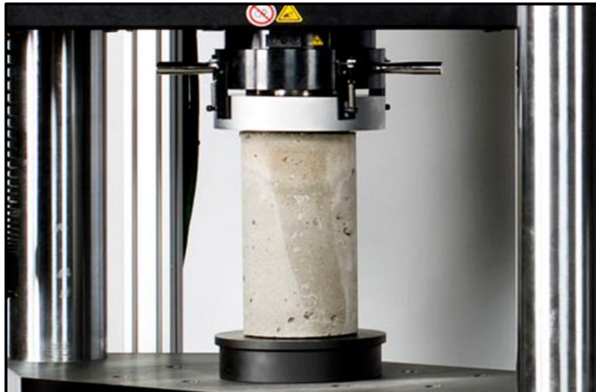
Figura 5. Ensayo de resistencia a la compresión de probetas cilíndricas de concreto. Fuente: Ponce (2016).
