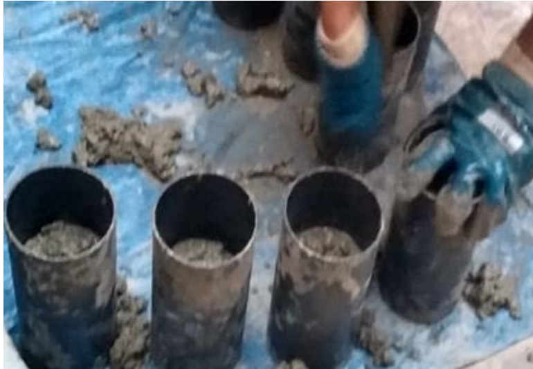
Figura 79. Ejecución de los golpes 25 con la varilla de 5/8 en 2 capas Fuente: Archivo propio
