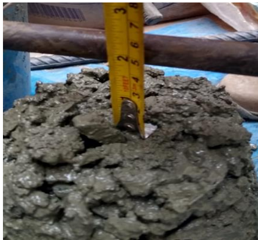
Figura 78. Slump de 2" con aditivo 0.5% Fuente: Archivo propio
