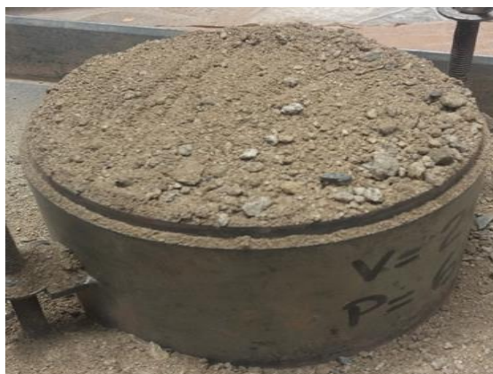
Figura 58. Retiro del segundo nivel Fuente: Archivo Propio
