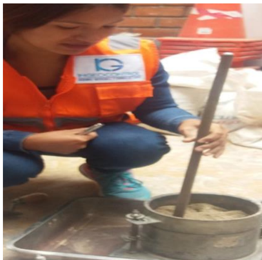
Figura 61. Llenado y compactación del agregado en el recipiente de dos n niveles Fuente: Archivo propio
