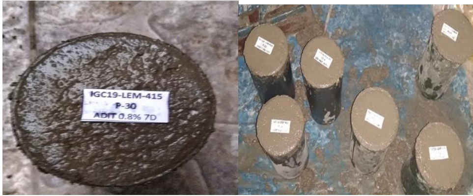
Figura 82. En la figura observamos el vaciado completo y uniforme de la probeta con aditivo 0.8% Fuente: Archivo propio
