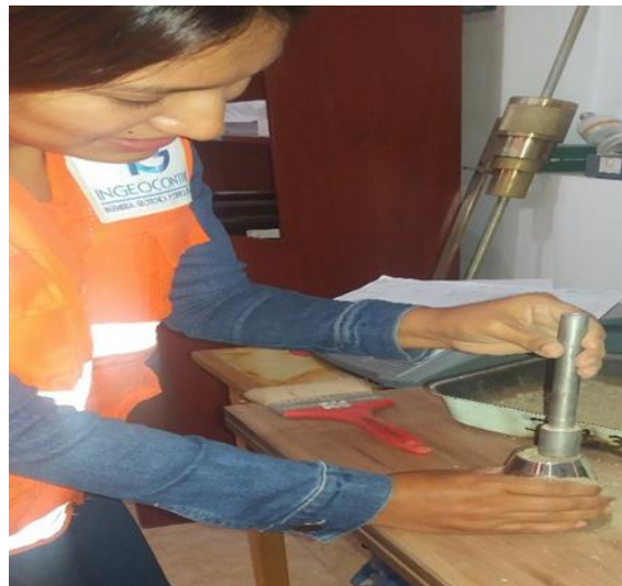
Figura 46. Compactación del agregado en la prueba de cono. Fuente: Archivo propio.
