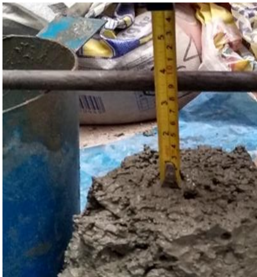
Figura 81. En la figura observamos el slump de 3 1/4" con aditivo 0.8%. Fuente: Archivo propio
