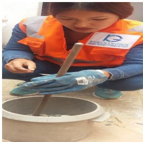
Figura 67. Llenado y compactación de la muestra en el recipiente de dos niveles Fuente: Archivo propio
