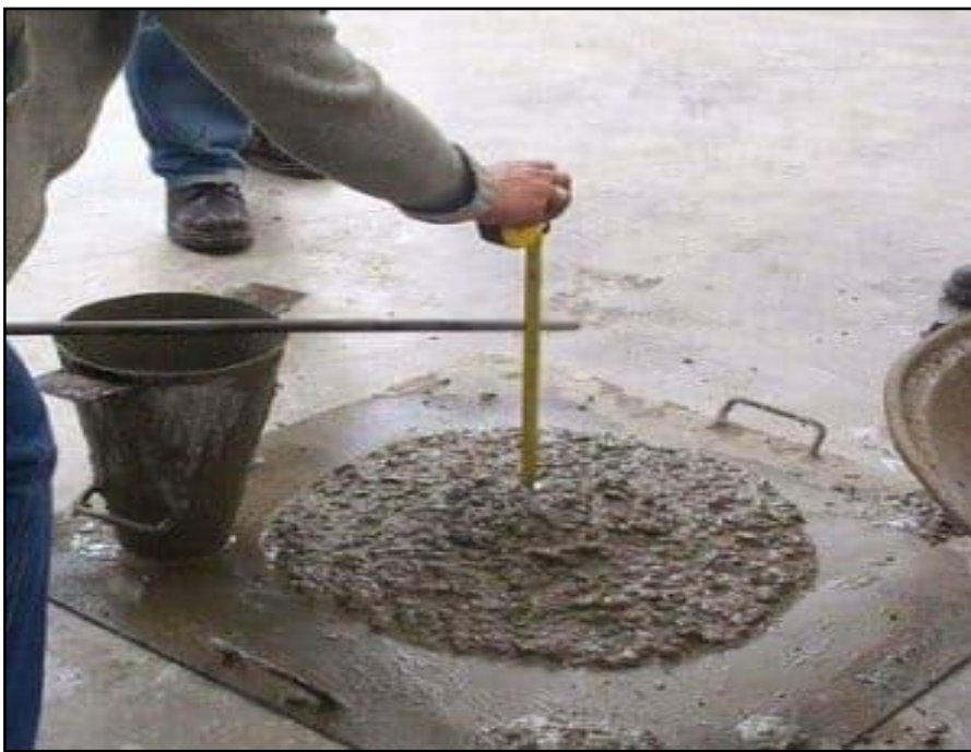
Figura 8. Efecto de un aditivo superplastificante en la trabajabilidad del concreto. Fuente: Sika
