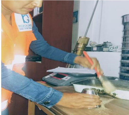
Figura 47. Limpieza del agregado residual Fuente: Archivo propio
