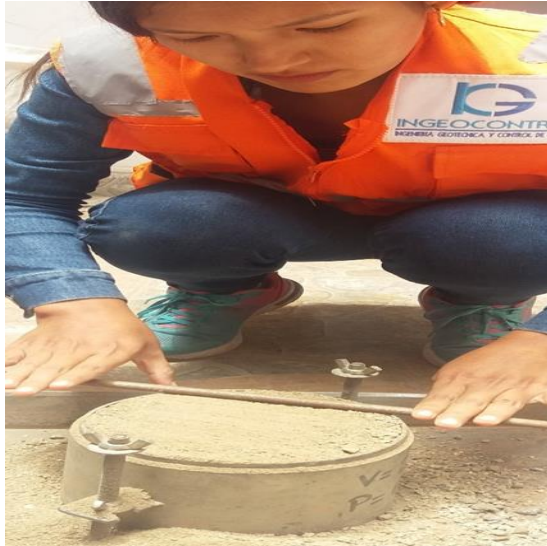
Figura 59. Nivelación del molde Fuente: Archivo Propio
