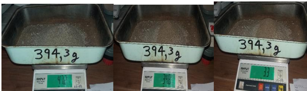
Figura 34. Cantidad de agregado retenido por el tamiz 100, 200 y fondo respectivamente Fuente: Archivo propio
