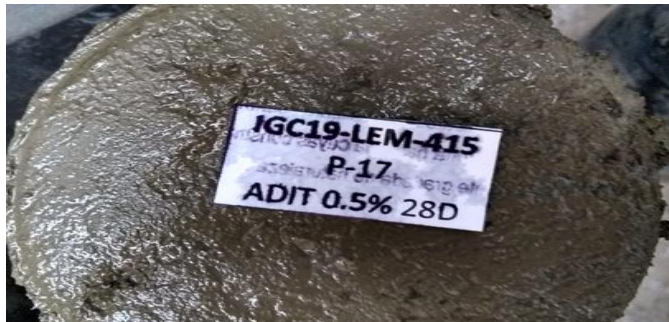
Figura 80. En la figura observamos el vaciado completo y uniforme de la probeta con aditivo 0.5%
