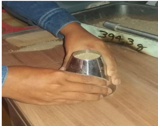
Figura 48. Preparación del cono, Fuente: Archivo propio.
