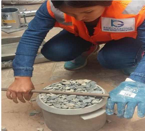
Figura 65. Nivelación de la muestra Fuente: Archivo propio
