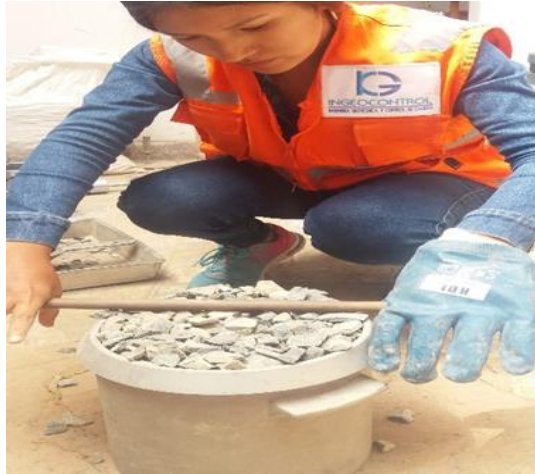
Figura 68. Nivelación de la muestra Fuente: Archivo propio
