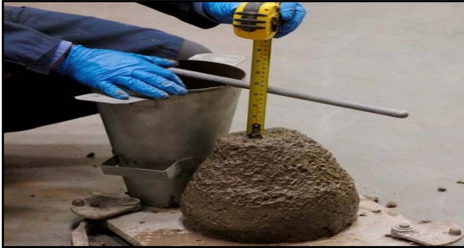
Figura 6. Medición de la trabajabilidad del concreto mediante el cono de Abrahams. Fuente: Ponce (2016)
