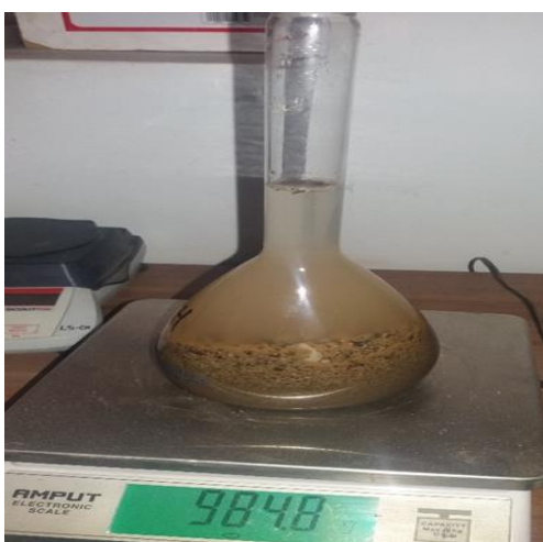
Figura 54: Peso de la fiola con agua. Fuente: Archivo propio
