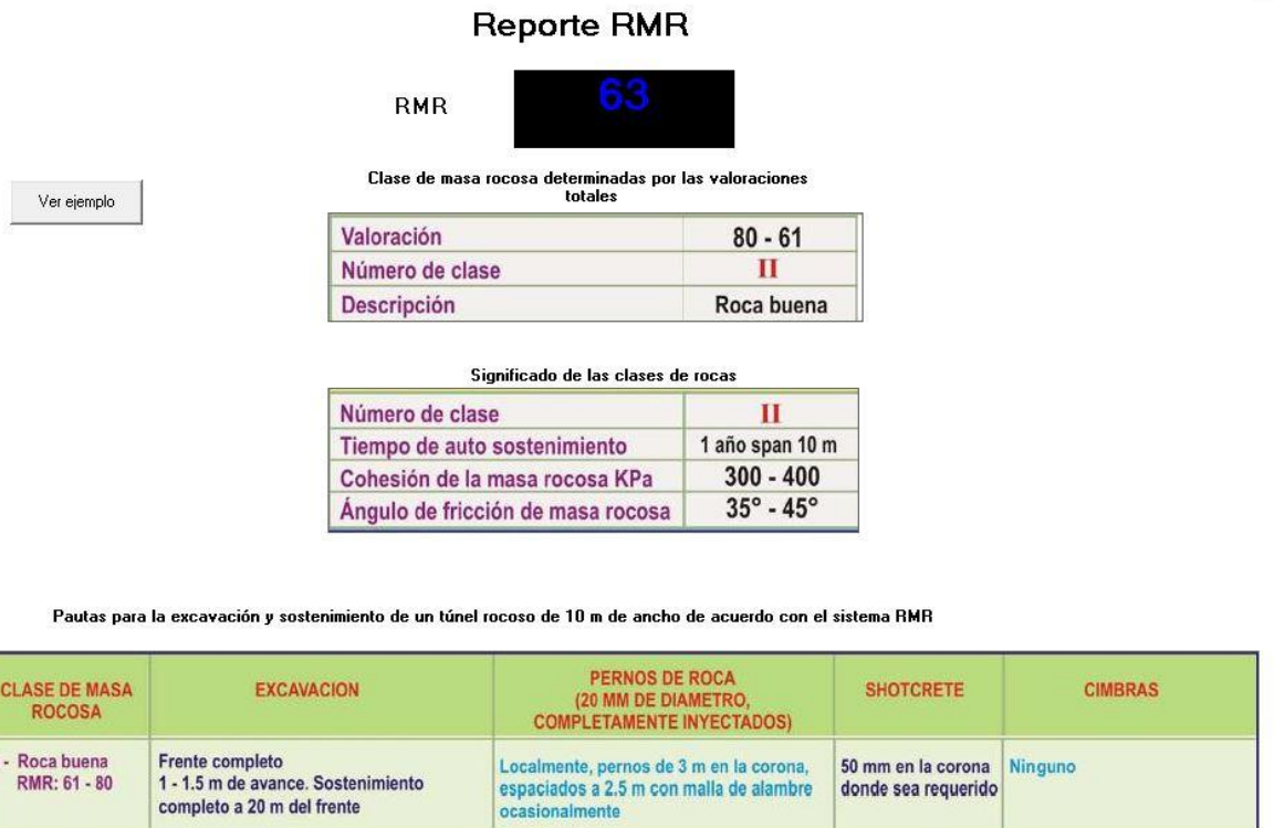
Figura 10. Reporte RMR del Socavón del Nivel 332
