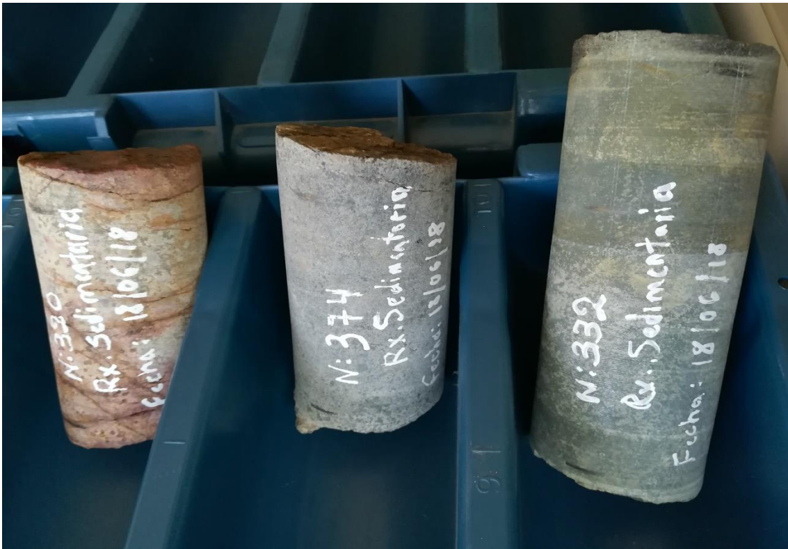
Figura 87. Testigos obtenidos para Ensayos de Resistencia en laboratorio.
