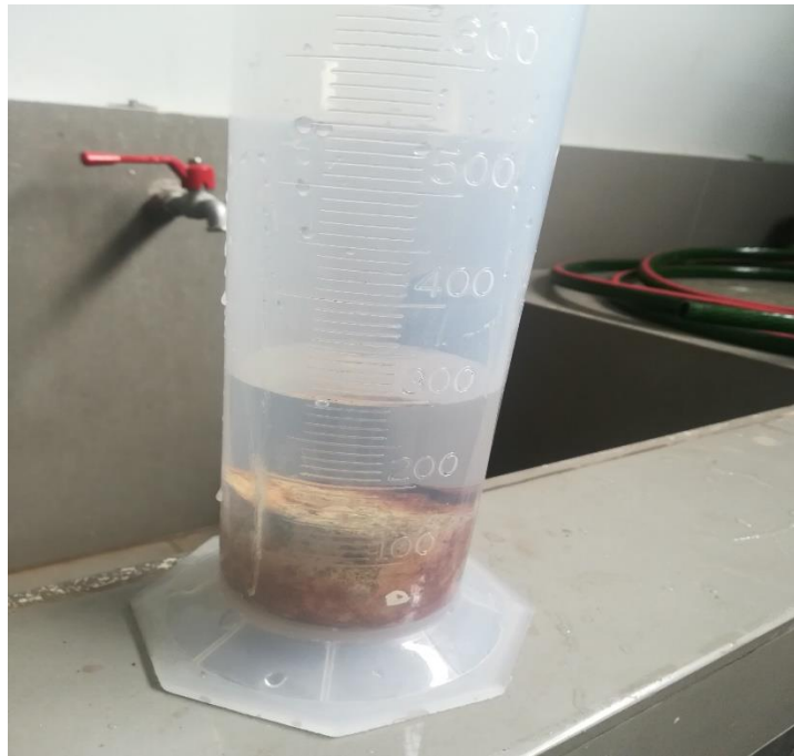
Figura 81. Ensayo de Densidad mediante el la Teoría de Arquímedes.
