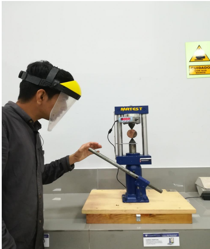
Figura 83. Ensayo de Carga Puntual
