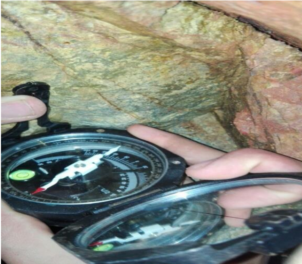
Figura 84. Registro de Buzamiento y Dirección de Buzamiento con Brújula
