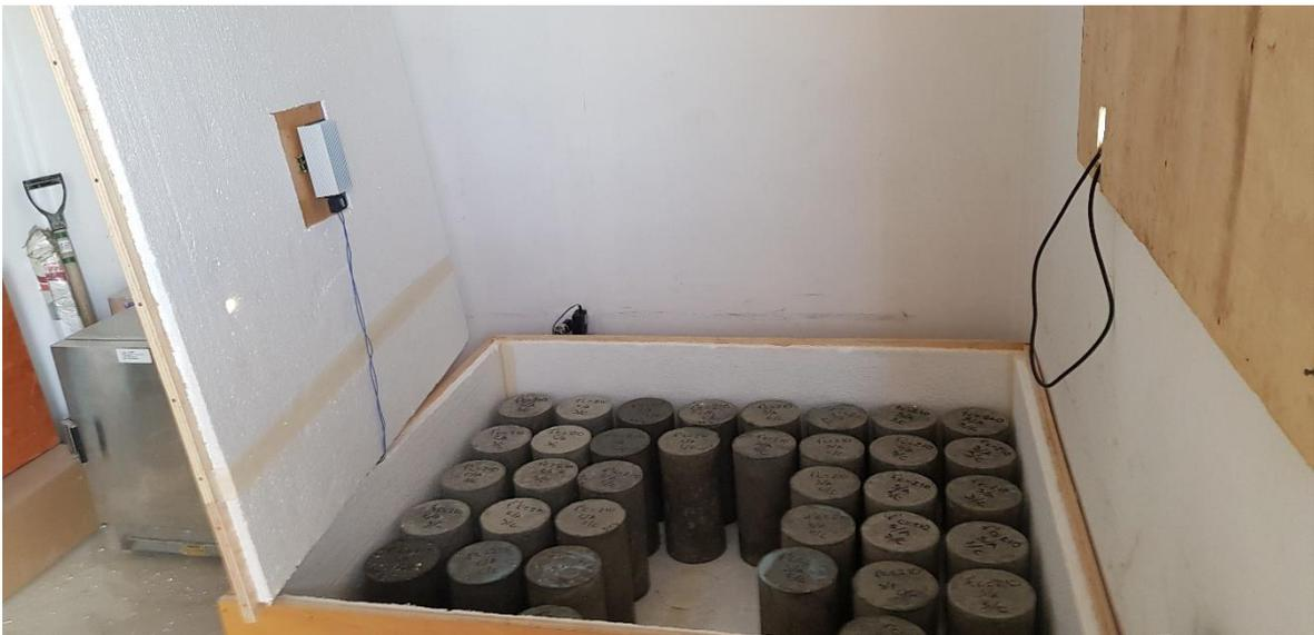
Fotos 16 y 17: Control de temperatura en probetas.
