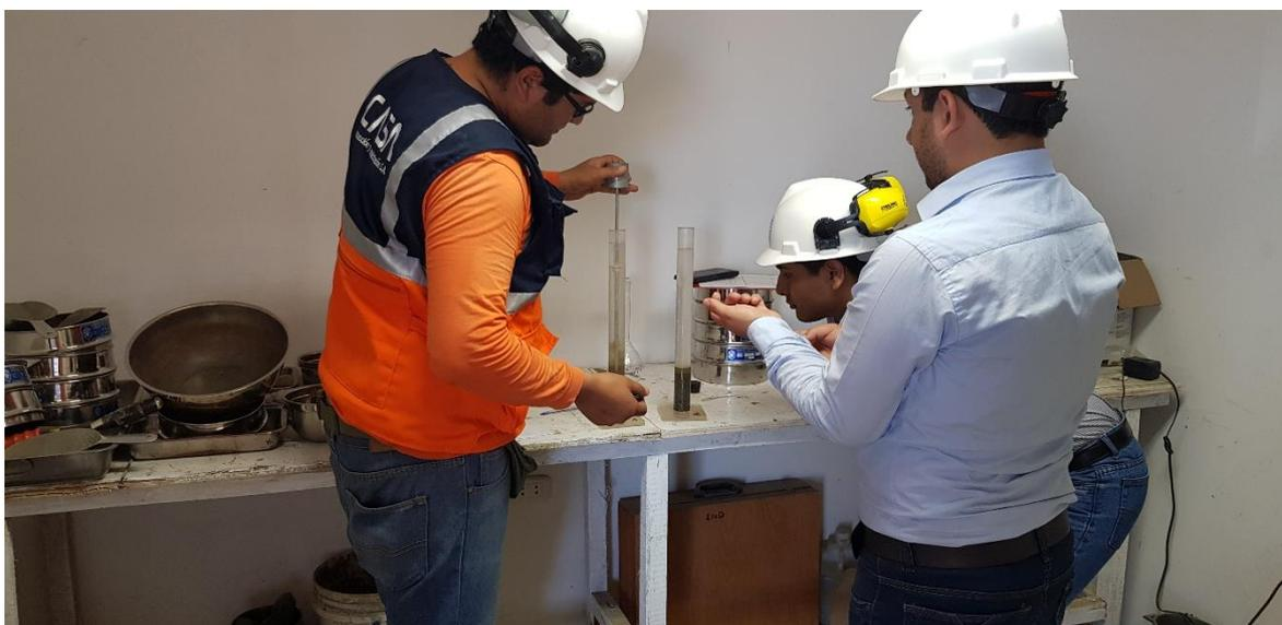
Foto 02: Ensayo de granulometría.
