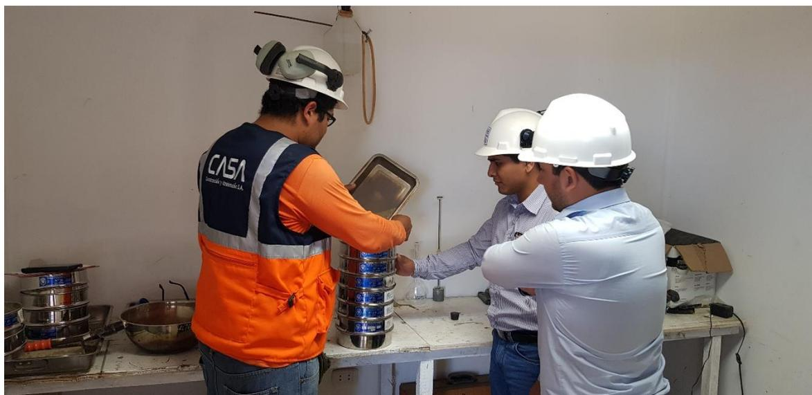
Foto 03: Ensayo peso unitario compactado.
