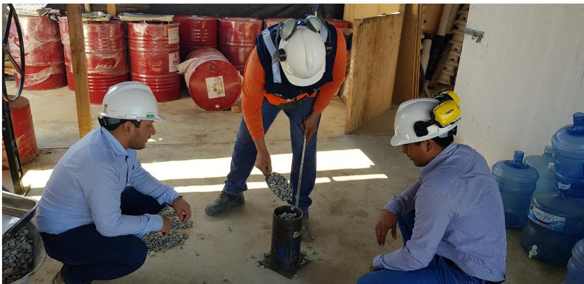
Foto 04: Ensayo de abrasión.
