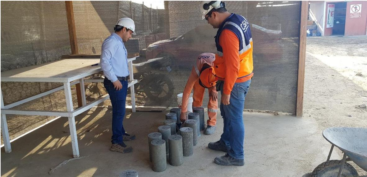
Foto 15: Ubicación de las probetas en las cajas de método adiabático.
