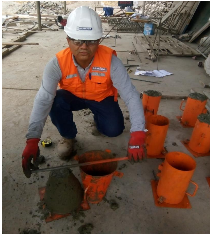
Imagen No. 11: Sacando el slam y probetas de la losa.
