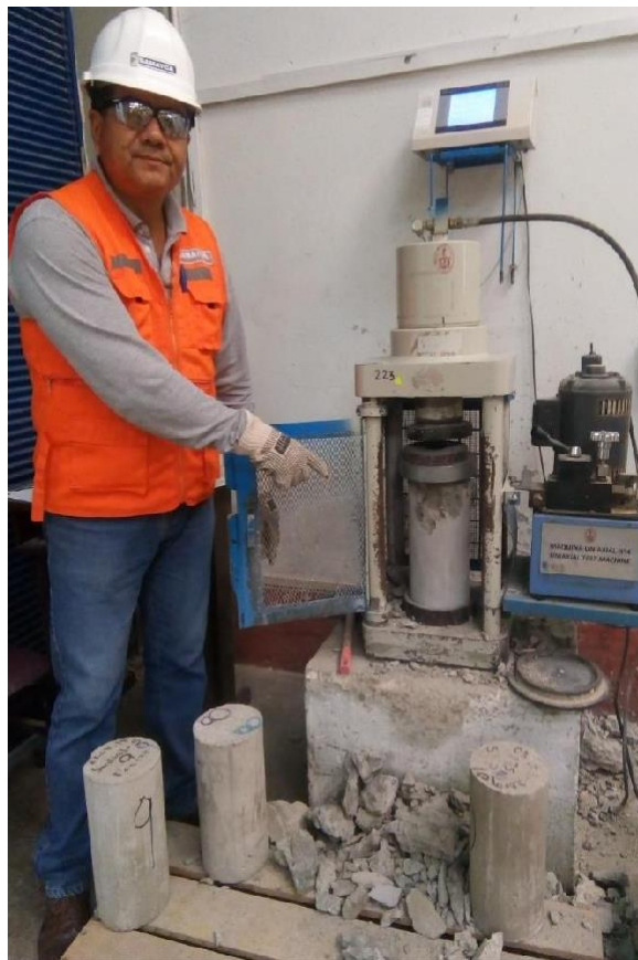
Imagen No. 15: Ensayo de Compresión de probetas.
