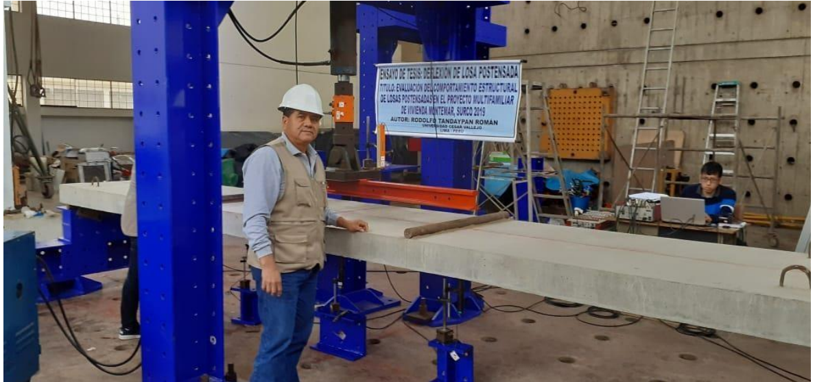
Imagen No. 18: Ensayo de deflexión de la losa postensada.
