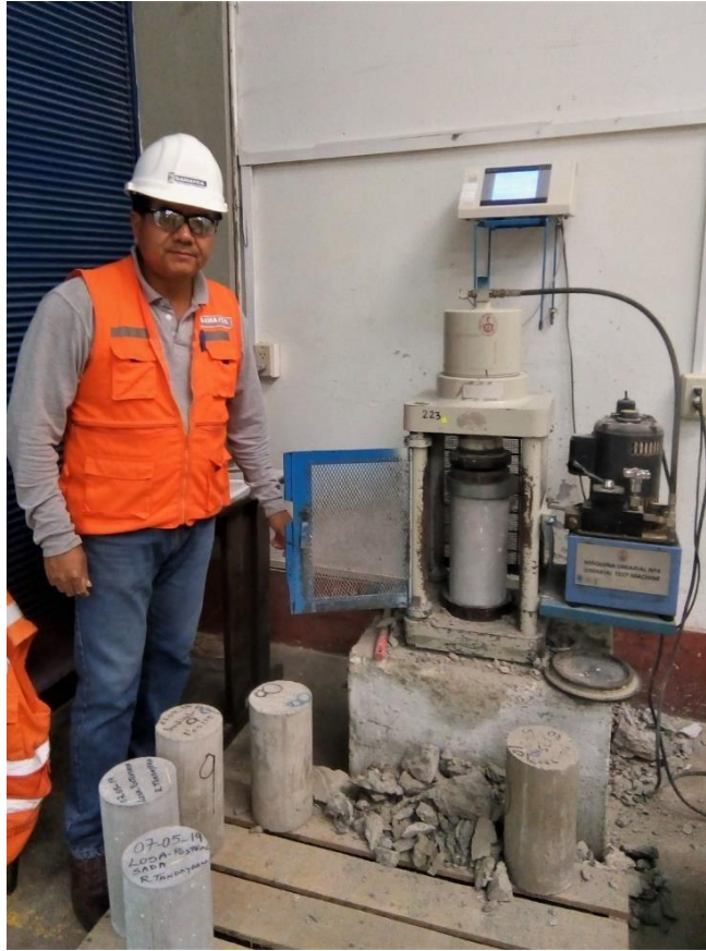
Imagen No. 17: Colocación de cojines de neopreno en las probetas.
