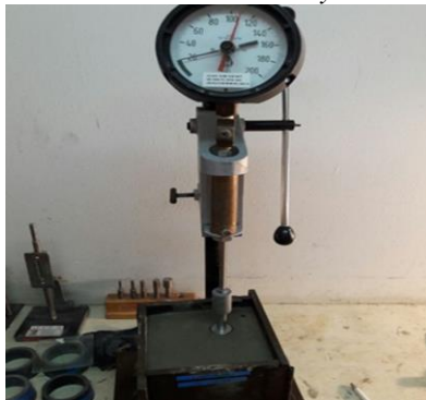
Figura 37: Penetrómetro Ensayo de Fragua
