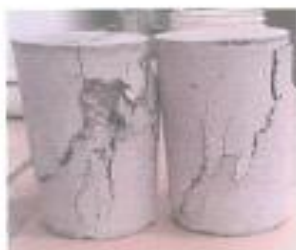
Resistencia a la Compresión a 7 Días Falla Tipo 4.- Fractura diagonal sin fisuras a través de los extremos; golpee suavemente con un martillo para distinguir del Tipo 1.
