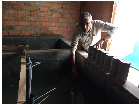
Figura 40: Poza de Curado colocación de Probetas
