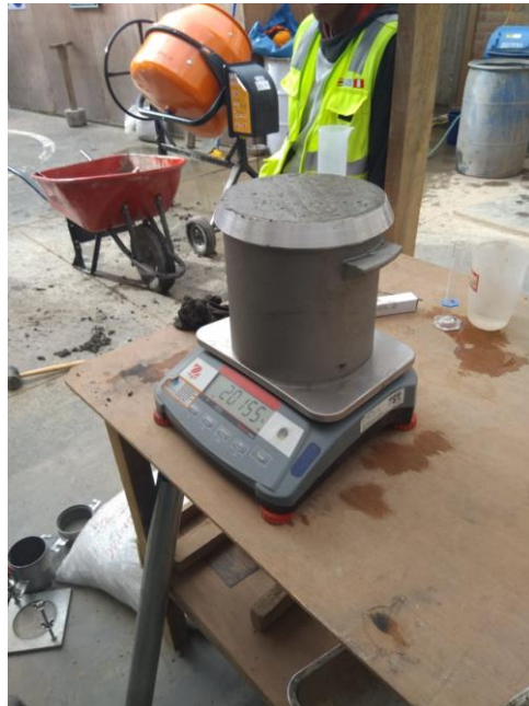
Figura 34: Ensayo del Peso Unitario del concreto Fresco
