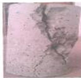
Resistencia a la Compresión a 72 Horas Falla Tipo 3.- Fisuras verticales encolumnadas a través de ambos extremos, conos mal formados.
