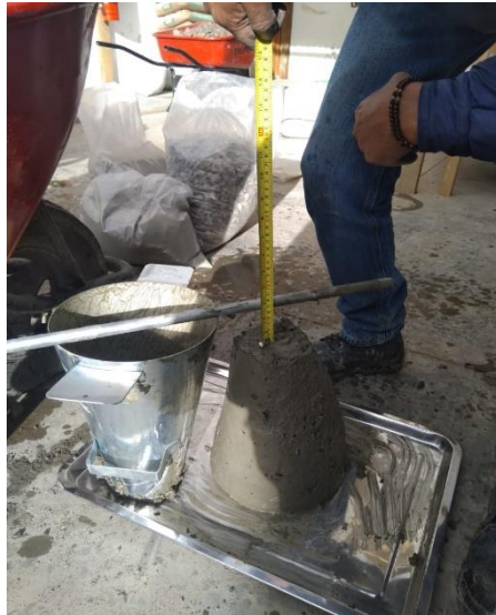
Figura 32: Ensayo de Asentamiento
