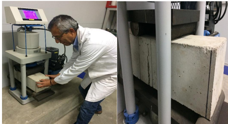
Ensayo de flexión (vigas apoyadas en los dos tercios de los extremos)
