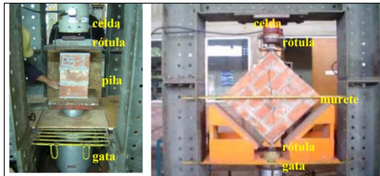
Figura 8. Ensayo de compresión axial y diagonal de muretes
