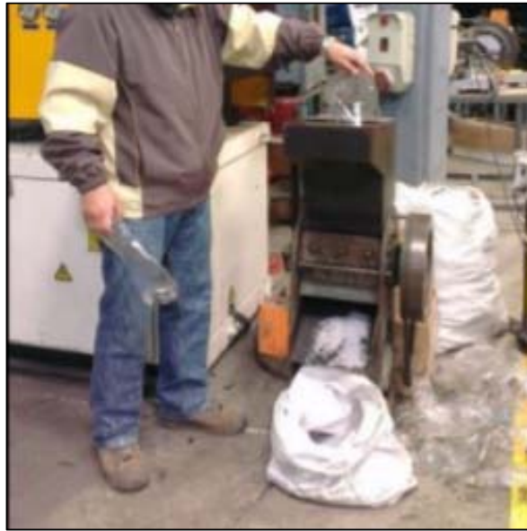
Figura 6. Trituración del material PET
