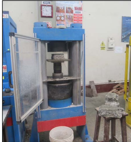
Figura 9. Ensayo a la compresión
