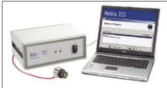
Figura 25. Equipo Thermal Conductivity Instrument, usado para los ensayos
