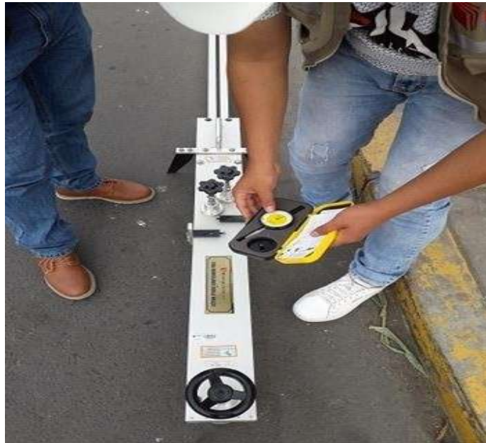
GRÁFICO N° 16: COLOCACIÓN DE DIALES CALIBRADOS
