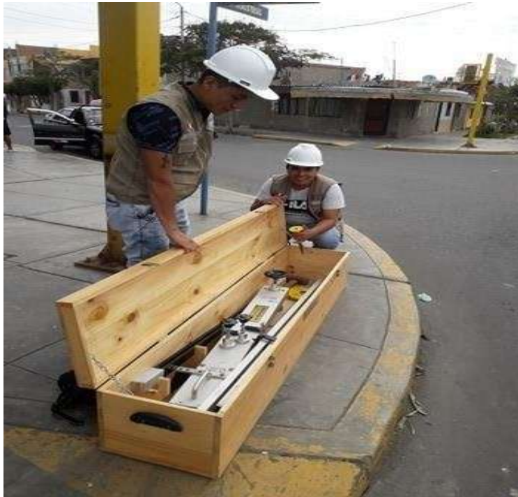
GRÁFICO N° 14: ARMADO DEL INSTRUMENTO VIGA BENKELMAN
