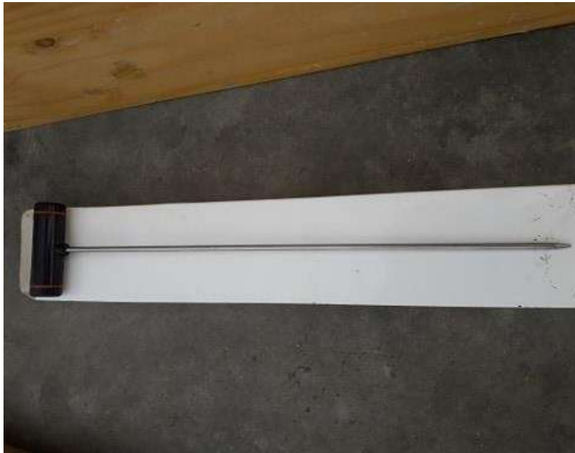
GRÁFICO N° 18: TERMÓMETRO CONVENCIONAL PRECISIÓN DE 1°C.
