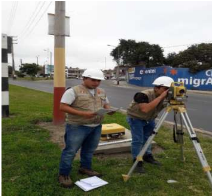
GRÁFICO N° 24: INSTALACIÓN DE ESTACIÓN TOTAL PARA HACER EL LEVANTAMIENTO TOPOGRÁFICO
