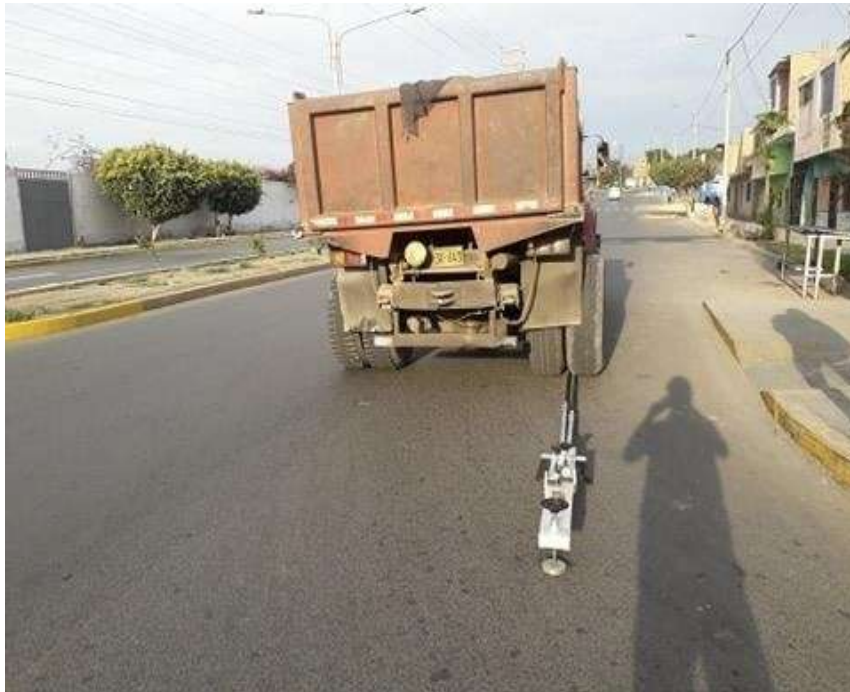
GRÁFICO N° 23: EVALUANDO LA CARGA APLICADA
