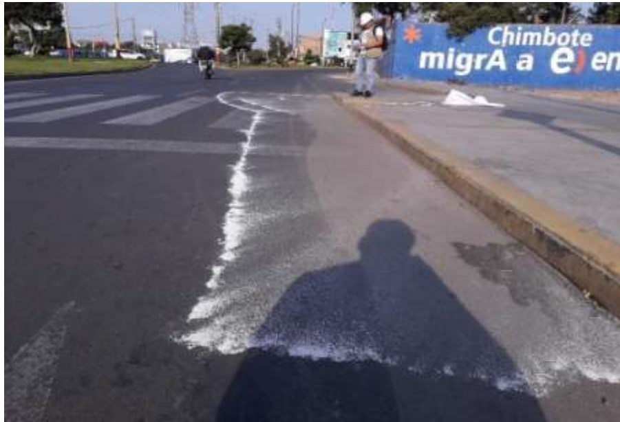
GRÁFICO N° 1: INICIO DE TOMA DE MUESTRA EXUDACIÓN
