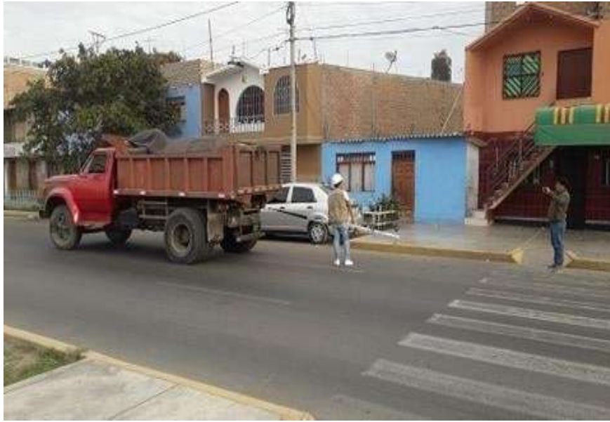
GRÁFICO N° 22: COLOCACIÓN DE LA VIGA BENKELMAN EN EL PUNTO A EVALUAR
