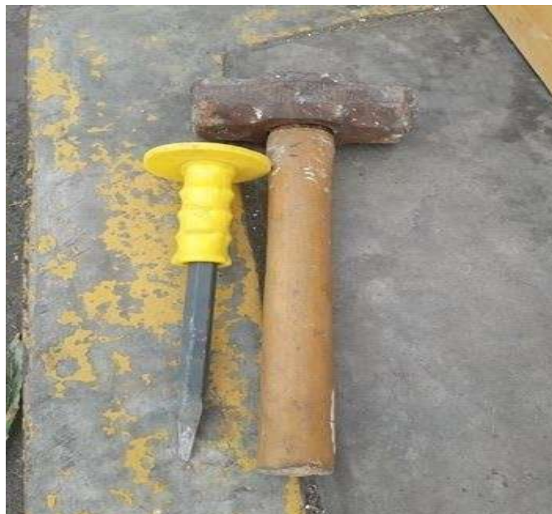
GRÁFICO N° 17: PUNTA Y COMBA, PARA LA PERFORACIÓN DE LA CAPA DE RODADURA, PARA LA TOMA DE TEMPERATURA DEL PAVIMENTO
