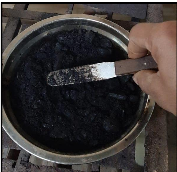
Fotografía N° 13: Mezcla asfáltica, agregado y líquido PEN, mezclados, calentado a 150°C (para la mezcla con adición de caucho 170°C) luego se deja enfriar a 30°C para recién ser añadido a los moldes y hacer el pisonado.
