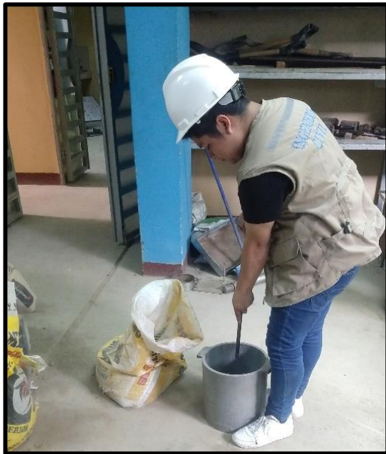
Fotografía N° 07: Ensayo para pesos unitarios del agregado grueso y agregado fino.
