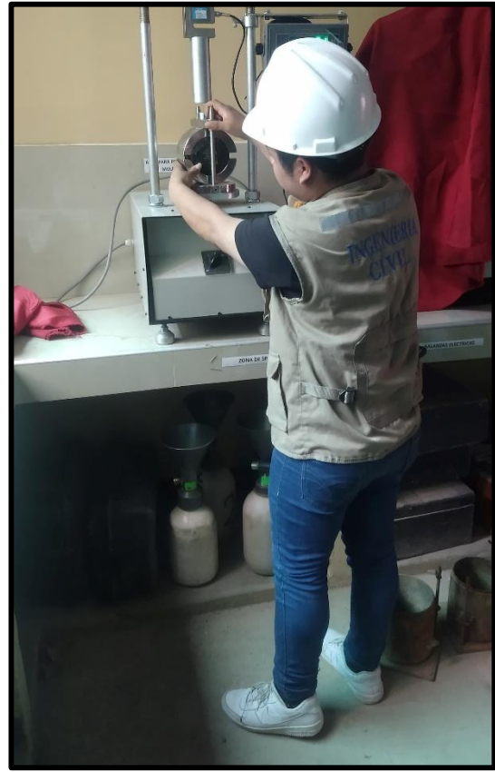
Fotografía N° 19: Colocación de las briquetas después de haber estado por 30 minutos en el baño maría, en el quipo MARSHALL, para realizar la carga, en el cual obtenemos el flujo y la estabilidad. Se realiza tanto para el diseño patrón y con la adición de las 3 proporciones de caucho reciclado.
