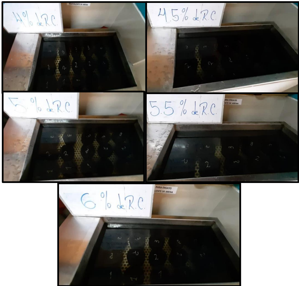
Fotografía N° 17: Tres briquetas analizadas por cada porcentaje; 4%, 4.5%, 5%, 5.5%, 6%, para el diseño patrón y con las 3 adiciones de caucho reciclado, por ello la muestra es de 60 briquetas.
