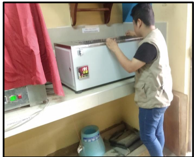
Fotografía N° 08: Baño maría temperado a 60°C para colocar las briquetas.
