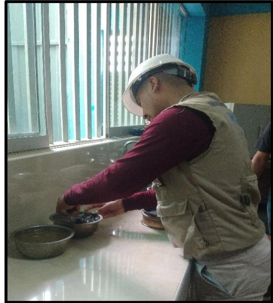
Fotografía N° 06: Saturado de muestras de agregado grueso y agregado fino, por 24 horas, luego peso específico del agregado grueso y agregado fino.
