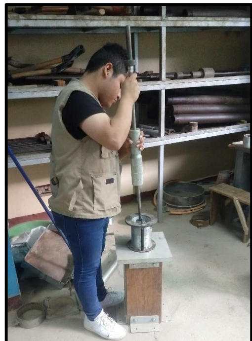
Fotografía N° 14: Se realiza el pisonado de la mezcla asfáltica, con el pistón, a 130 °C, luego de ser calentado. Se realiza lo mismo con las 3 proporciones de caucho a 160°C.
