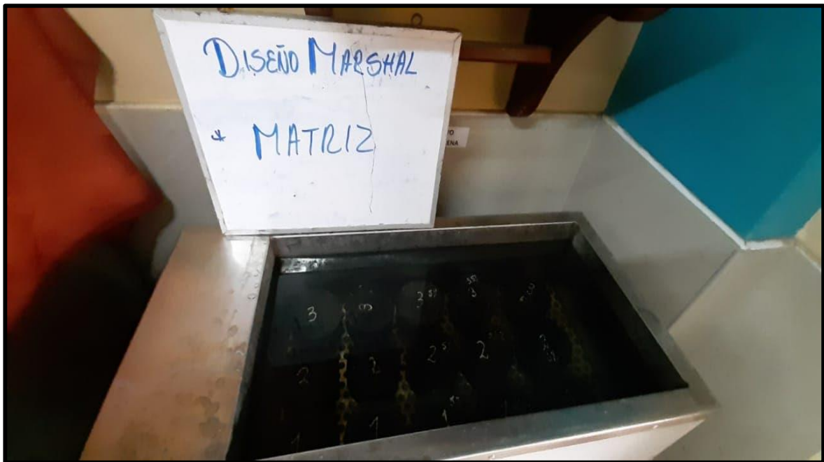
Fotografía N° 16: Luego de haber sido pisoneado, se obtienen las briquetas, en la cual son ubicadas en el baño maría a una temperatura de 60°C, por 30 minutos, tanto para el diseño matriz y con las otras 3 proporciones con la adición del acucho reciclado
