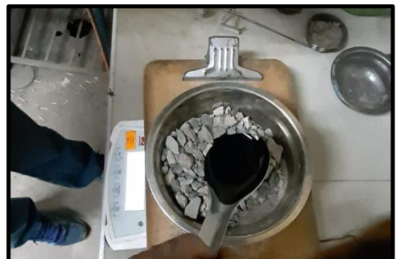
Fotografía N° 12: Añadiendo el líquido PEN, previamente calentado a
