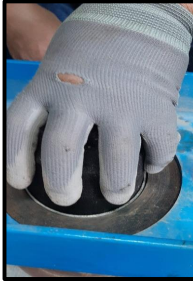
Fotografía N° 15: Extrayendo briquetas de asfalto, con el equipo llamado extractor de muestras, luego de haber sido apisonado y moldeado.
