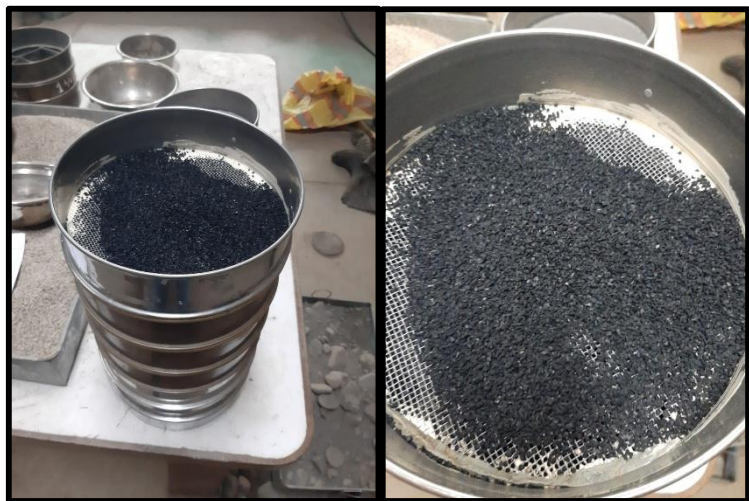
Fotografía N° 18: Granulometría del caucho reciclado en el laboratorio GEOMG S.A.C.
