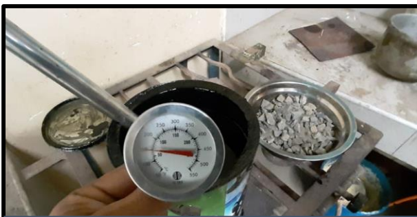
Fotografía N° 11: Líquido PEN, calentado a 150°
