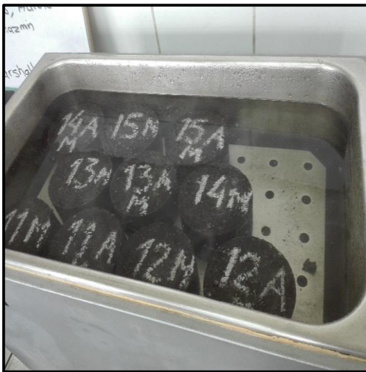
Figura 39: Briquetas Marshall dentro del baño maría
