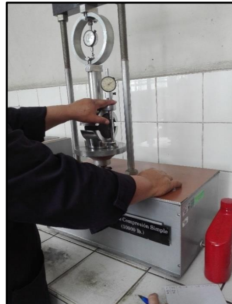
Figura 40: Rotura de las Briquetas
