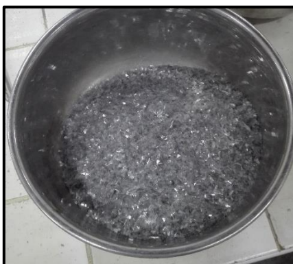
Figura 10 : Tereftalato de polietileno en forma de micas trituradas
