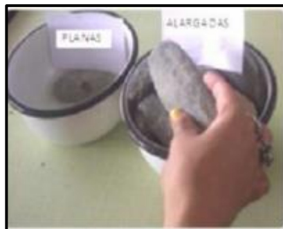
Figura 18: Verificación de la geometría de los agregados
