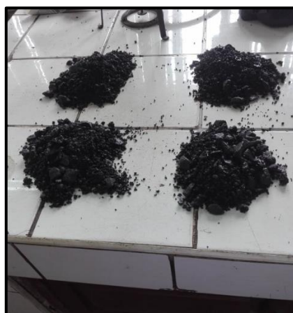
Figura 6: Mezcla asfáltica sin compactar
