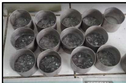
Figura 9: Dosificaciones de PET en micas para ser utilizadas en el asfalto
