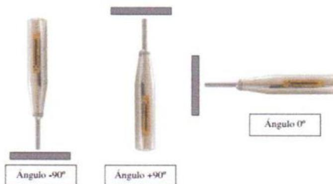
**Posición y ángulo de impacto del Esclerómetro**
