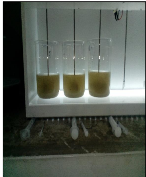
Aplicación de los coagulantes a la muestra del agua del rio Huaycoloro
