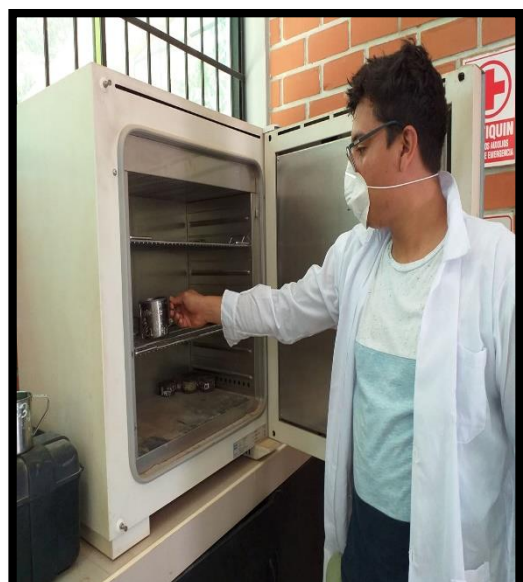
Fig. N °03 y N°04: se observa a los tesistas colocando el material en el horno para luego de 24 horas pesar el material y obtener la humedad de los agregados
