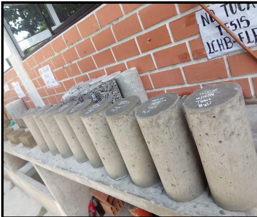
Fig. N °15: Se puede observar los especímenes de concreto desencofrado.
