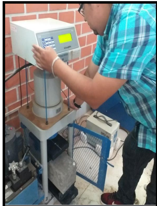
Fig. N °29 y N °30: Se puede apreciar la colocación del espécimen en la máquina para el ensayo de flexión.
