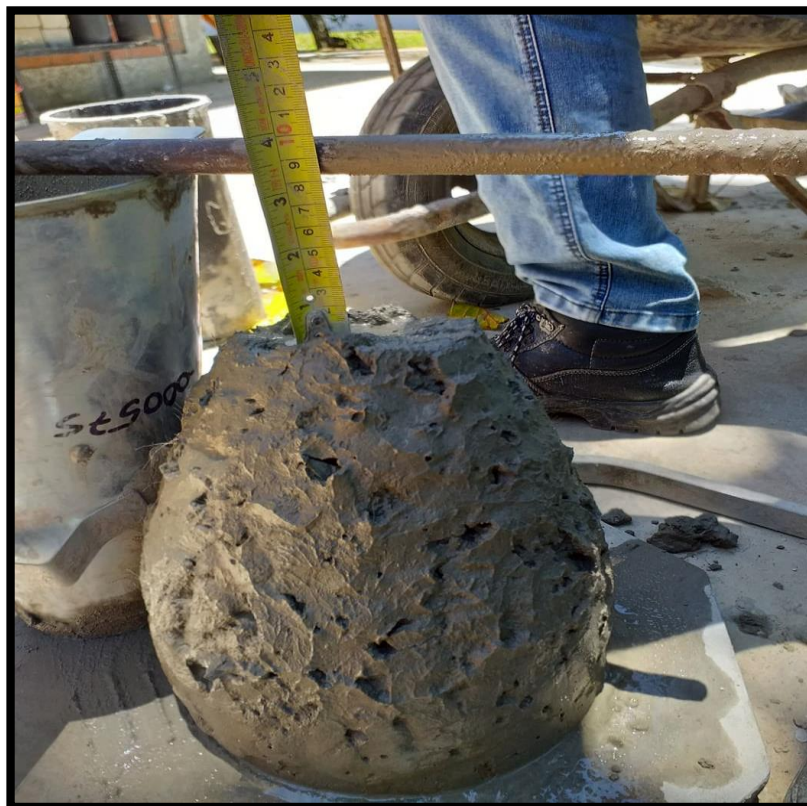
Fig. N °13: Se puede observar el asentamiento obtenido del concreto patrón de 3.5”.
