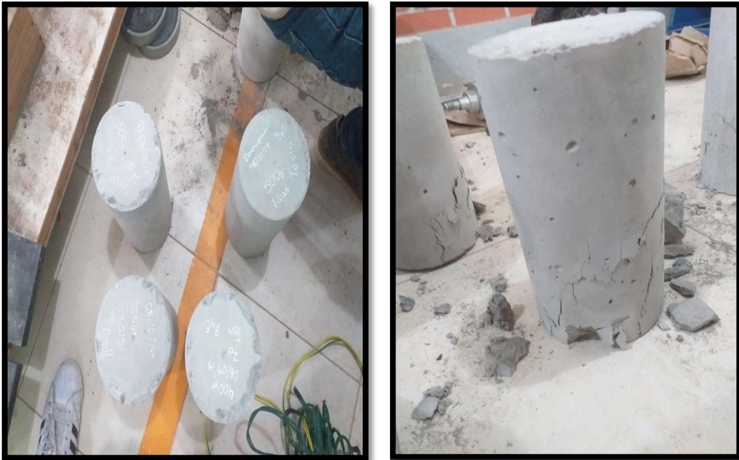
Fig. N °23 y N °24: Se puede observar a los especímenes del concreto reforzado con fibras después de realizado el ensayo a la compresión a los 28 días.
