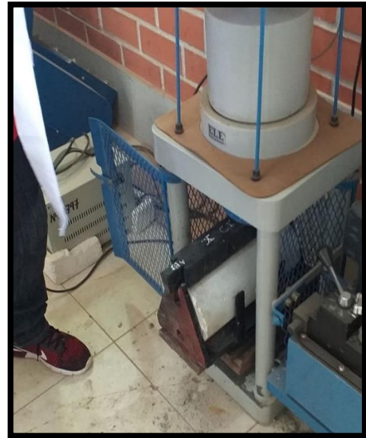
Fig. N°35 y N°36: Se puede apreciar la colocación de las probetas en la máquina para el ensayo de la tracción. Estas probetas tienen un diámetro de 6'' y una longitud de 12''
