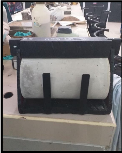
Fig. N°35 y N°36: Se puede apreciar la colocación de las probetas en la máquina para el ensayo de la tracción. Estas probetas tienen un diámetro de 6'' y una longitud de 12''
