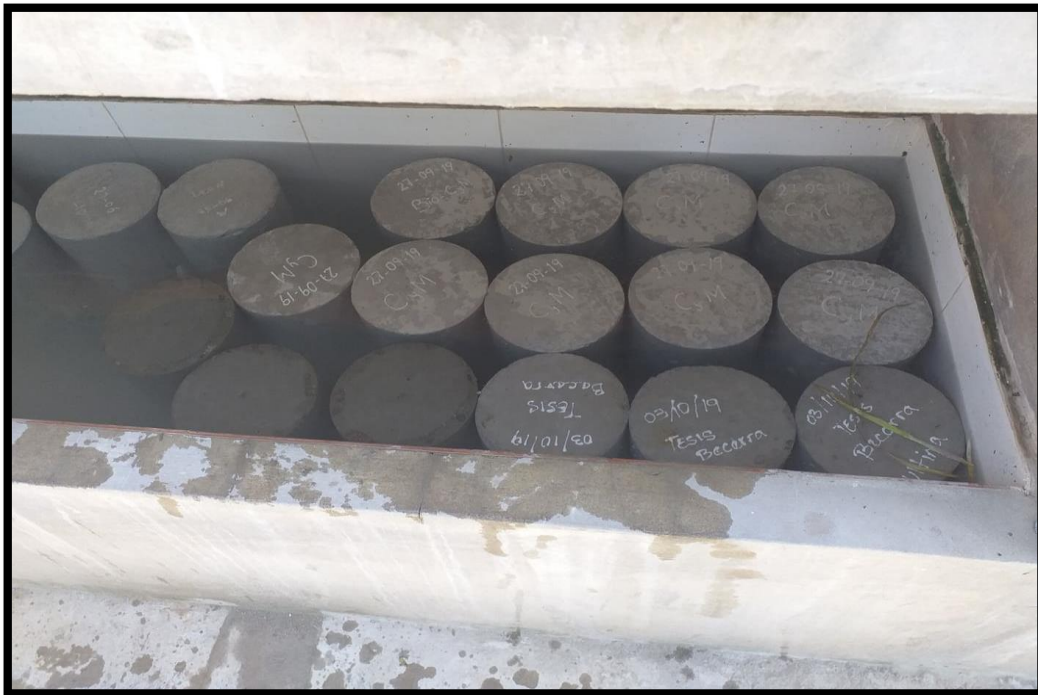
Fig. N °16: Se puede observar los especímenes de concreto en las pozas de curado.
