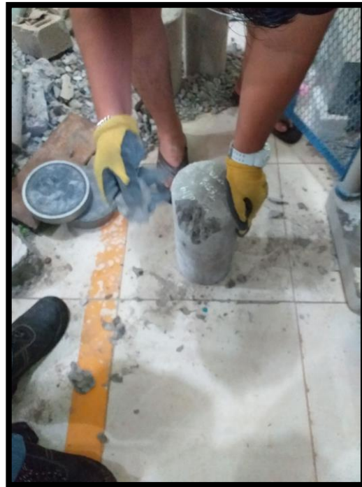
Fig. N °17 y N° 18: Se puede observar a los especímenes del concreto patrón momentos antes y después de realizado el ensayo a la compresión a los 7 días.
