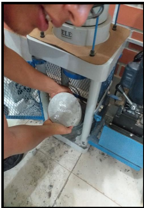
Fig. N °17 y N° 18: Se puede observar a los especímenes del concreto patrón momentos antes y después de realizado el ensayo a la compresión a los 7 días.
