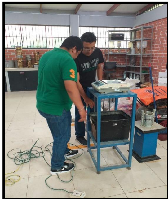
Fig. N °07 y N°08: En la primera imagen se puede observar al agregado fino colocado en la fiola para realizar el ensayo de peso específico, y en la siguiente se observa al tesista realizando el ensayo de peso unitario al agregado grueso.
