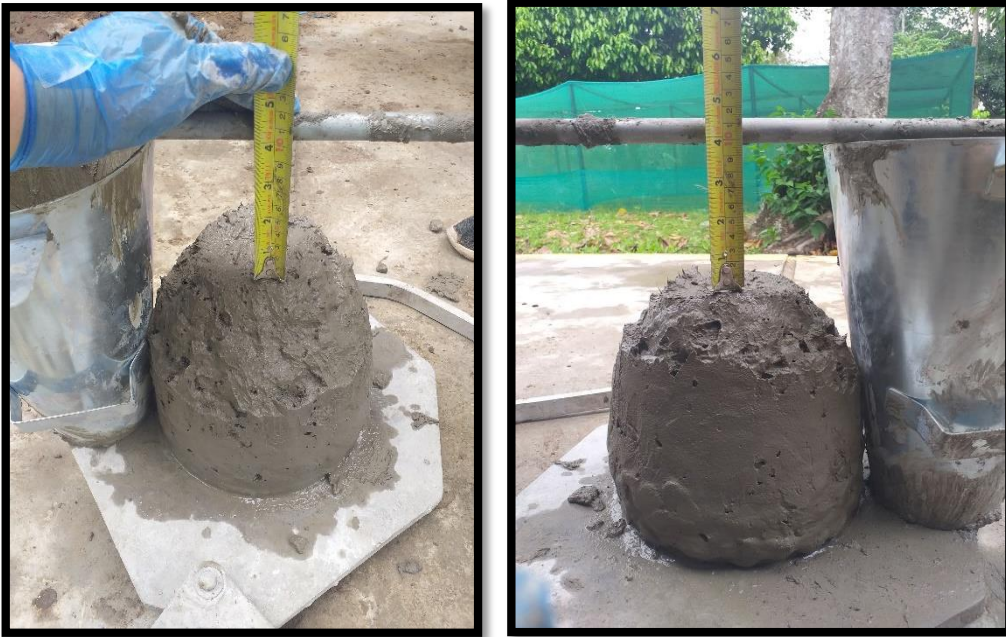
Fig. N °11: Se puede observar el asentamiento obtenido del concreto patrón de 4”.
