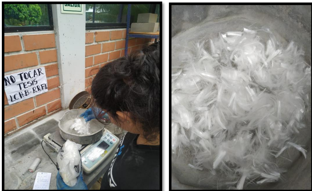
Fig. N °12: Se puede observar el pesaje de la fibra realizada por la tesista para luego ser adicionada al concreto.
