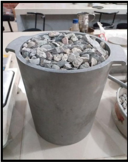
Fig. N °05 y N°06: se observa a los agregados ya colocados en los moldes para ser pesados y obtener el peso unitario correspondiente a cada uno.
