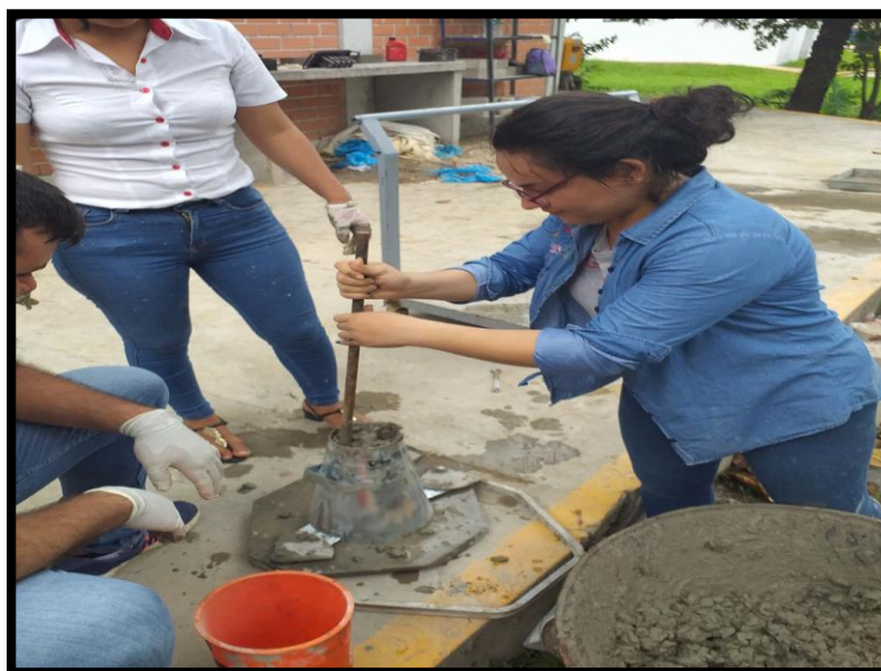
Fig. N °10: Se puede observar la realización del ensayo del asentamiento, con la supervisión de la encargada del laboratorio.
