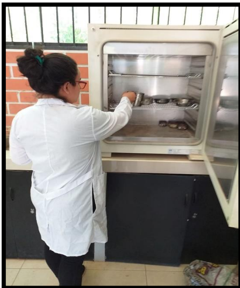
Fig. N °03 y N°04: se observa a los tesistas colocando el material en el horno para luego de 24 horas pesar el material y obtener la humedad de los agregados
