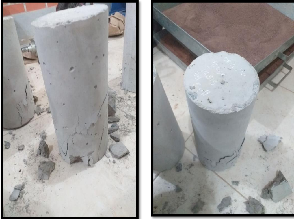
Fig. N °19 y N° 20: Se puede observar a los especímenes del concreto patrón después de realizado el ensayo a la compresión a los 28 días.
