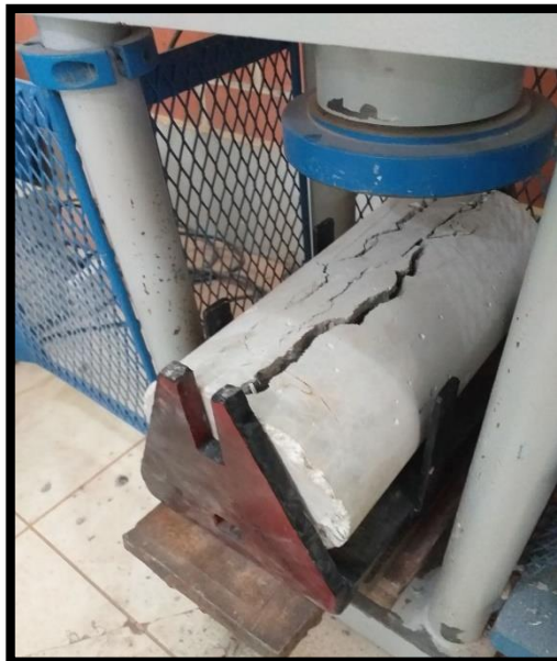
Fig. N°37 y N°38: En la imagen se puede apreciar la falla de las probetas, las cuales se dieron a través del eje longitudinal.
