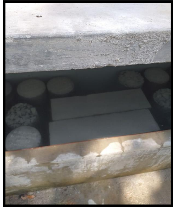
Fig. N °27 y N °28: Se puede observar el desencofrado de las vigas y colocación en las pozas de curado para su posterior prueba a la flexión.
