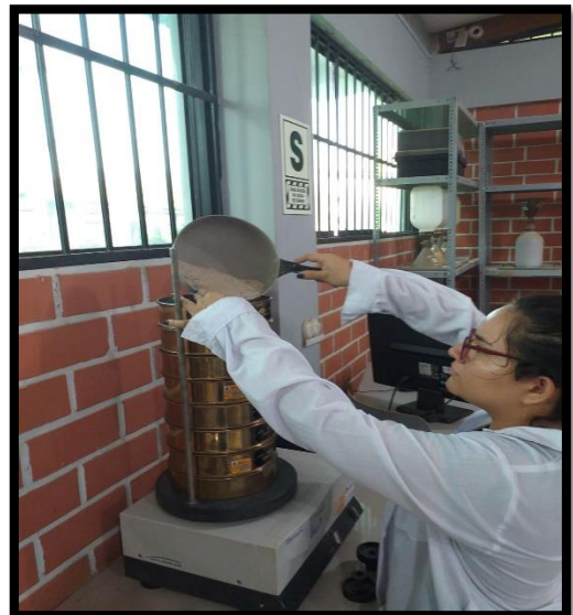
Fig. N °01 y N°02: se observa a los tesistas colocando el material en los tamices que están ubicados en la prensa para realizar el análisis granulométrico.
