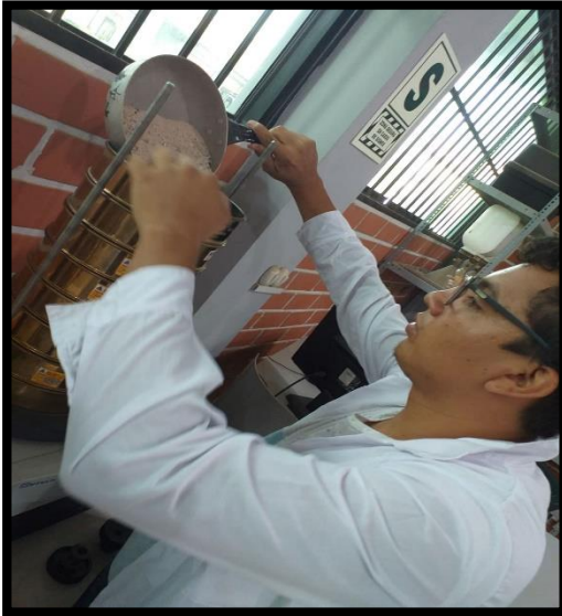
Fig. N °01 y N°02: se observa a los tesistas colocando el material en los tamices que están ubicados en la prensa para realizar el análisis granulométrico.
