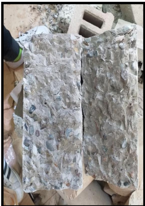
Fig. N°39 y N°40: En la imagen se puede apreciar la falla de las probetas, las cuales se dieron a través del eje longitudinal.
