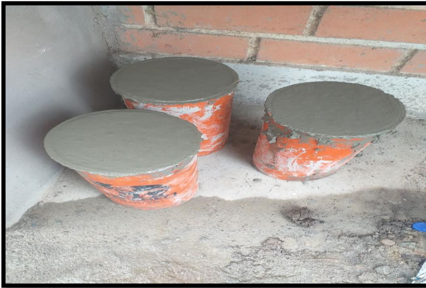
Fig. N °14: Se puede observar los especímenes del concreto patrón en los moldes.
