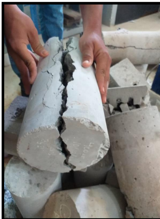
Fig. N°39 y N°40: En la imagen se puede apreciar la falla de las probetas, las cuales se dieron a través del eje longitudinal.
