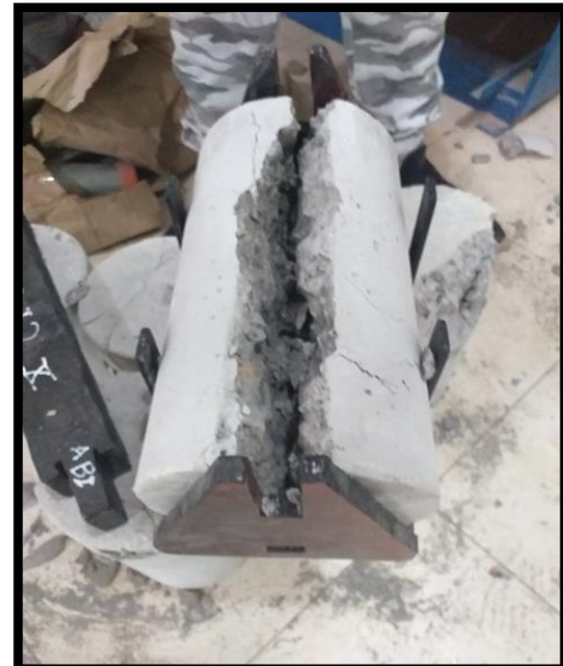
Fig. N°37 y N°38: En la imagen se puede apreciar la falla de las probetas, las cuales se dieron a través del eje longitudinal.
