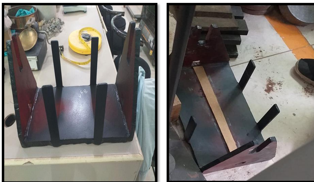
Fig. N °33 y N °34 Se observa la máquina que será empleada para el ensayo de tracción en el concreto.
