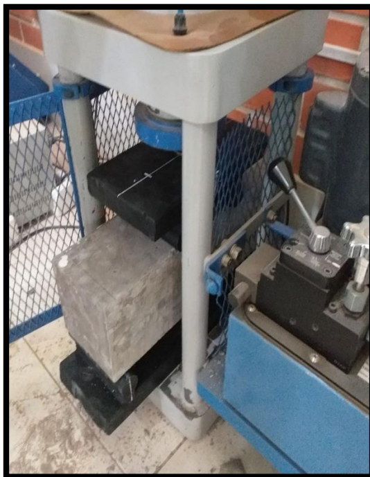
Fig. N °29 y N °30: Se puede apreciar la colocación del espécimen en la máquina para el ensayo de flexión.
