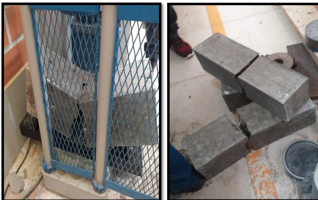
Fig. N °31 y N °32: Se logra visualizar que los especímenes de concreto patrón y los especímenes con adición de fibra fallaron dentro del tercio central del tramo de Luz.
