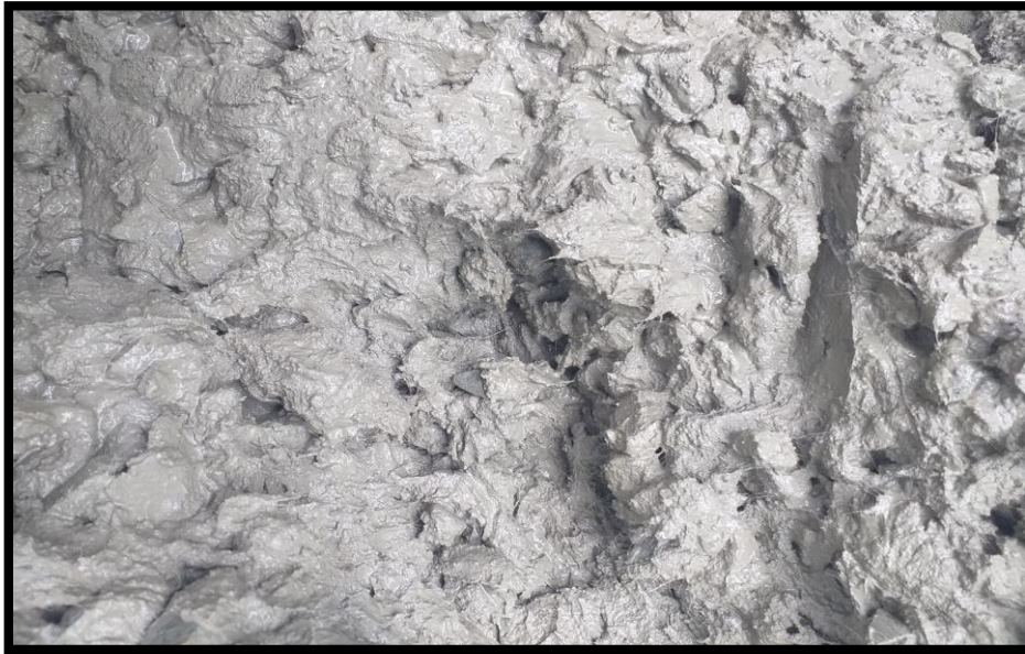
Fig. N °13: Se puede observar el concreto ya mezclado con las fibras de polipropileno.
