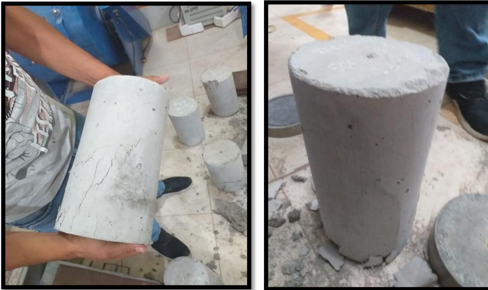
Fig. N °21 y N ° 22: Se puede observar a los especímenes del concreto reforzado con fibras después de realizado el ensayo a la compresión a los 7 días.
