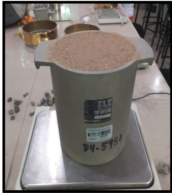
Fig. N °05 y N°06: se observa a los agregados ya colocados en los moldes para ser pesados y obtener el peso unitario correspondiente a cada uno.
