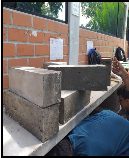
Fig. N °27 y N °28: Se puede observar el desencofrado de las vigas y colocación en las pozas de curado para su posterior prueba a la flexión.
