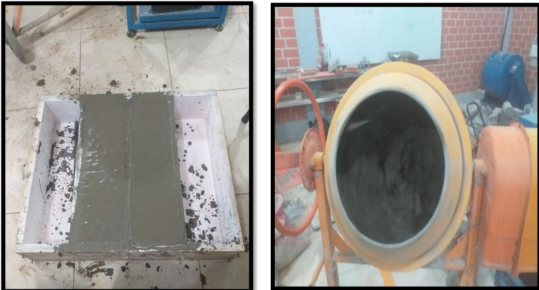
Fig. N °25 y N °26: Se puede observar la elaboración de los especímenes de concreto patrón y especímenes con adición de fibra para realizar el ensayo a flexión después del curado.
