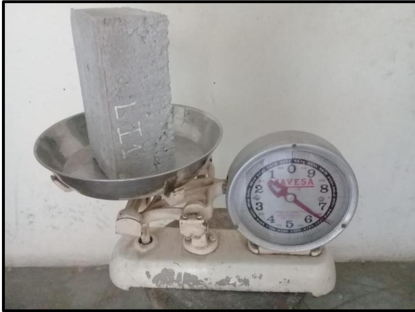
Figura 70. Ensayo de peso de los ladrillos de concreto con 0% fibra de PET
