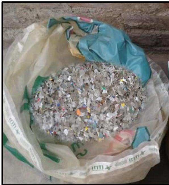
Figura 39. Fibra de PET reciclado obtenido de la recicladora MANUELITA S.A.C.
