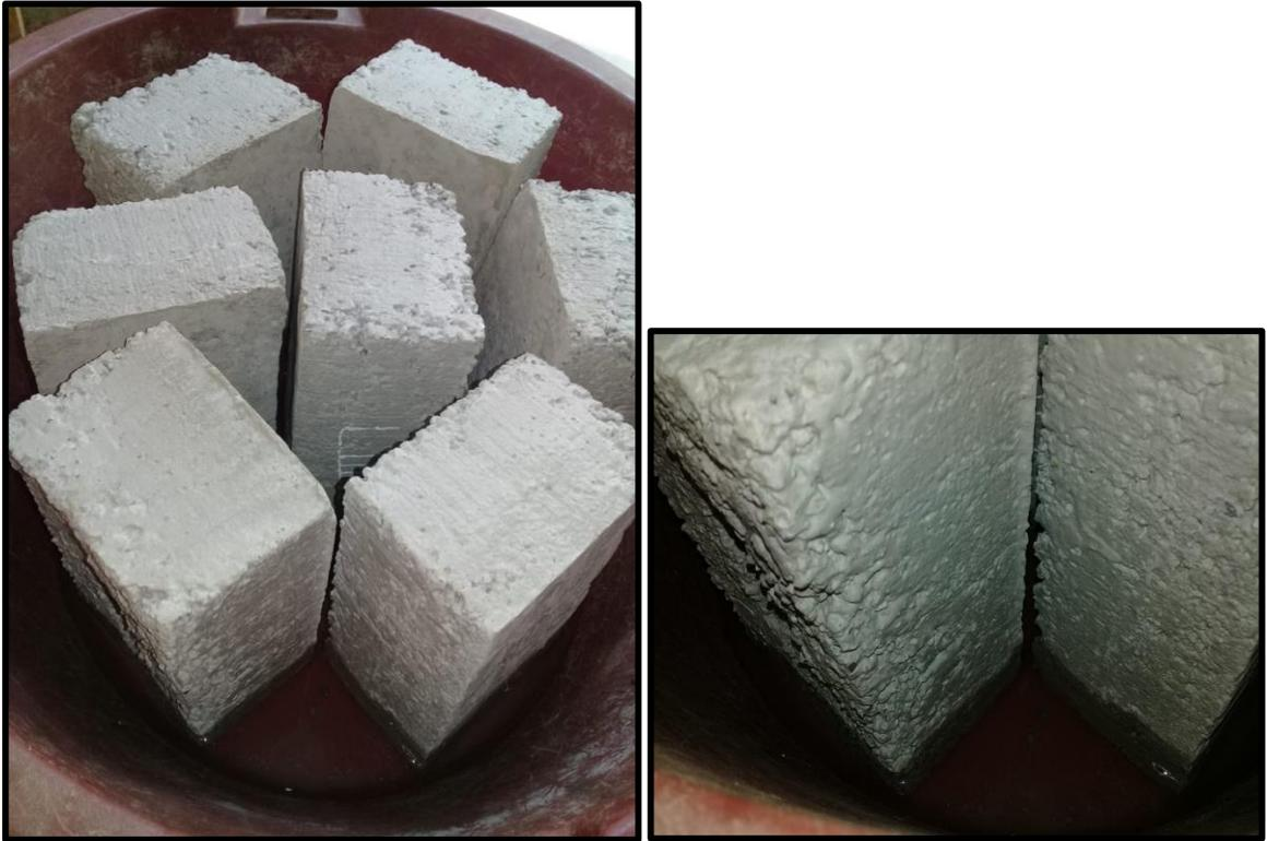
Figura 74. Ladrillos de concreto con fibra de PET colocados en agua destilada para el ensayo de Eflorescencia.
