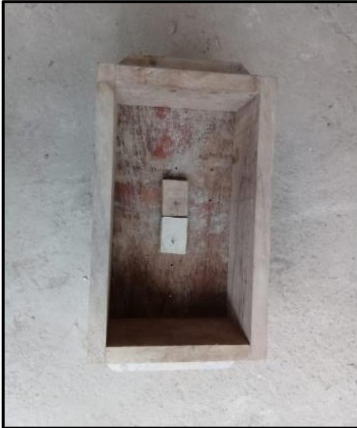
Figura 42. Molde para la Elaboración del ladrillo de Concreto
