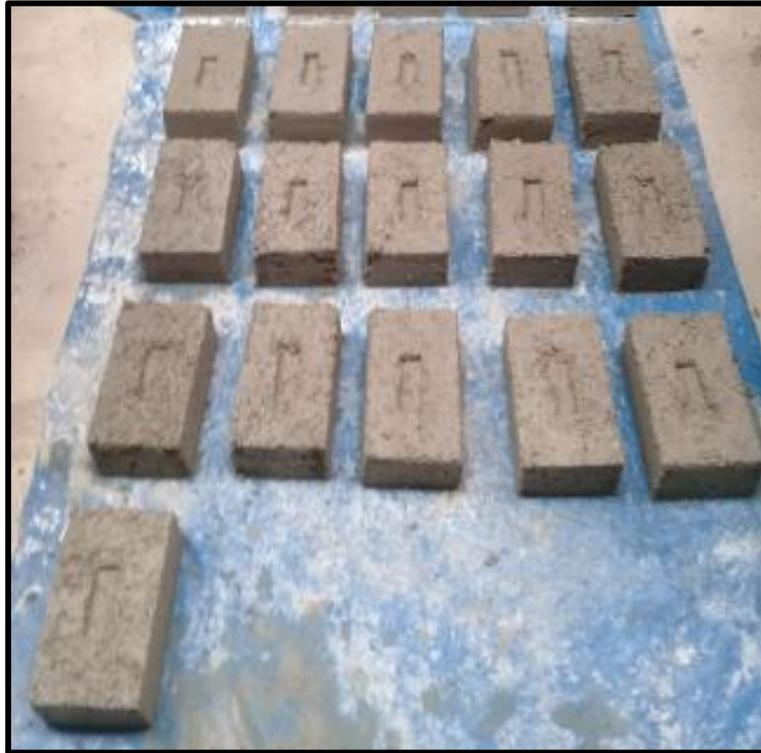
Figura 54. Ladrillos Elaborados con 10% de Fibra de Plástico reciclado PET
