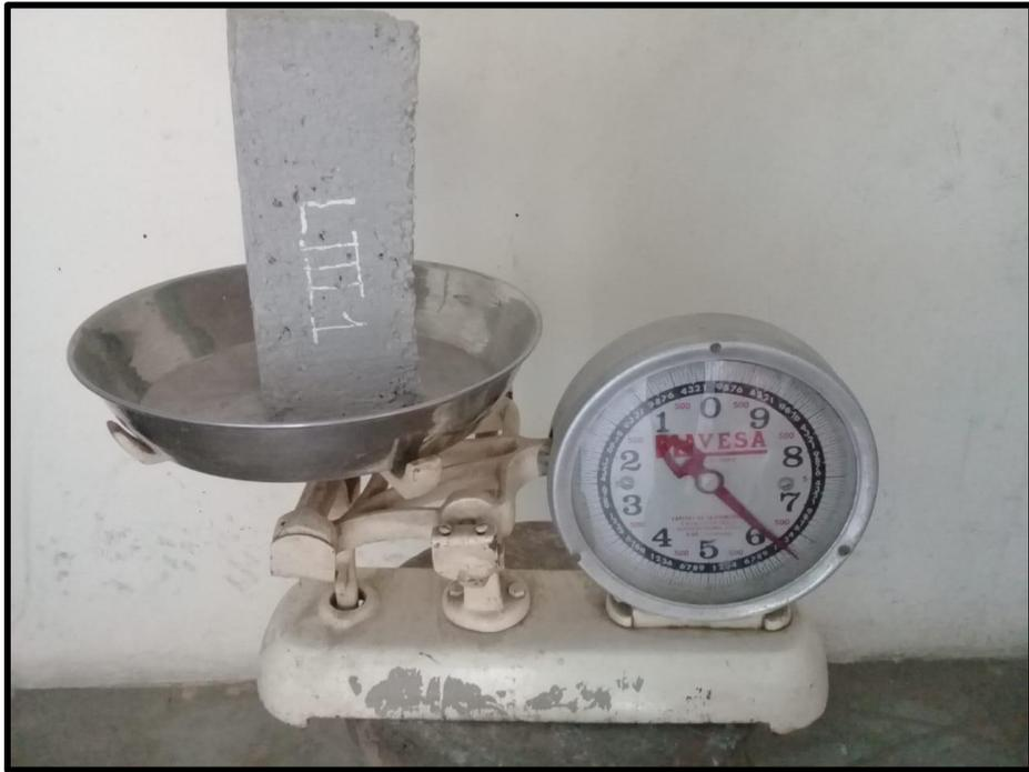
Figura 72. Ensayo de peso de los ladrillos de concreto con 10% fibra de PET
