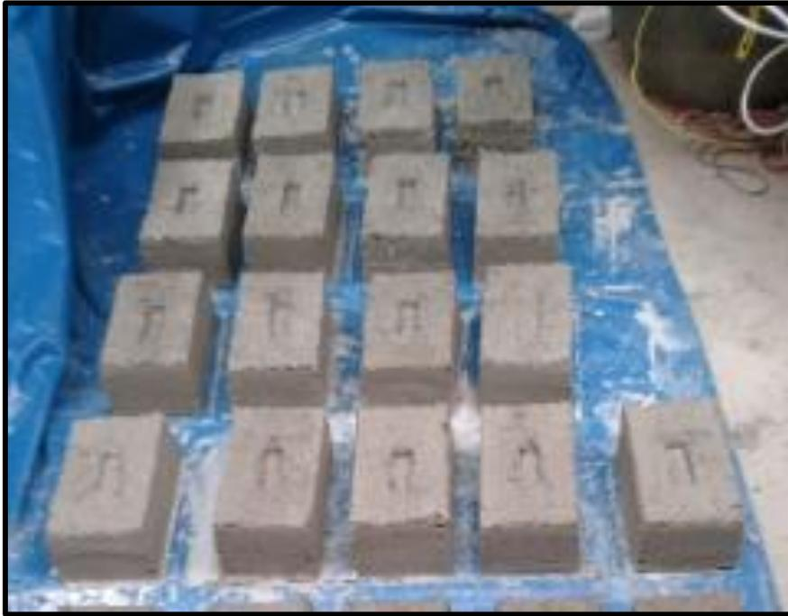
Figura 52. Ladrillos Elaborados con 0% de Fibra de Plástico reciclado PET
