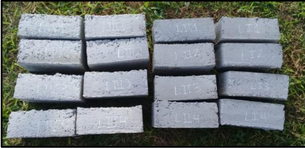
Figura 56. Codificación de ladrillos con 0%, 5%, 10% y 15% de fibra de PET para ensayo a compresión.
