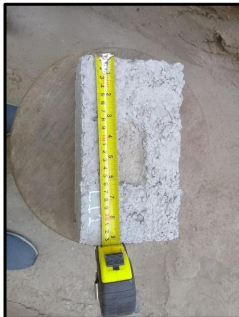
Figura 67. Medición del largo del ladrillo de concreto para el ensayo de variabilidad dimensional.
