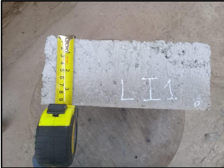
Figura 68. Medición del alto del ladrillo de concreto para el ensayo de variabilidad dimensional.
