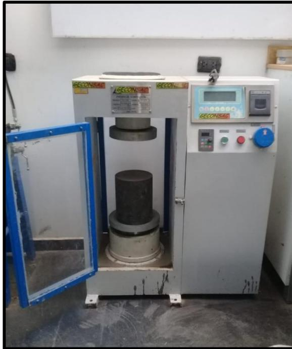
Figura 60. Prensa de compresión donde se realizó el ensayo a los ladrillos de concreto con fibra de PET.
