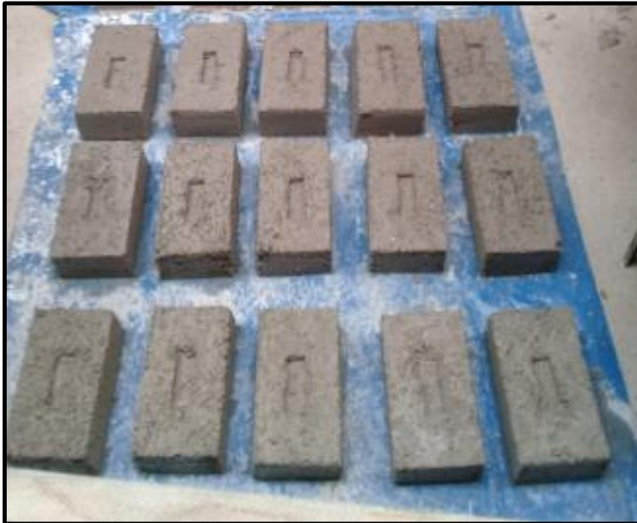
Figura 53. Ladrillos Elaborados con 5% de Fibra de Plástico reciclado PET
