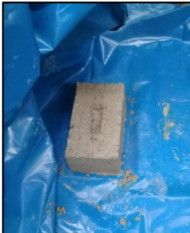
Figura 51. Acabado Final del ladrillo de concreto
