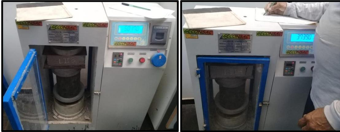
Figura 62. Ladrillos de concreto con Fibra de PET reciclada sometidos a fuerza de compresión.
