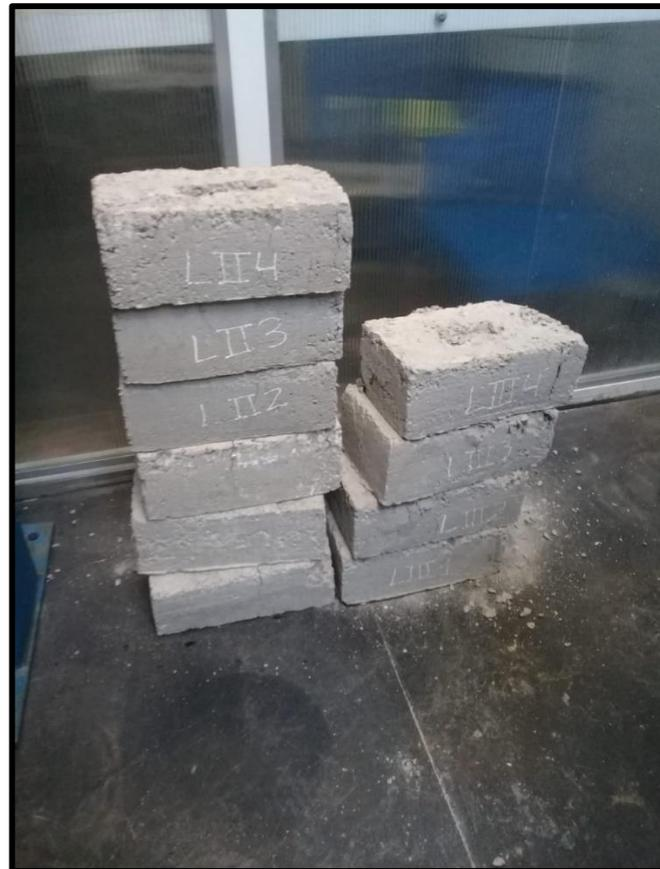
Figura 63. Ladrillos de concreto con Fibra de PET después del ensayo de compresión
