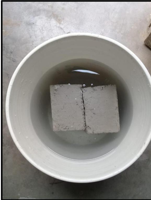
Figura 64. Ladrillos sumergidos en agua para el ensayo de absorción
