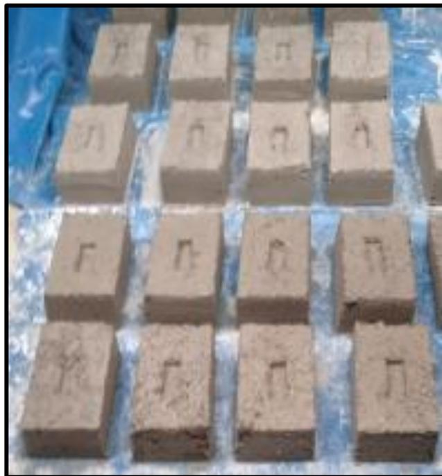
Figura 55. Ladrillos Elaborados con 15% de Fibra de Plástico reciclado PET
