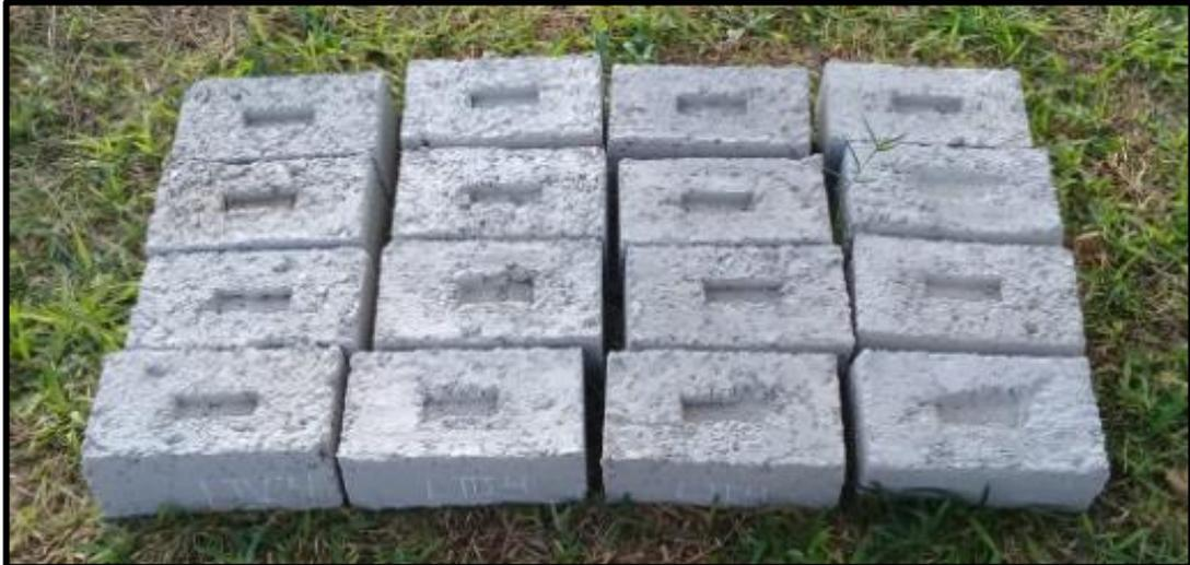
Figura 57. Codificación de ladrillos con 0%, 5%, 10% y 15% de fibra de PET para ensayo de absorción.
