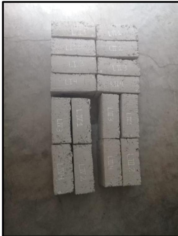
Figura 59. Codificación de ladrillos con 0%, 5%, 10% y 15% de fibra de PET para ensayo complementario de Eflorescencia.
