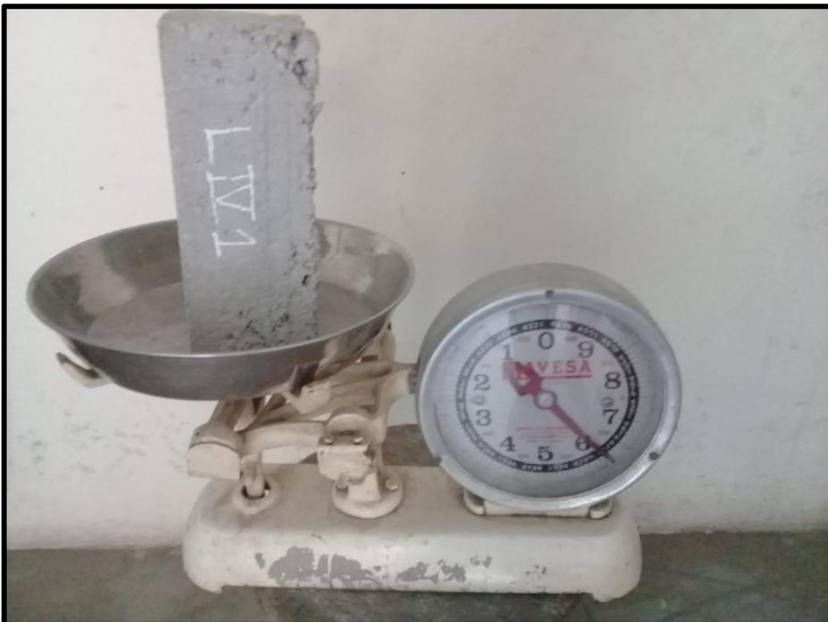
Figura 73. Ensayo de peso de los ladrillos de concreto con 15% fibra de PET
