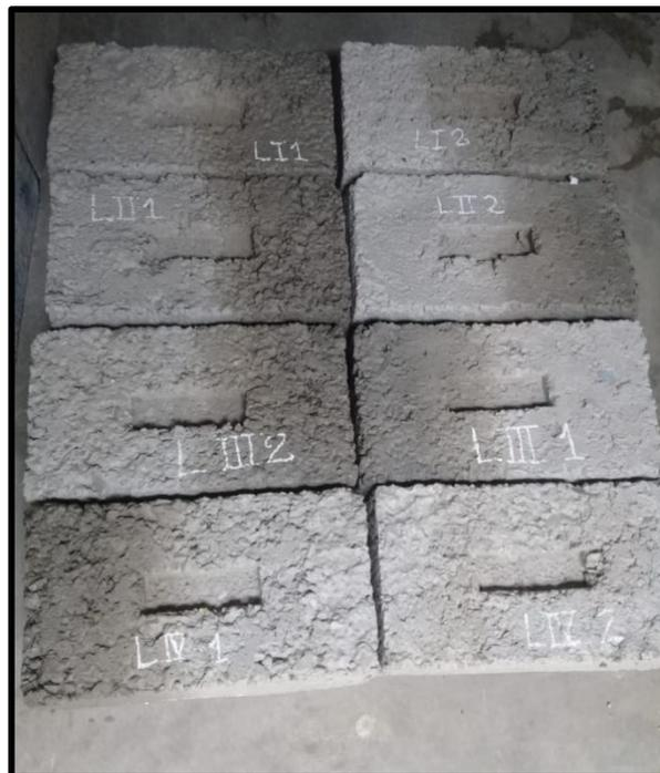
Figura 75. Eflorescencia presentada en los ladrillos de concreto con 0%, 5%, 10% y 15% fibra de PET.
