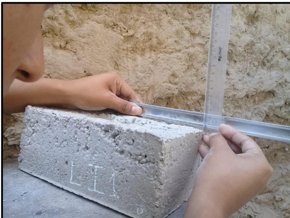
Figura 69. Medición de concavidad y convexidad del ladrillo de concreto para el ensayo de Alabeo.
