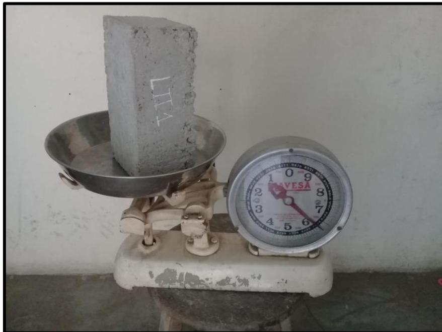
Figura 71. Ensayo de peso de los ladrillos de concreto con 5% fibra de PET
