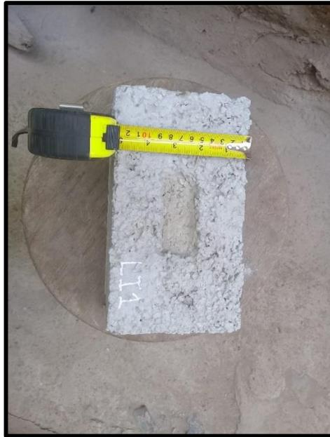
Figura 66. Medición del ancho del ladrillo de concreto para el ensayo de variabilidad dimensional.
