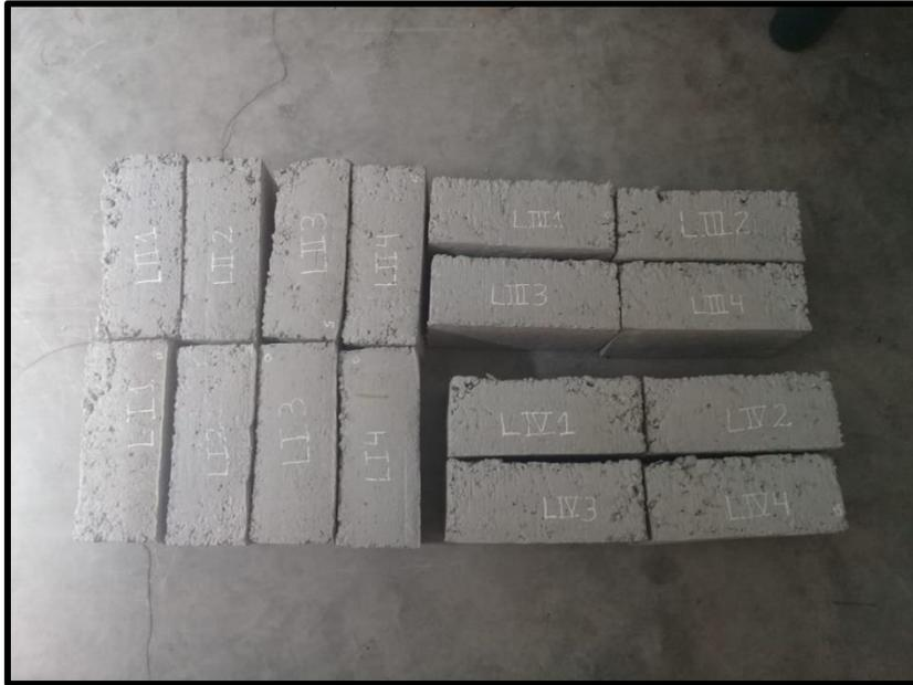
Figura 58. Codificación de ladrillos con 0%, 5%, 10% y 15% de fibra de PET para ensayo complementarios ( Variación dimensional, Alabeo y peso)
