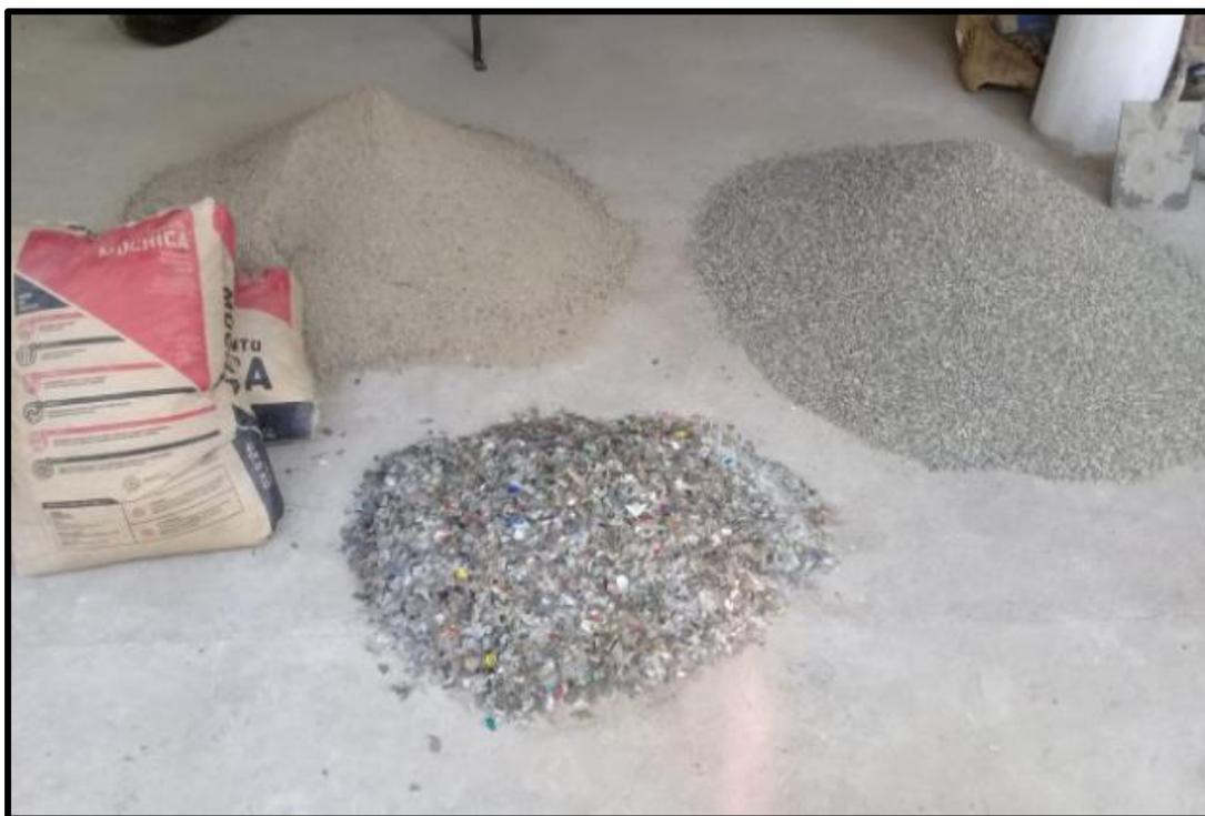
Figura 40. Materiales usados para la mezcla del bloque de concreto.
